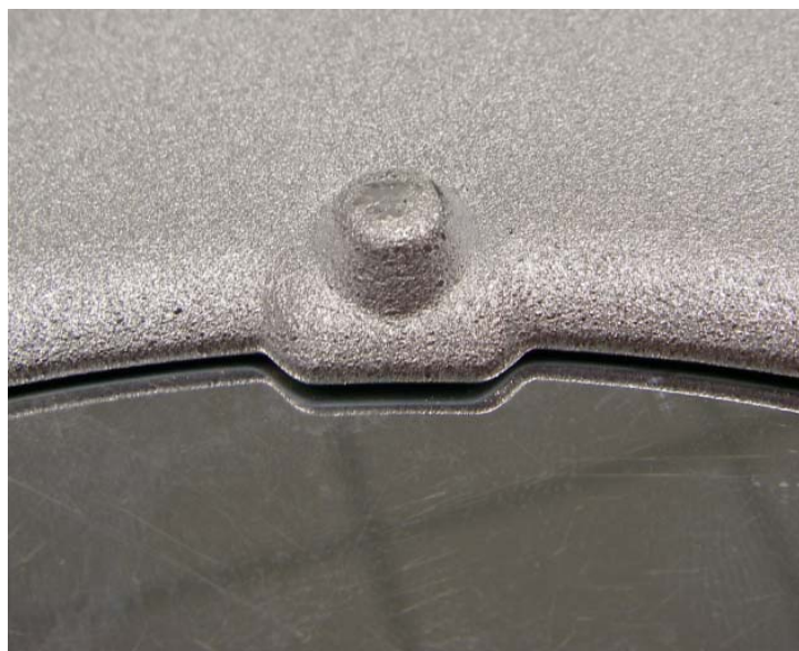
圖 2-10 加熱板升起夾鉗固定晶圓
