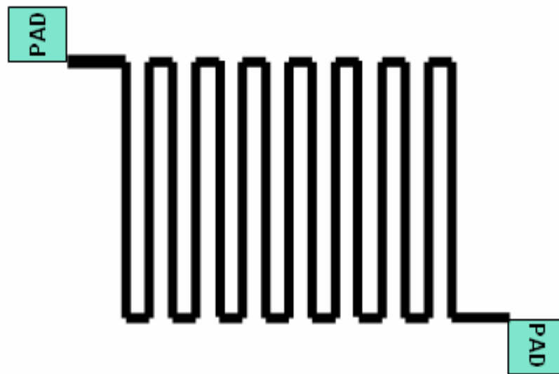
圖 3-17 WAT 金屬導線開路測試電路(蛇型)
