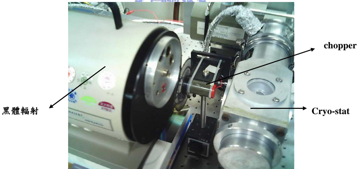
圖 4-6 光電流量測之實際儀器架設圖
