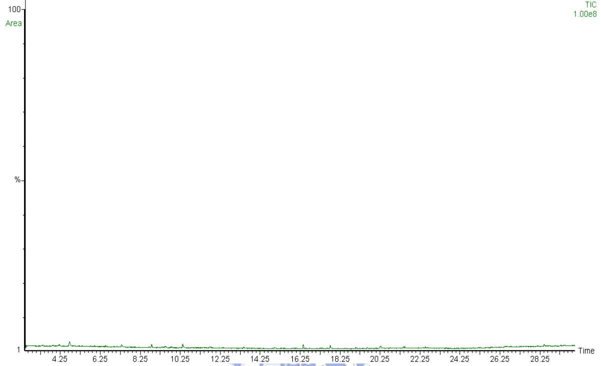
圖 4.19、潔淨室內使用密封材(PTFE)之釋氣層析圖譜
