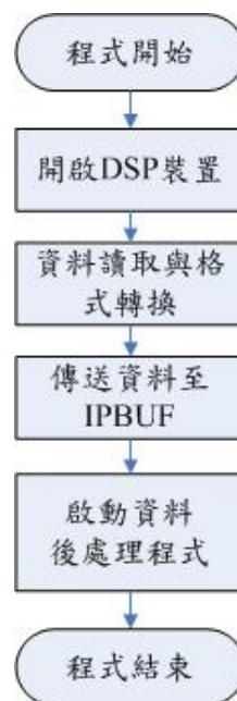
圖4.12、DSP程式啟動流程
