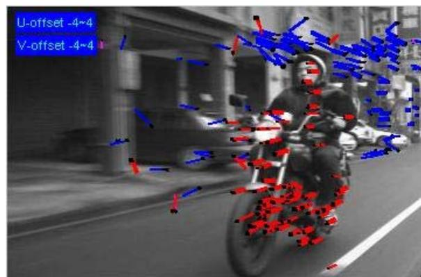
圖 2-9 混合式光流估測法之結果
