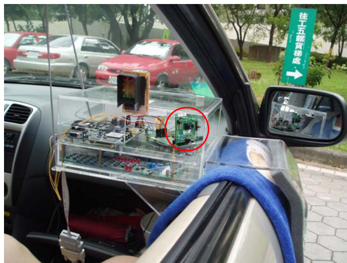
圖 4-43 影像運動偵測系統置於實車內的情況
