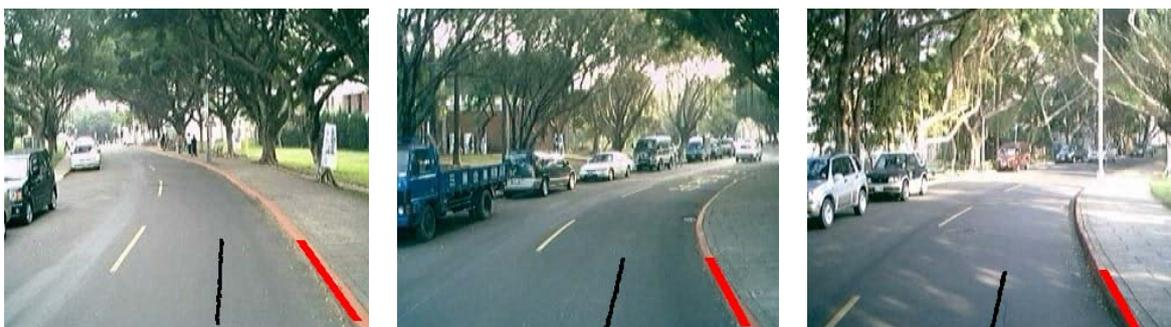
圖 3.6 彎道上利用右車道線找出的車道中心線
