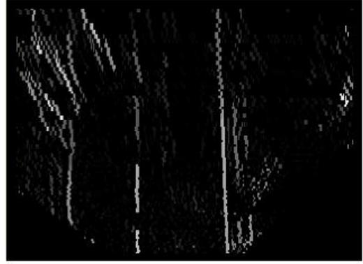
圖 2.5 利用灰階特徵所擷取出的車道線 圖 2.6 利用 GMD 加強車道線影像
