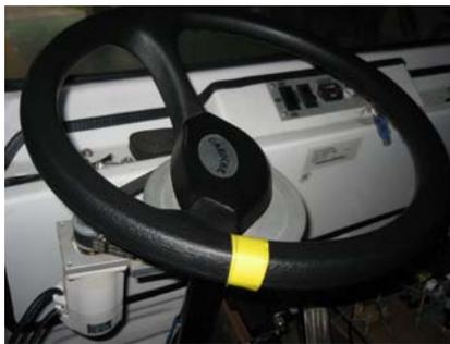
圖 4.9 馬達透過皮帶連結方向盤
