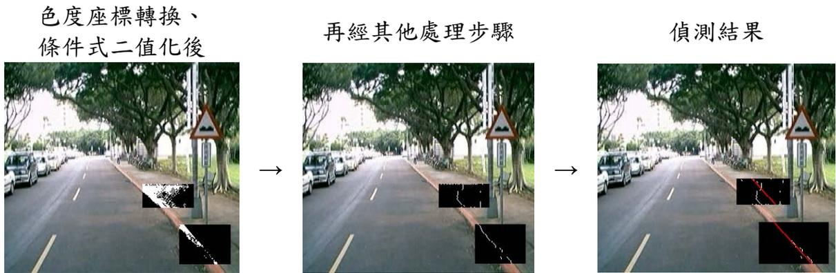
圖 4.30 彎道車道線受到陽光影響偵測結果
