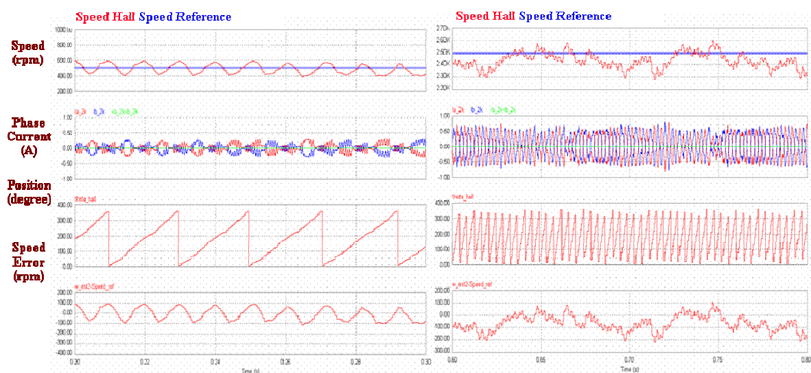
圖3.16 分別模擬單相電流調節技術於速度命令500及2500 rpm的速度控制
