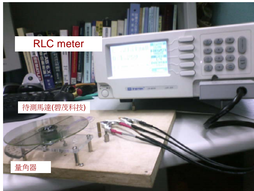
圖5.23 量測馬達電感及電阻平台
