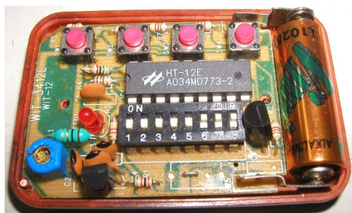
圖 2-12 利用二態碼的 HT-12E 組成的遙控器
