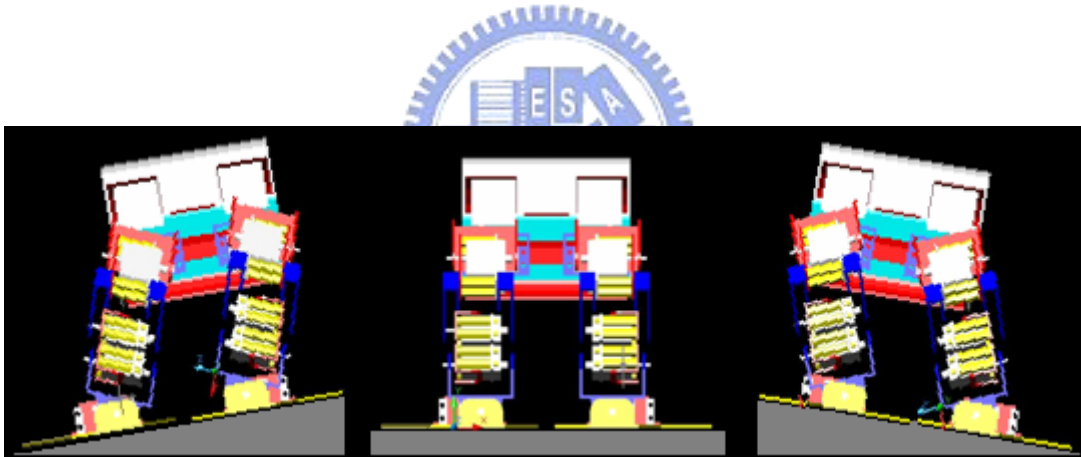
圖 3-21：雙足機器人 PAPA-Man 於地面左傾、右傾時之模擬平衡 3D 圖
