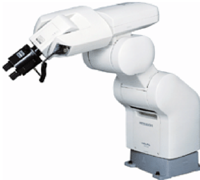
圖 3-7 Mitsubishi RV-2A 五軸機械手臂外觀
