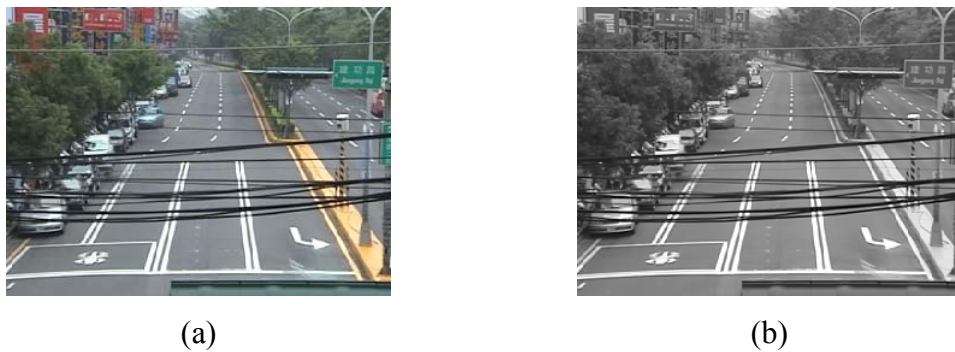
圖 3.12 彩色影像轉成灰階影像的例子。(a) 彩色影像；(b) 轉換後的灰階影像。
