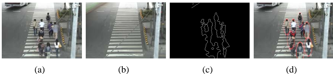
圖 1.1 利用前景邊界配合透視轉換偵測行人的例子。(a) 輸入影像；(b) 背景；(c) 前景邊界；(d) 偵測出的行人。
