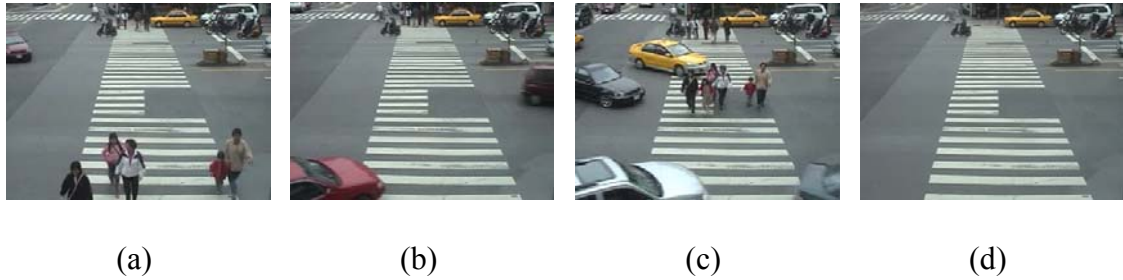
圖 3.5 建立背景影像的圖例。(a)至(c) 用來建立背景影像的部份影像序列；(d) 建立的背景影像。
