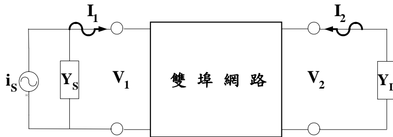
圖 5.2-3 4 階交錯耦合低通濾波器之雙埠網路
