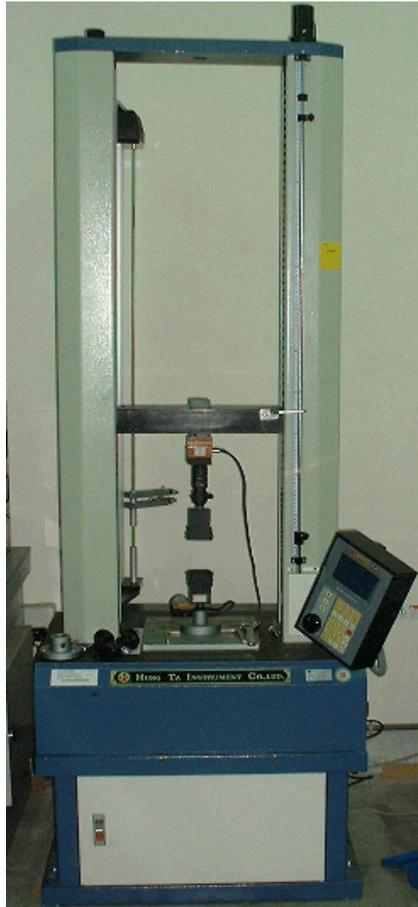
圖 4.12 電腦伺服控制材料試驗機
