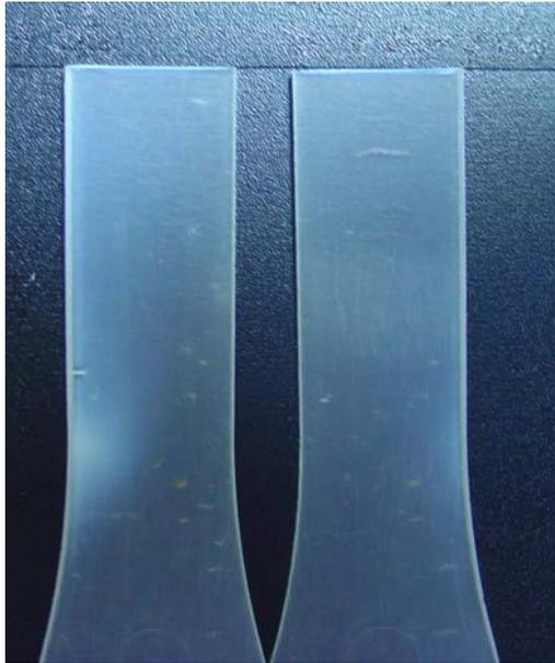
圖 6.19 (a)有結合線之拉伸斷面
