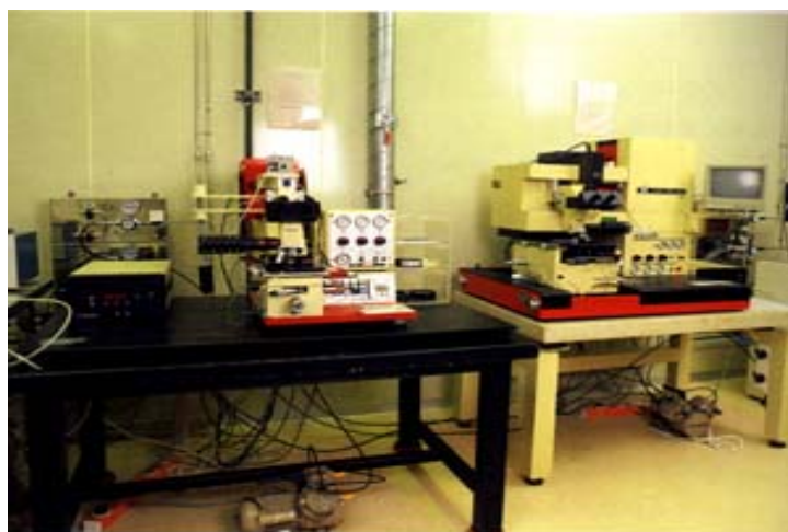
圖 3-6 光罩對準曝光機
