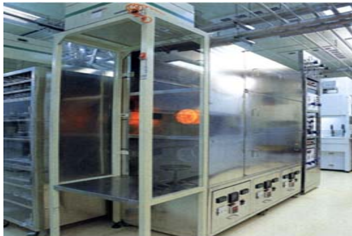
圖 3-2 氧化擴散系統
