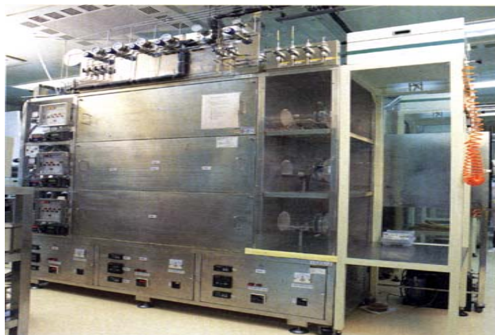
圖 3-3 低壓化學氣相沉積系統
