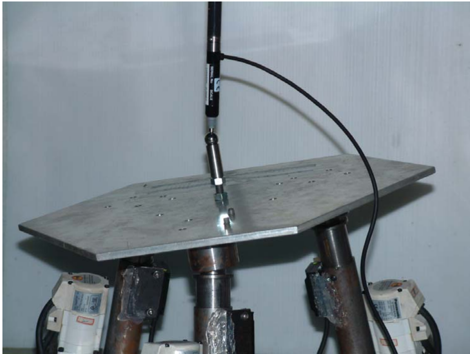
圖 4.4 Ballbar 實際架設示意圖(近照)
