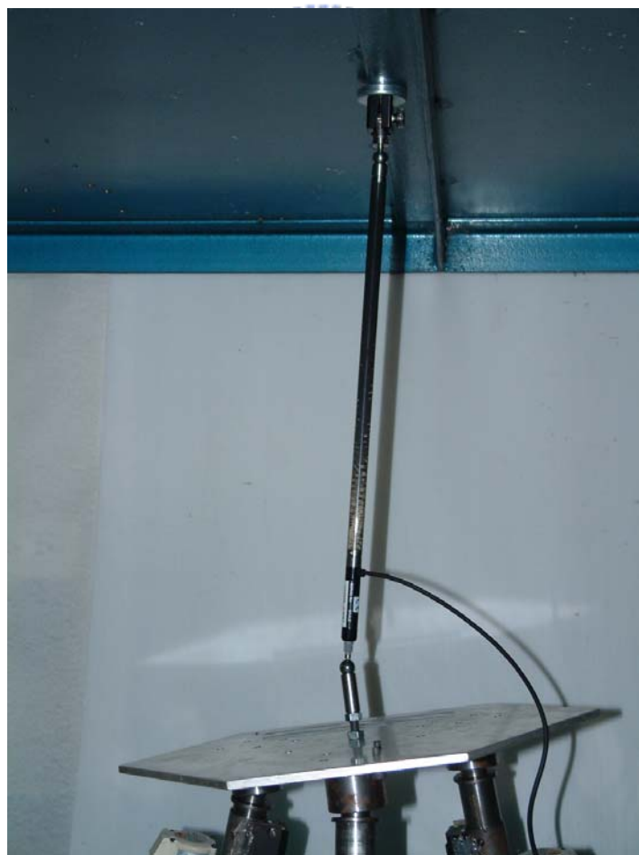
圖 4.3 Ballbar 實際架設示意圖(整體照片)
