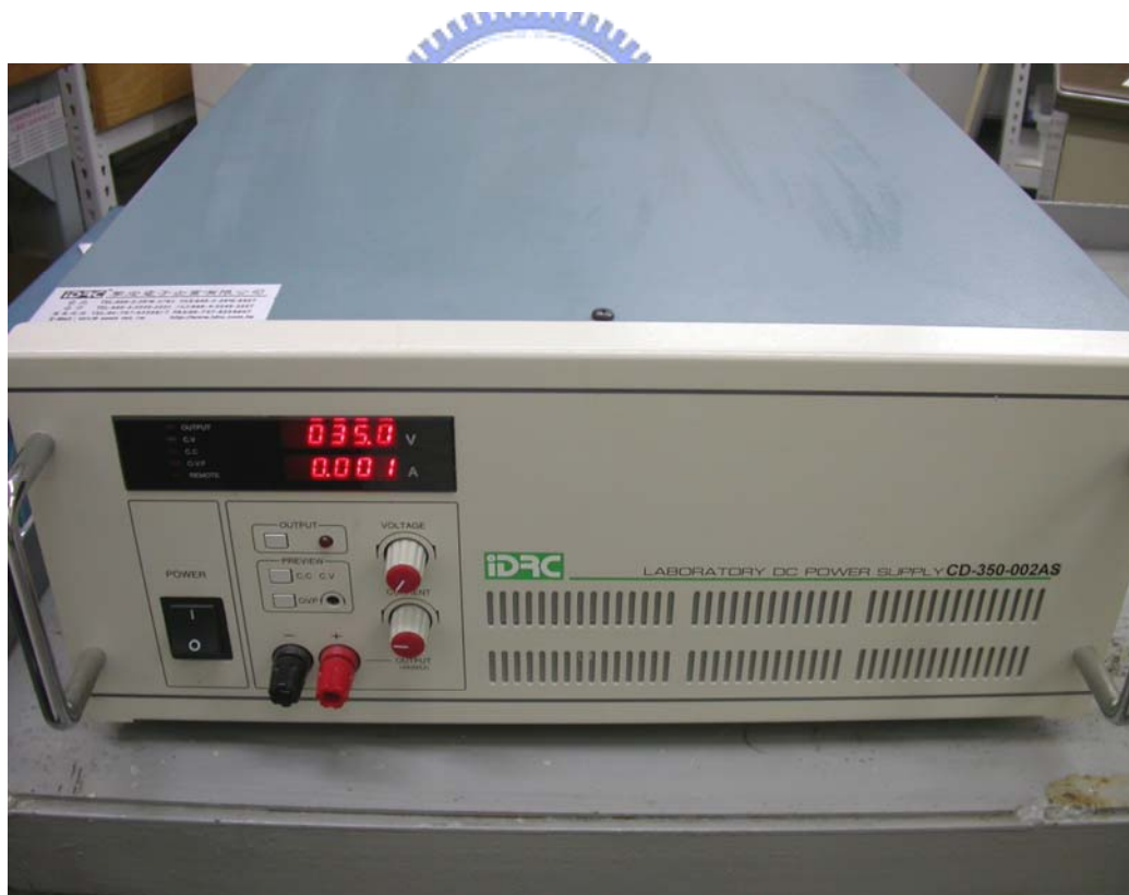
圖 3-4 直流電源供應器
