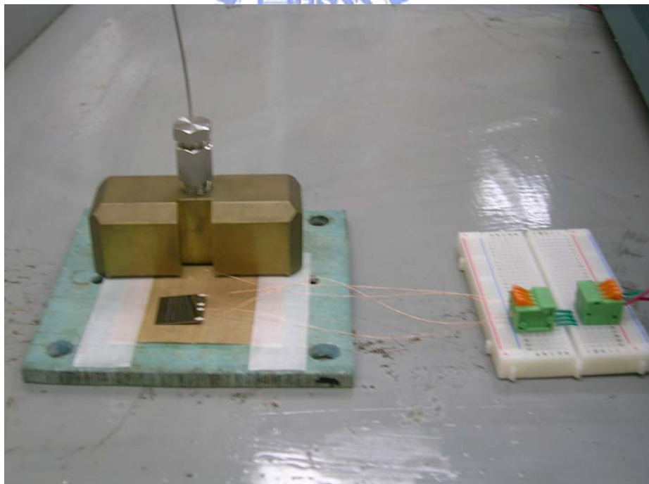
圖 2-7 模仁溫度量測裝置
