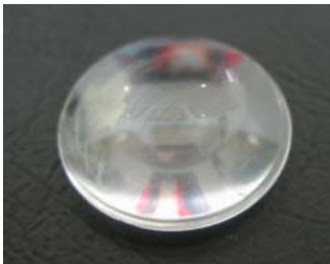
圖 5- 14 第二次壓印力 1960N ( 200Kgw ) 之成品圖 ( 縮短壓印時間 )
