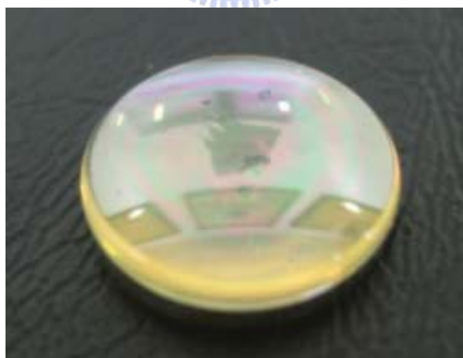
圖 5- 12 壓印力 2940N ( 300Kgw ) 之成品圖 ( Lens6 )
