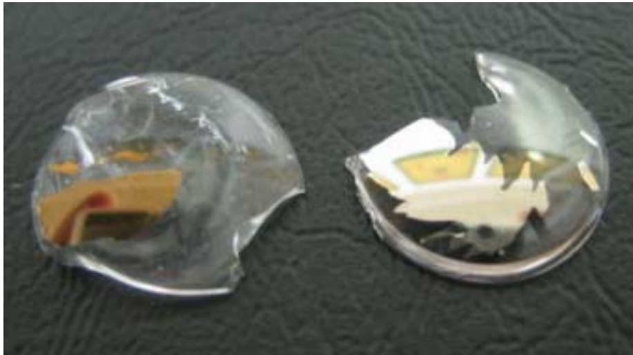
圖 5- 11 硬膜層鉑鈦 ( Pt-Ir ) 脫落現象
