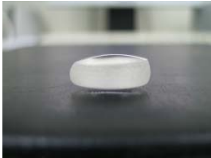
圖 5-9 壓印成品不均勻桶狀外形
