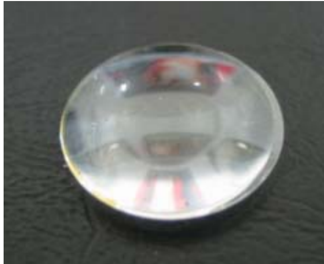
圖 5- 15 第三次壓印力 1960N ( 200Kgw ) 之成品圖 ( 縮短壓印時間 )
