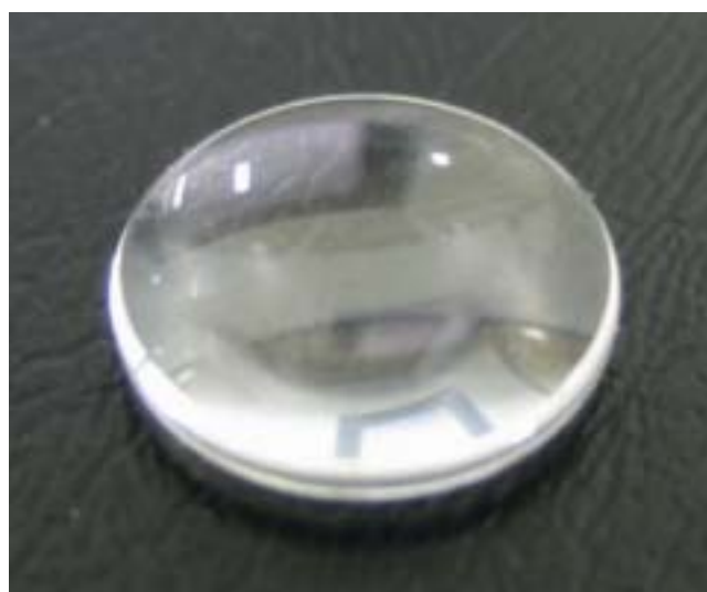
圖 5- 10 壓印力 2940N ( 300Kgw ) 之成品圖 ( Lens5 )
