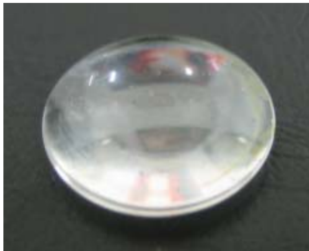
圖 5- 16 第四次壓印力 1960N ( 200Kgw ) 之成品圖 ( 縮短壓印時間 )
