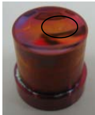
圖 5- 6 模仁壓印後玻璃沾黏現象
