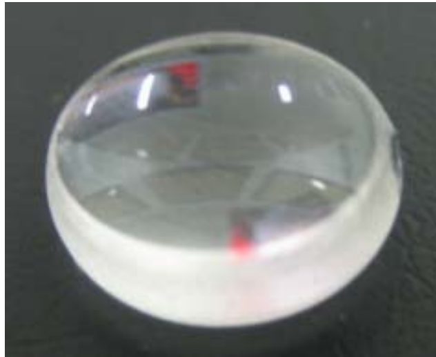
圖 5- 5 第二次壓印力 343N ( 35Kgw ) 之成品圖 ( Lens2 )
