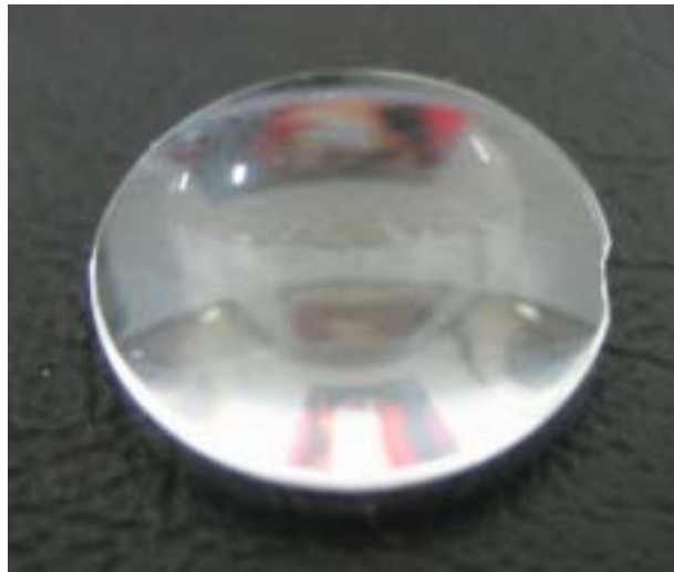
圖 5- 13 第一次壓印力 1960N ( 200Kgw ) 之成品圖 ( 縮短壓印時間 )
