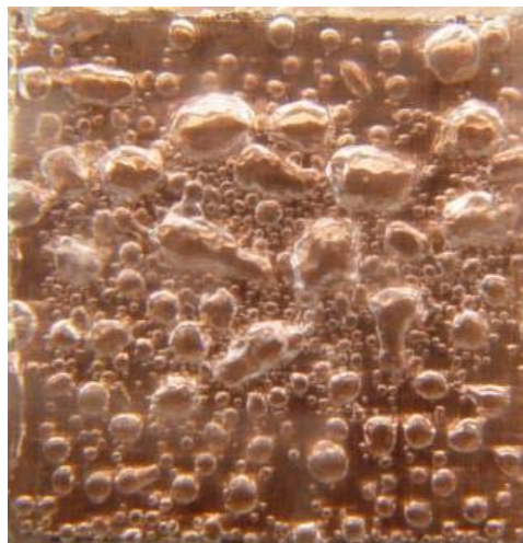
圖 4-37 1 atm， Re=2400 ，流向垂直 90^\circ ，次冷度 33^\circ\text{C} 之近臨界熱通量氣泡流譜圖
