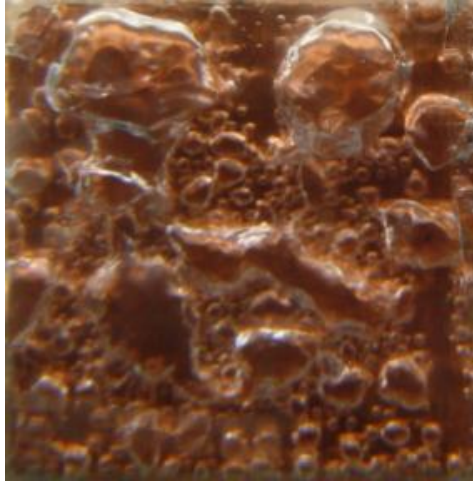
圖 4-35 1 atm， Re=2400 ，流向垂直 90^\circ ，次冷度 23^\circ\text{C} 之近臨界熱通量氣泡流譜圖
