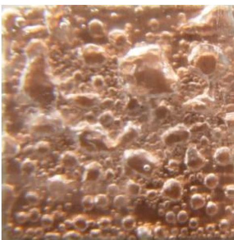
圖 4-34 1 atm， Re=1600 ，流向垂直 90^\circ ，次冷度 33^\circ\text{C} 之近臨界熱通量氣泡流譜圖
