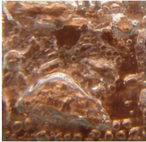
圖 4-29 1 atm， Re=800 ，流向垂直 90^\circ ，次冷度 23^\circ\text{C} 之近臨界熱通量氣泡流譜圖
