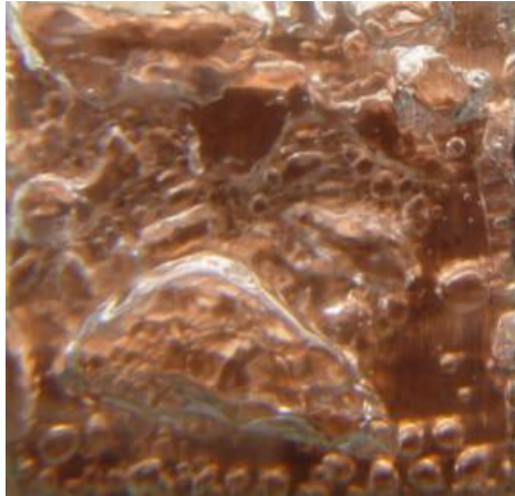
圖 4-51 1 atm， Re=800 ，流向垂直 90^\circ ，次冷度 23^\circ\text{C} 之近臨界熱通量氣泡流譜圖
