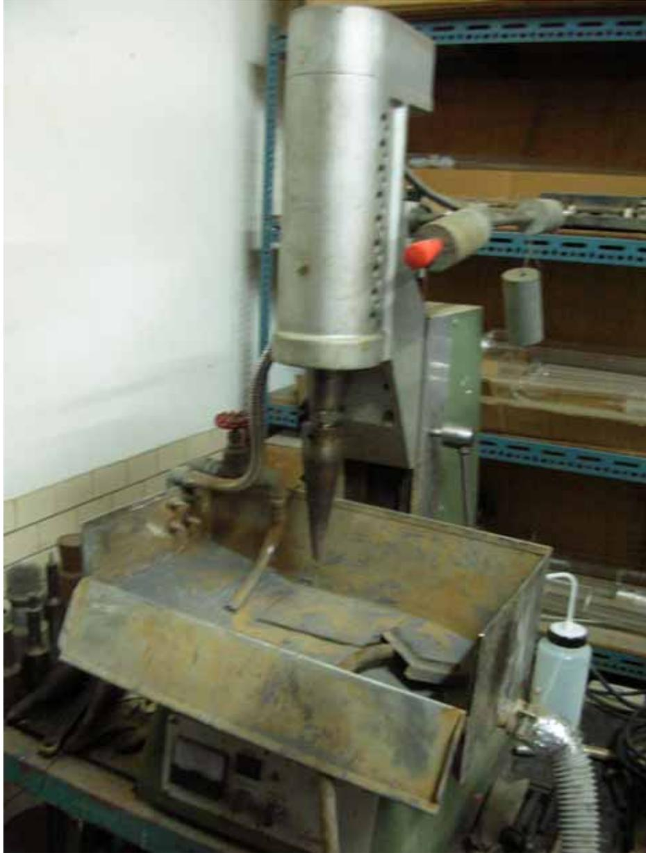
圖 2-11 超音波震動鑽孔機
