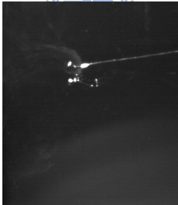
(c) 鎳鉻絲放置於延長渠道內部流體出口處
