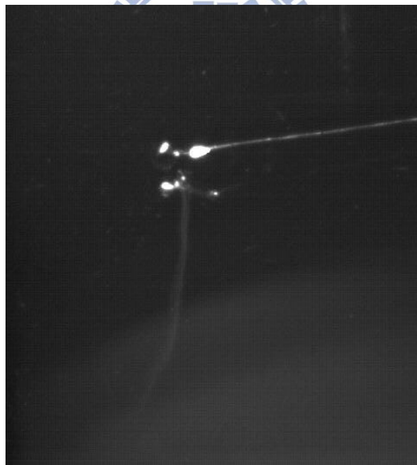
(c) 鎳鉻絲放置於延長渠道內部流體出口處
