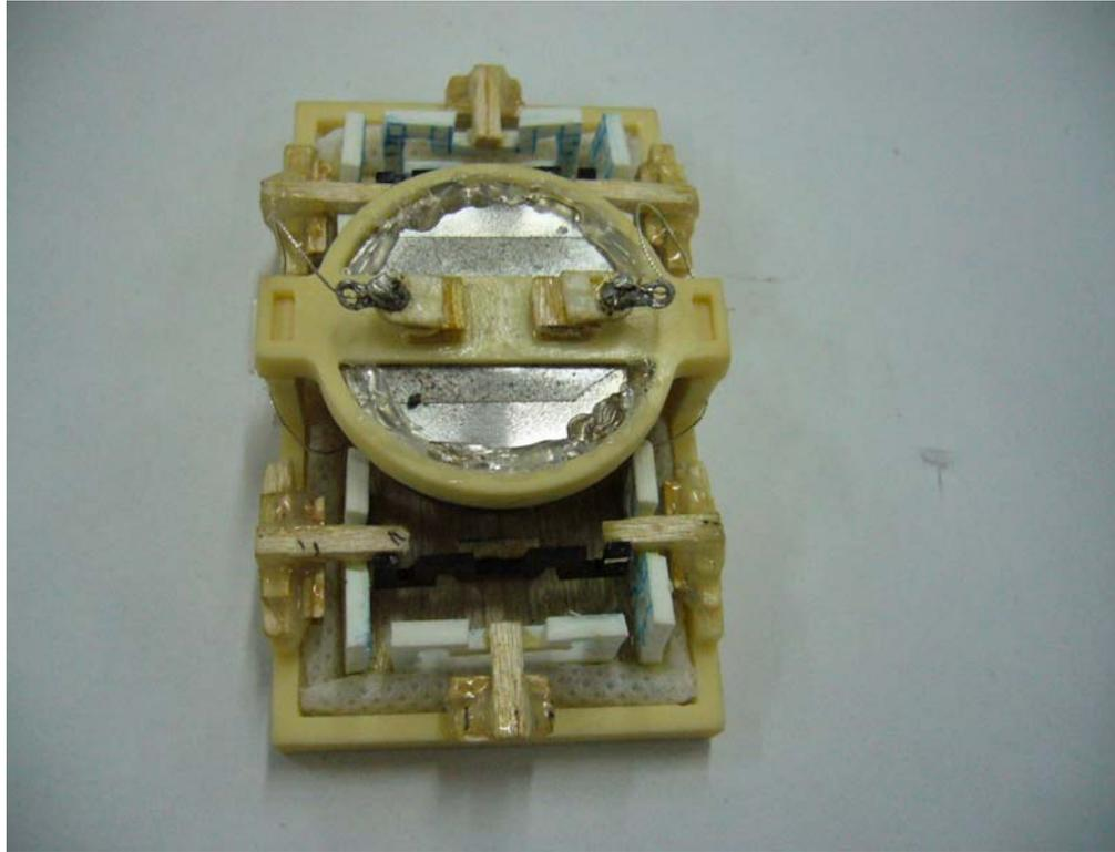
圖 6.9 平面揚聲器實體圖(系統 B)
