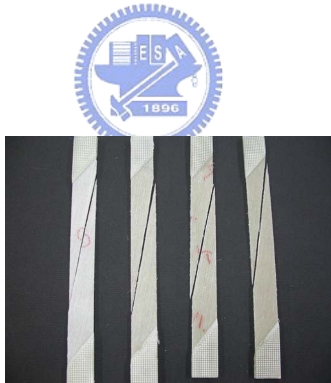
圖 3.34 同向性 E-LR 0908-14 玻璃纖維/環氧樹脂奈米複合材料在側向拉伸試驗後試片破壞情形(由左至右依序為有機黏土含量比重為 0%; 2.5%; 5%; 7.5%)
