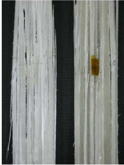
圖 3.13 同向性 E-LR 0908-14 玻璃纖維/環氧樹脂奈米複合材料在纖維方向拉伸試驗後試片破壞情形(由左至右依序為有機黏土含量比重為 0%; 5%)
