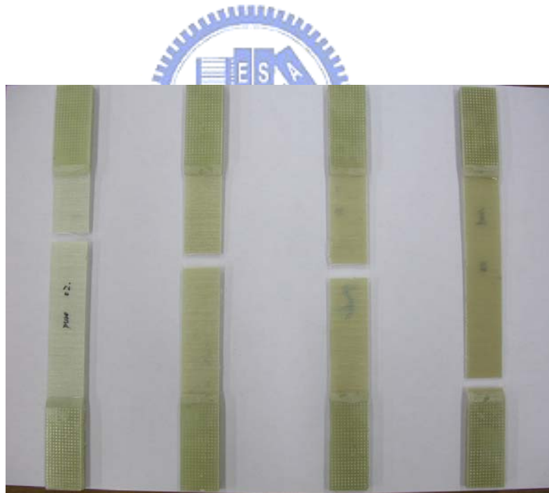
圖 3.24 同向性 E-LR 0908-14 玻璃纖維/環氧樹脂奈米複合材料在橫向拉伸試驗後試片破壞情形(由左至右依序為有機黏土含量比重為 0%; 2.5%; 5%; 7.5%)
