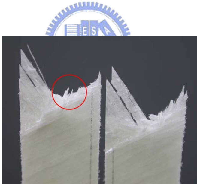
圖 4.14 E-LR 0908-14 [60/15/-75/-30] s 玻璃纖維/環氧樹脂奈米複合材料在拉伸試驗後試片破壞情形
