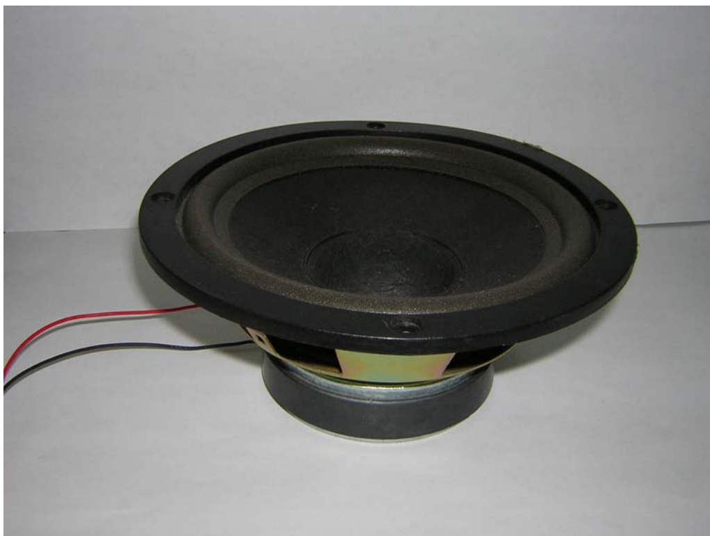
圖 1-1 傳統振動板為錐盆型的揚聲器
