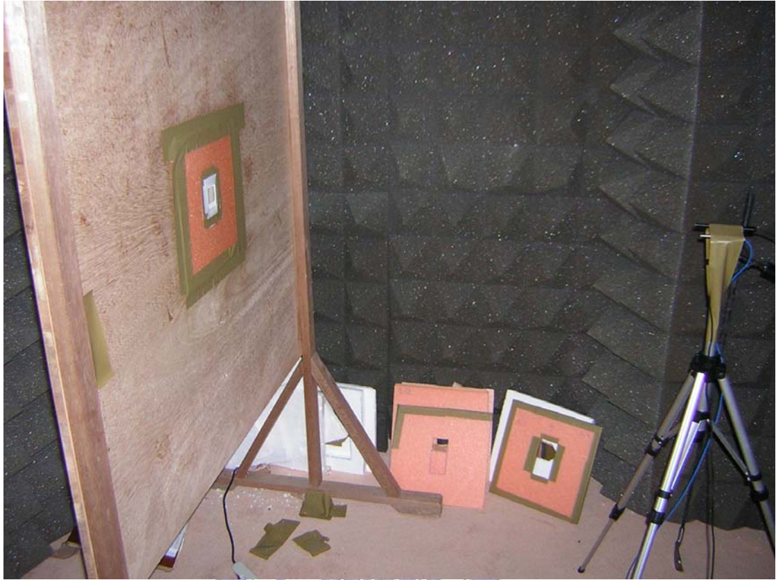
圖 4-21 聲壓量測實驗架設圖
