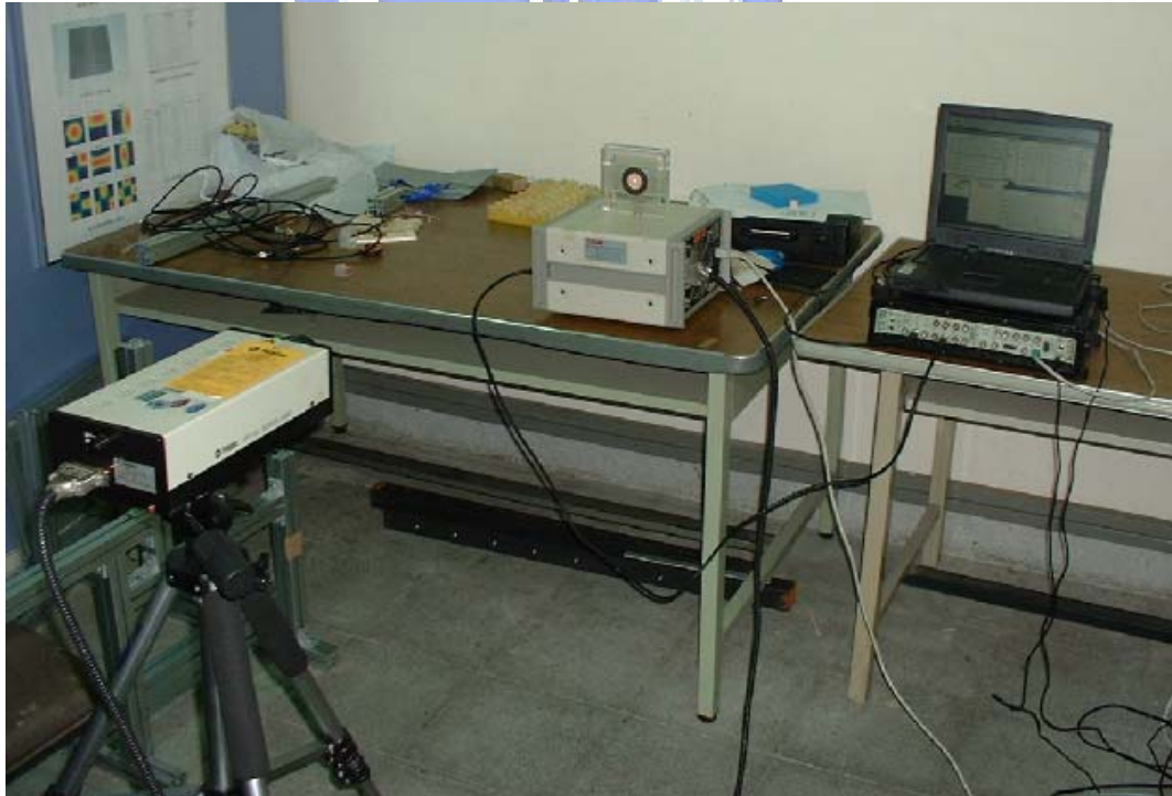
圖 4-20 阻尼比量測實驗架設圖
