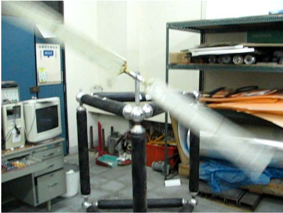
圖 6-21 雙葉片風力機架構運轉測試
