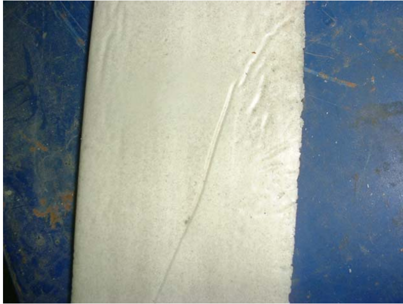
圖 5-4 用一般布料墊厚導致的缺陷
