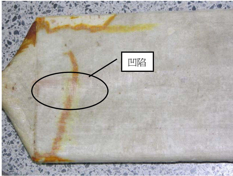
圖 3-14 內部較軟的發泡受熱變形融化
