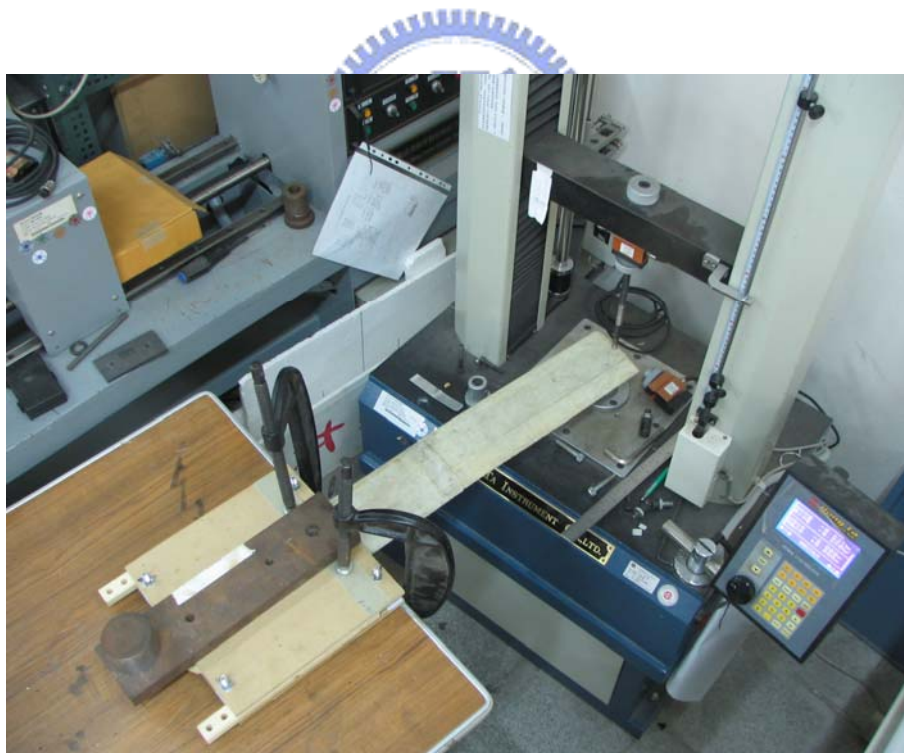
圖 6-10 三明治翼型結構撓度試驗架設
