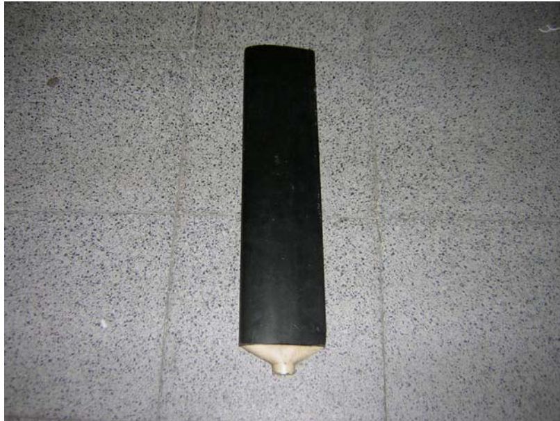
圖 3-4 先作外殼再發發泡的作法
