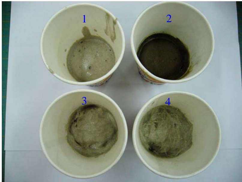
圖 3-8 發泡填充物之添加，圖中編號 1 為原發泡 ；2 為添加海藻粉；3 為添加木粉；4 為添 加短玻纖維
