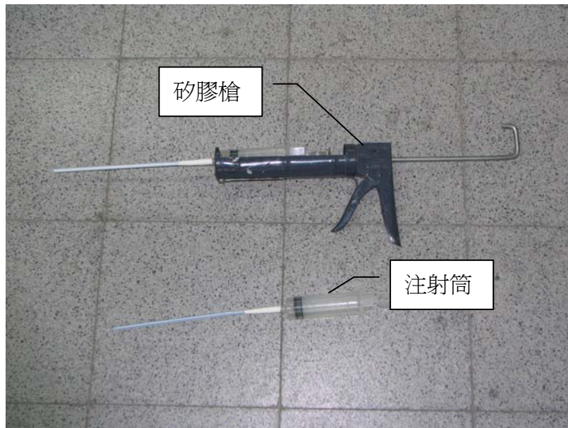
圖 5-10 發泡放入注射筒再用矽膠槍填入連接機構
