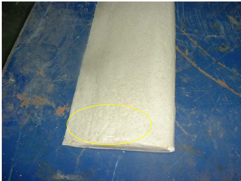
圖 3-9 發泡尚未完全硬化成型即拆模導致發泡日後變形
