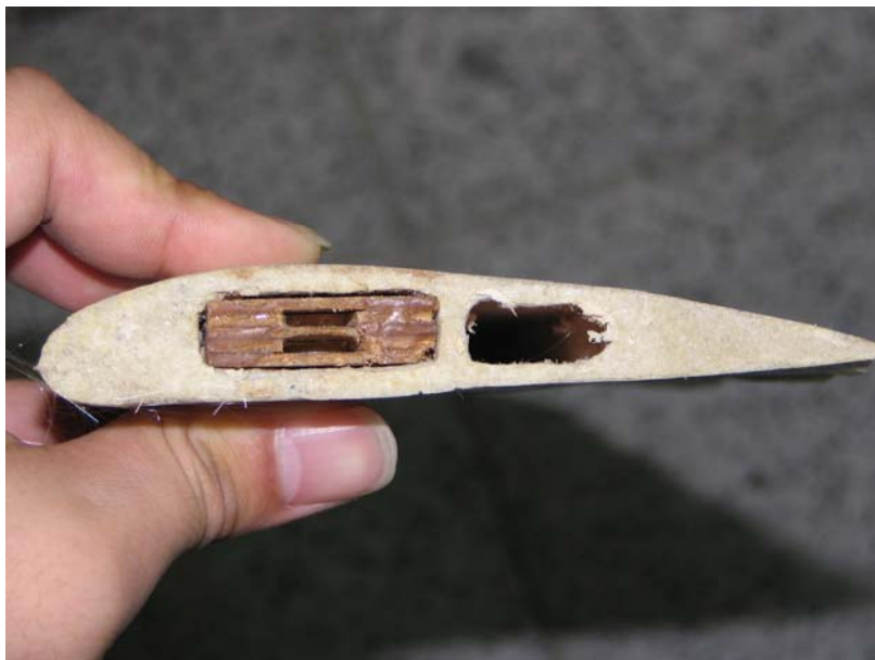
圖 5-3 空洞中填入巴沙木塊以防受壓變形
