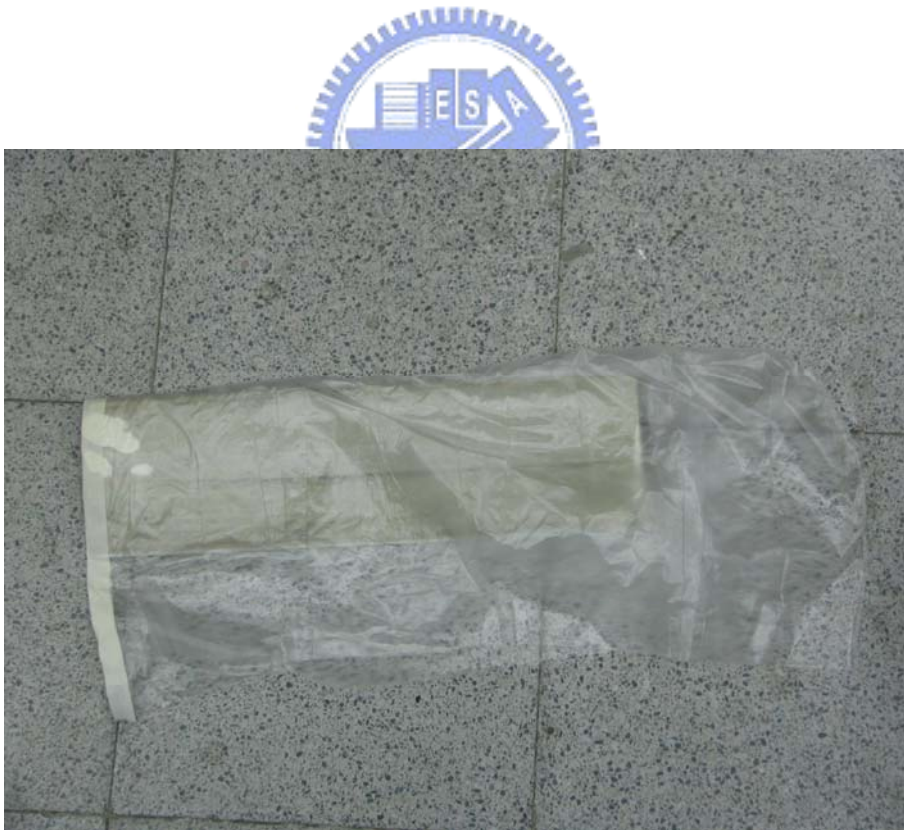
圖 5-9 貼上塑膠布防止後續步驟遭到發泡沾污
