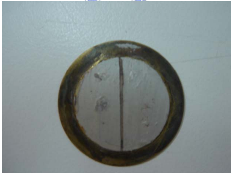
圖 3.3 碟型壓電致動器電極塗佈完成圖
