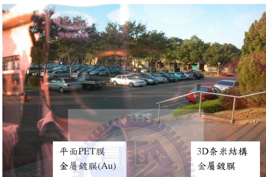
圖5.47 金屬(Au)薄膜試片外景實拍測試比較(膜厚25nm)
