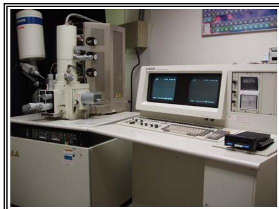
圖4.17 場發射掃描式電子顯微鏡
