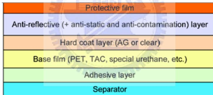
圖 1.3 抗反射(AR)塑膠膜片結構[2]
