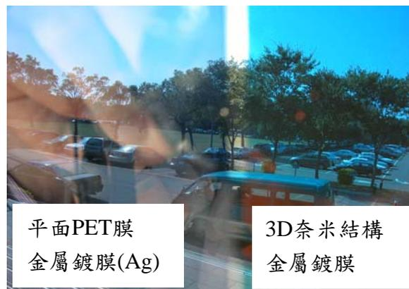
圖 5.51 金屬 (Ag) 薄膜試片外景實拍測試比較(膜厚 25nm)
