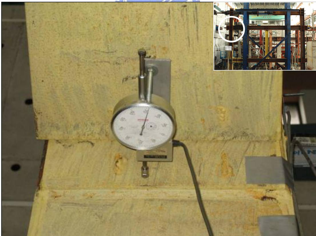
照片 4.16 試體 P1M2 接頭扭轉導致上梁往左方位移
