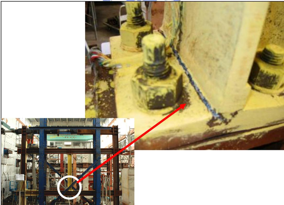
照片 4.4 試體 P1M1 消能間柱翼板外與端板接合處有明顯的裂痕
