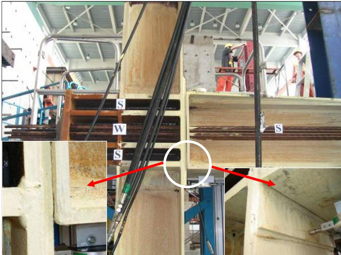
照片 4.2 試體 P1M1 +0.375% (24 mm)梁柱接合處開啟
