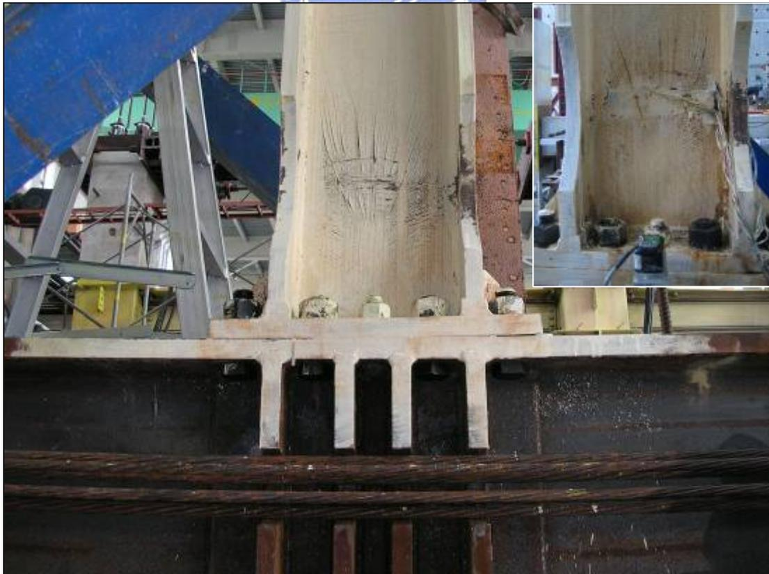
照片 4.12 試體 P1M2 下梁與間柱接頭處消能間柱降伏狀況
