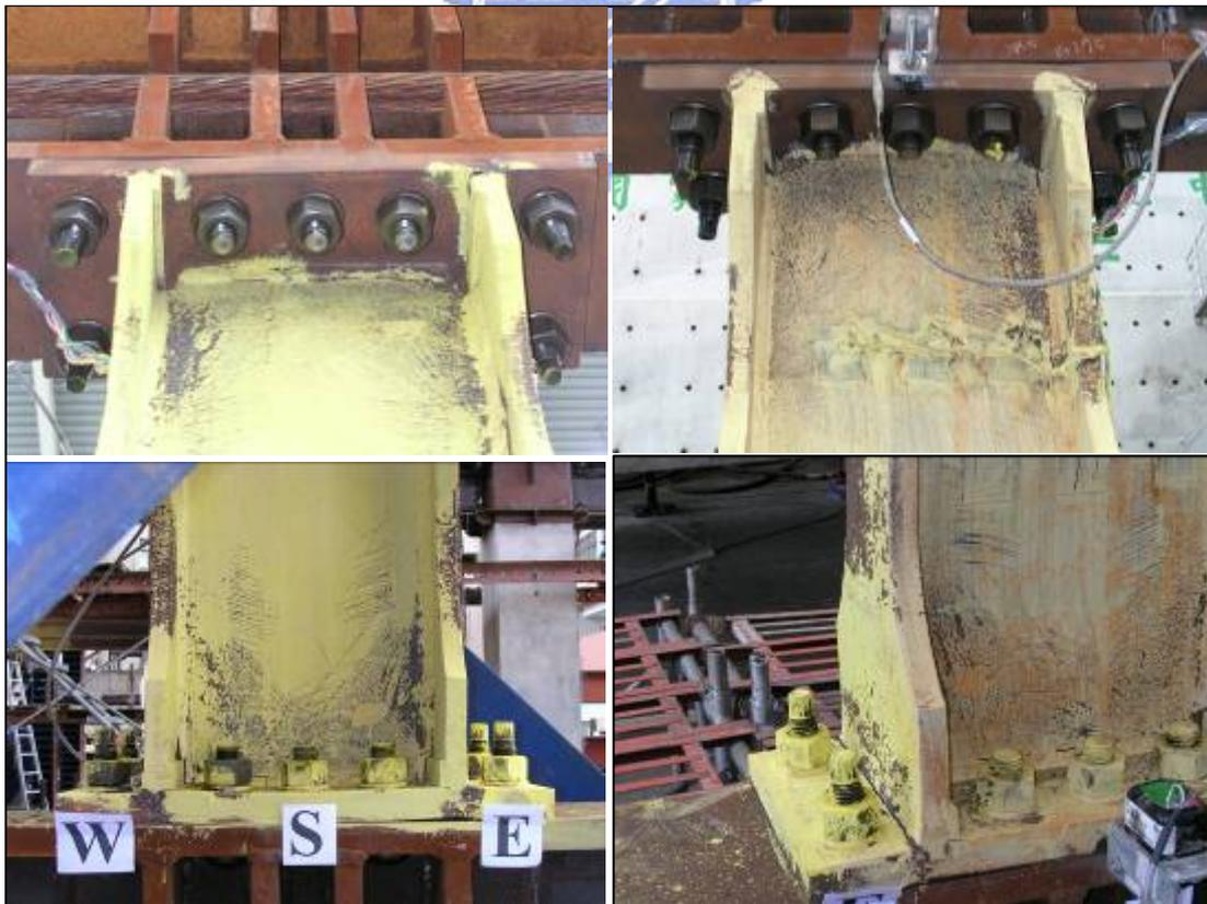
照片 4.8 試體 P1M1 試驗停止後消能間柱降伏狀況
