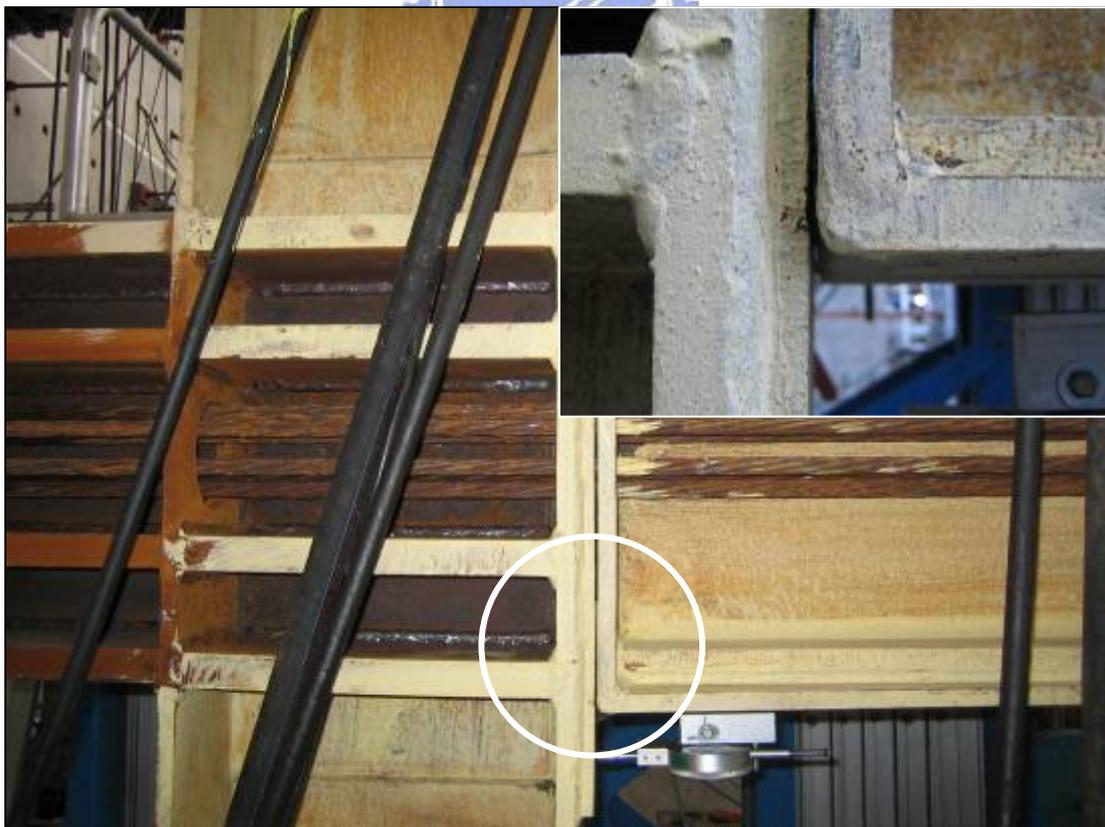
照片 4.10 試體 P1M2 +0.5%下梁左方梁柱接合面有明顯的開啟
