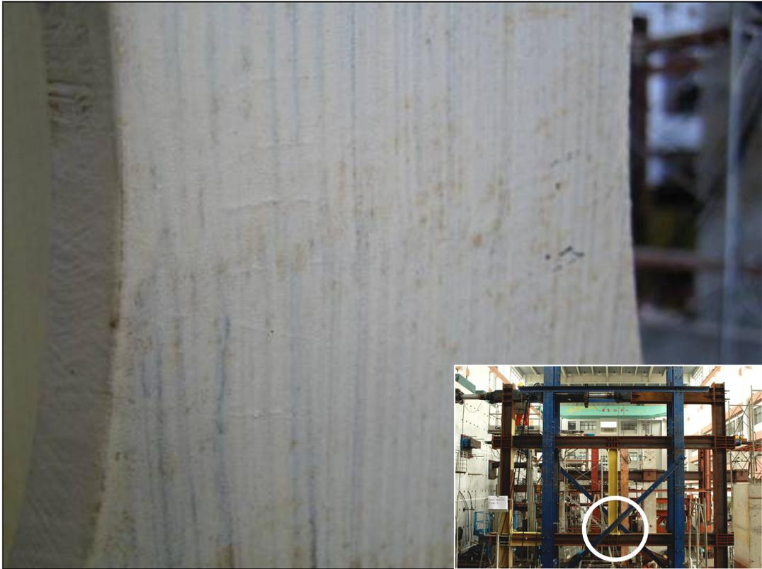
照片 4.11 試體 P1M2 消能間柱翼板開始出現降伏狀況
