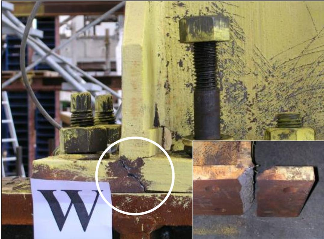
照片 4.7 試體 P1M1 螺栓發生頸縮端板破裂的現象
