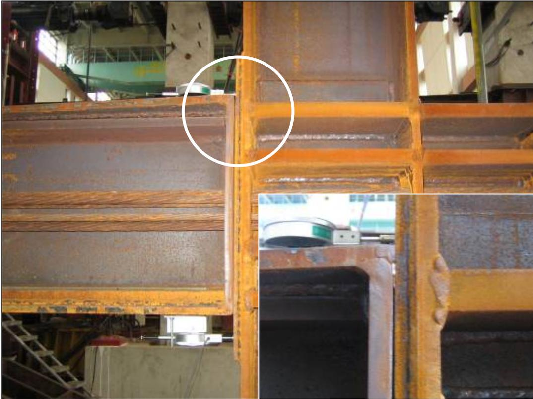
照片 4.9 試體 P1M2 +0.5%下梁右方梁柱接合面有明顯的開啟
