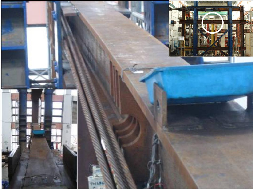
照片 4.15 試體 P1M2 預力損失導致左右預力不同上梁面外挫屈
