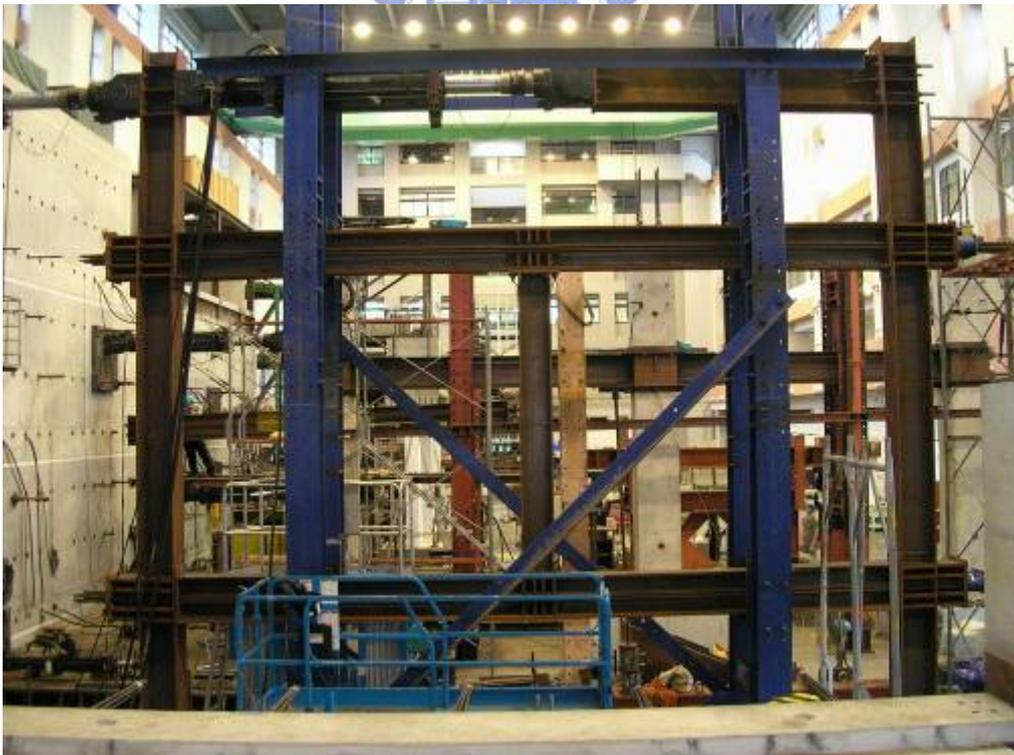
照片 3.7 試體側向束制支撐配置圖
