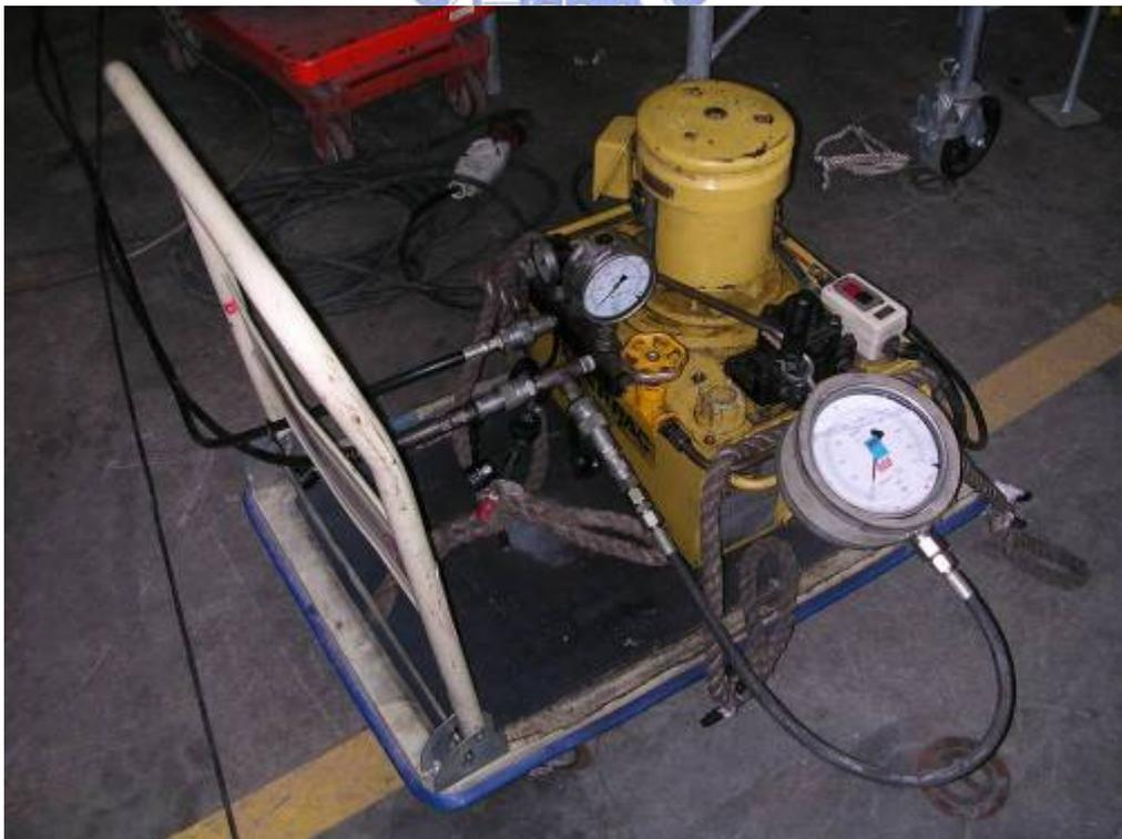
照片 3.3 ENERPAC P3045N 油壓機
