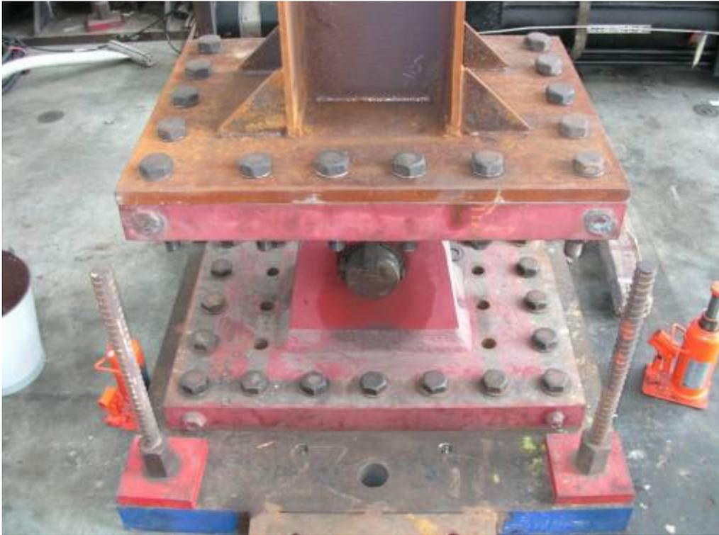
照片 3.6 試體設置鉸接底座圖
