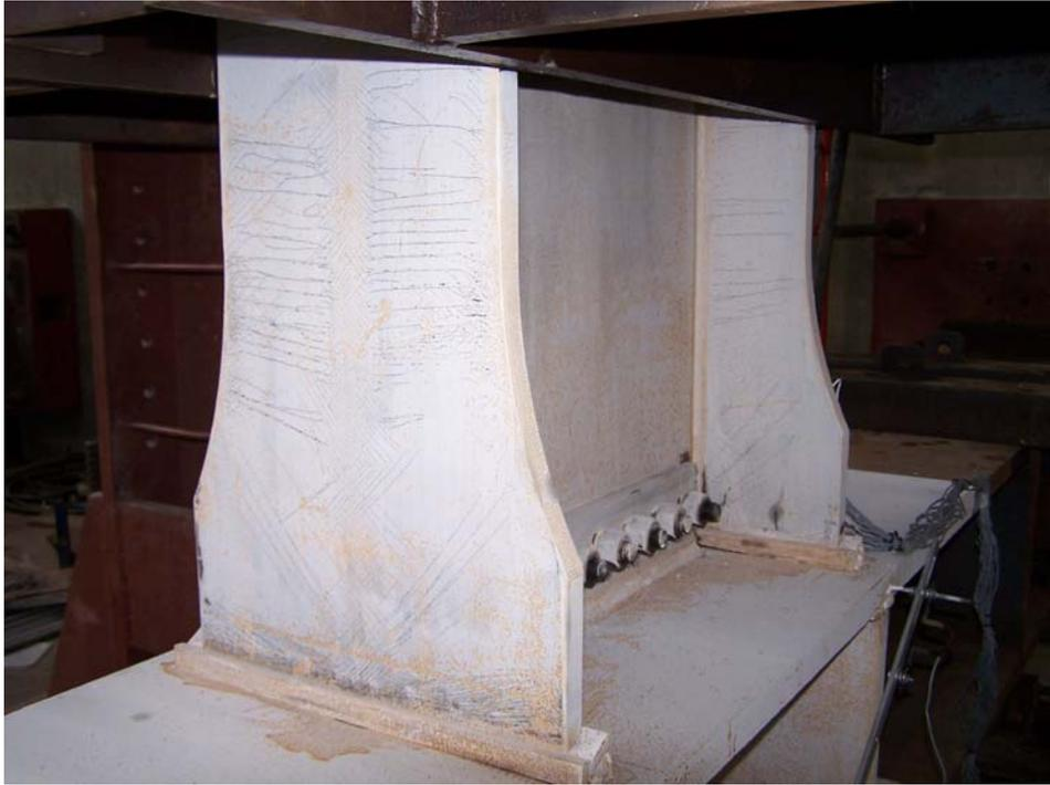
照片 3.23 試體 WF7-1 扇形開孔處之石灰剝落沿著與梁縱向夾 45 度方向外延伸 (1.5% drift)
