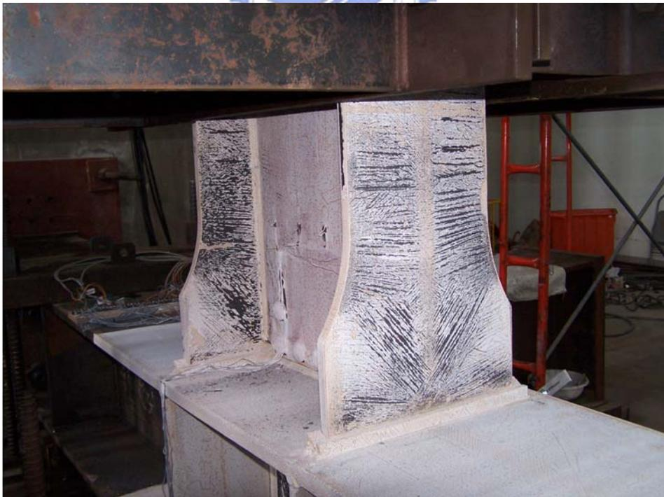
照片 3.10 試體 WF6-1 於梁翼上呈現顯著石灰脫落 (3% drift)
