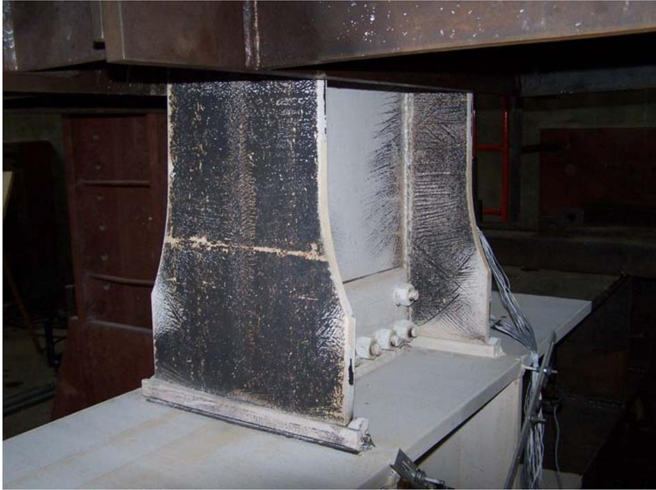
照片 3.21 試體 WF6-3 於第二迴圈正方向時，梁下翼板於全滲透銲道處產生撕裂破壞 (5% drift)
