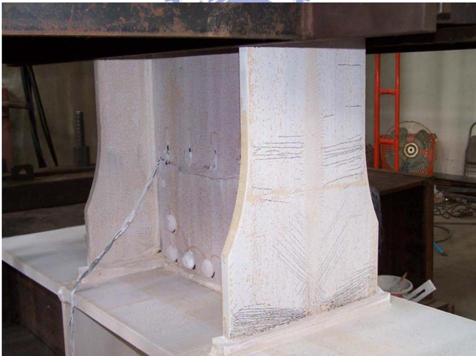
照片 3.18 試體 WF6-3 於梁翼板上圓弧末端出現橫向石灰剝落，扇形開孔處斜向剝落斑紋往兩側延伸 (1.5% drift)
