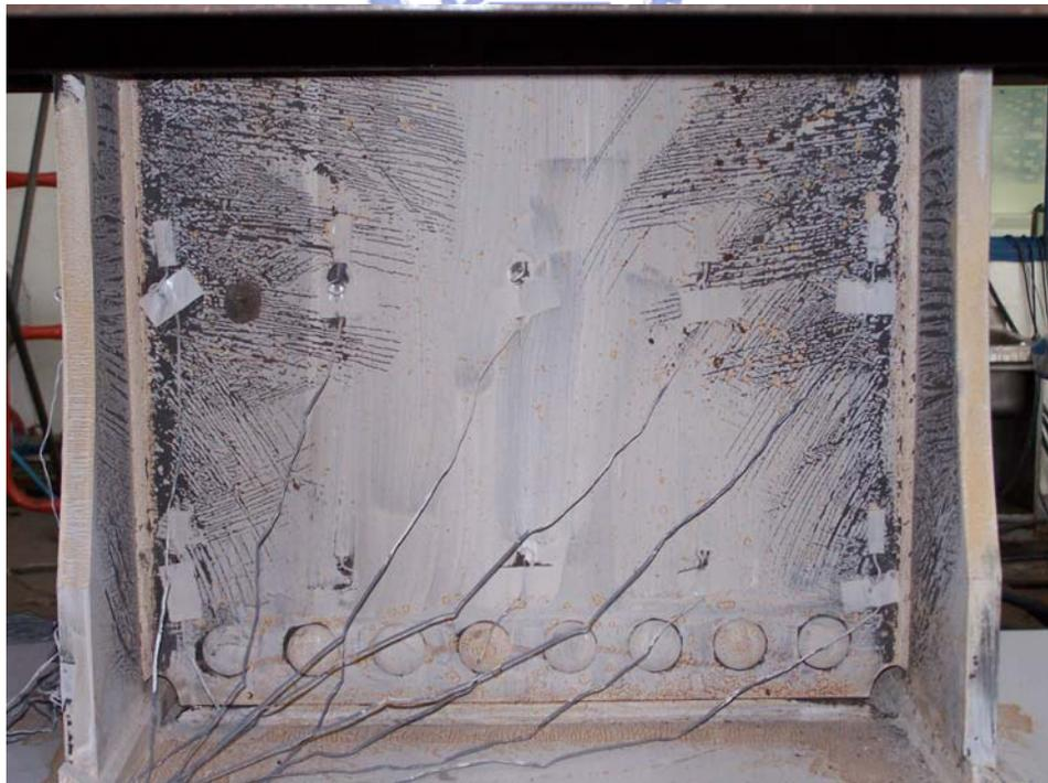
照片 3.24 試體 WF7-1 於梁腹板之石灰剝落增多且從兩側向中心延伸 (3% drift)
