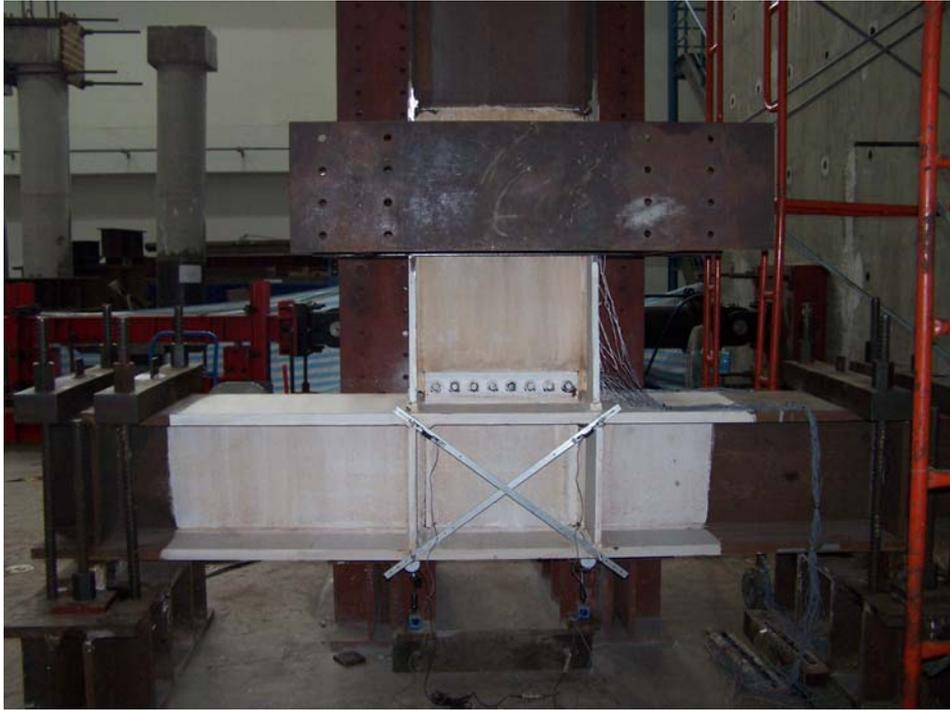
照片 3.3 梁柱交會區量測儀器配置情形
