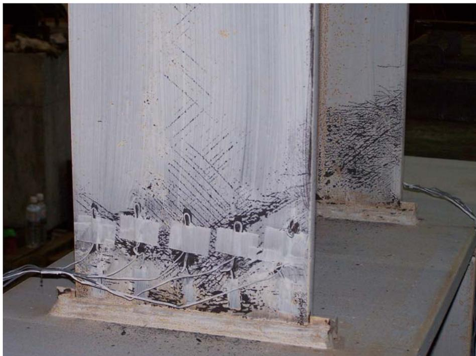
照片 3.5 試體 PN 翼板之石灰剝落增多 (2% drift)
