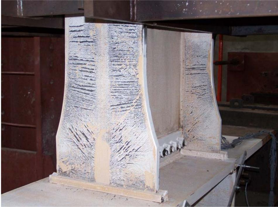
照片 3.27 試體 WF7-2 於梁翼板圓弧末端之橫向條紋狀石灰剝落增多且往遠離柱面方向擴展 (2% drift)
