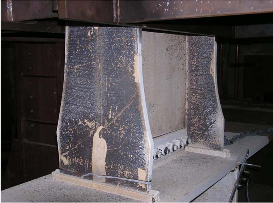
照片 3.31 試體 WF7-2 最終因裂縫繼續延伸導致下翼板沿寬度方向撕裂破壞 (4% drift)
