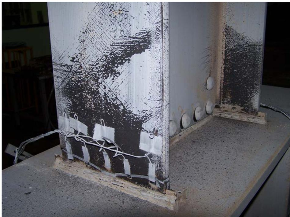
照片 3.7 試體 PN 上翼板沿寬度方向撕裂 (3% drift)
