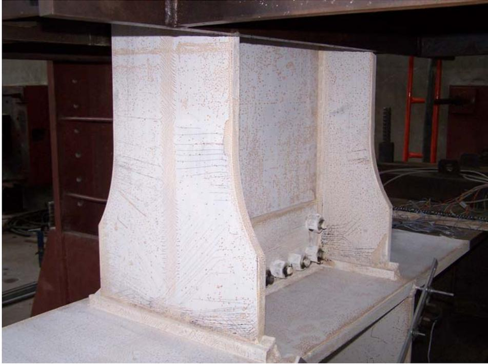
照片 3.9 試體 WF6-1 於梁翼圓弧末端出現橫向斑紋石灰剝落 (2% drift)
