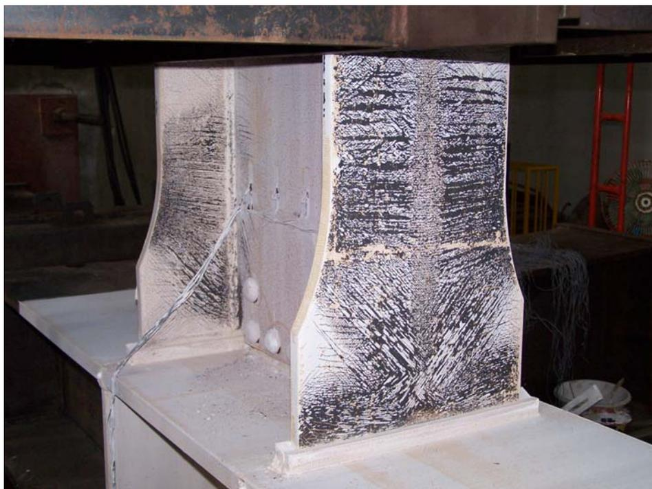
照片 3.19 試體 WF6-3 於梁翼板上的石灰大部分皆已脫落
