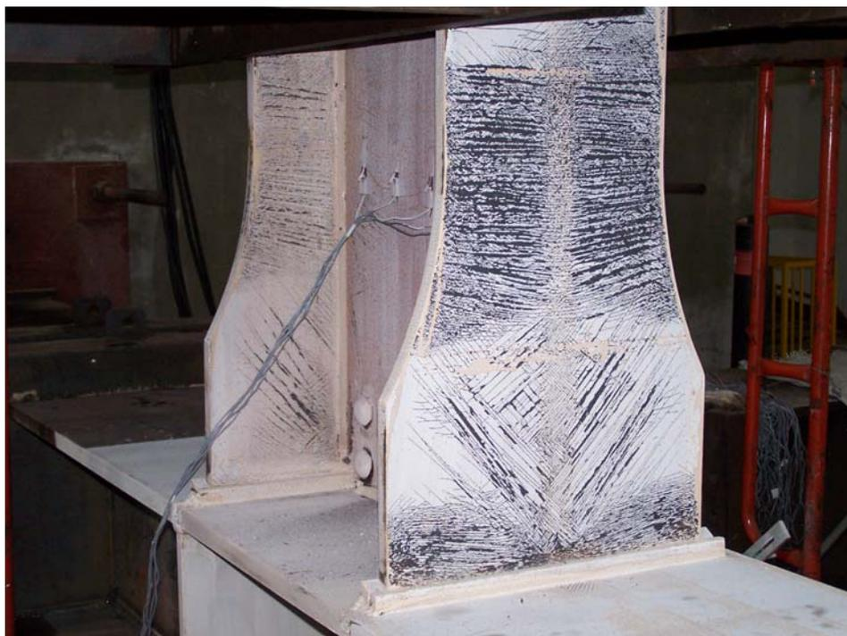
照片 3.15 試體 WF6-2 於梁翼板上之全滲透銲道、扇形開孔與圓弧末端處石灰剝落密佈 (2% drift)
