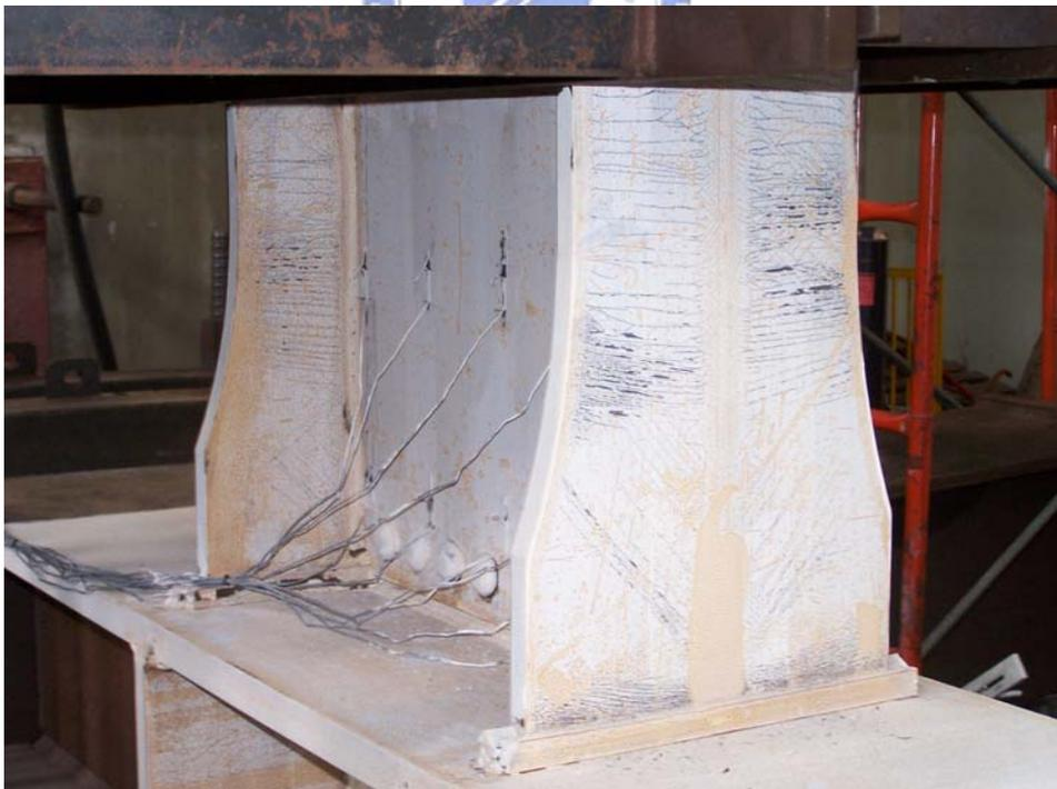
照片 3.26 試體 WF7-2 於梁翼全滲透鐸道處石灰剝落增加，扇形開孔處之石灰剝落由翼板中心呈幅射狀延伸 (1.5% drift)
