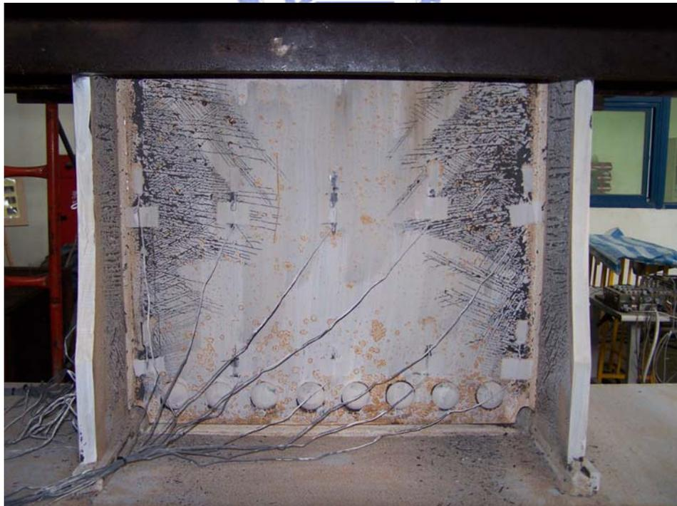
照片 3.28 試體 WF7-2 於梁腹板兩側石灰剝落增加並向梁腹中心伸入，塑鉸將於此處產生 (3% drift)
