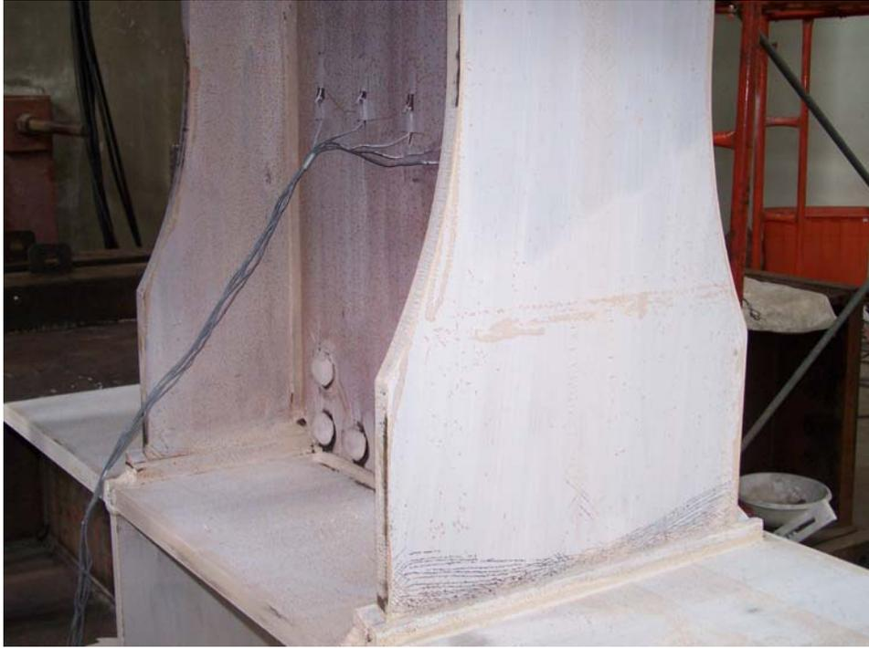
照片 3.13 試體 WF6-2 於梁翼全滲透鐸道處之橫紋石灰剝落逐漸增多擴張 (0.75% drift)
