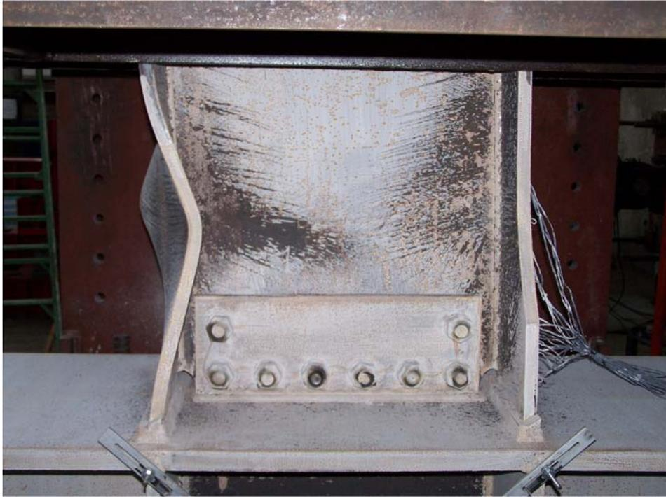
照片 3.11 試體 WF6-1 於下翼板發生明顯局部挫屈 (5% drift)
