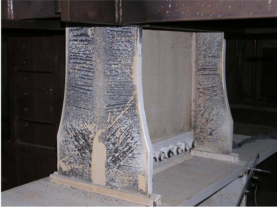
照片 3.29 試體 WF7-2 於梁翼板上之石灰脫落明顯，試體呈現大範圍區域降伏 (4% drift)
