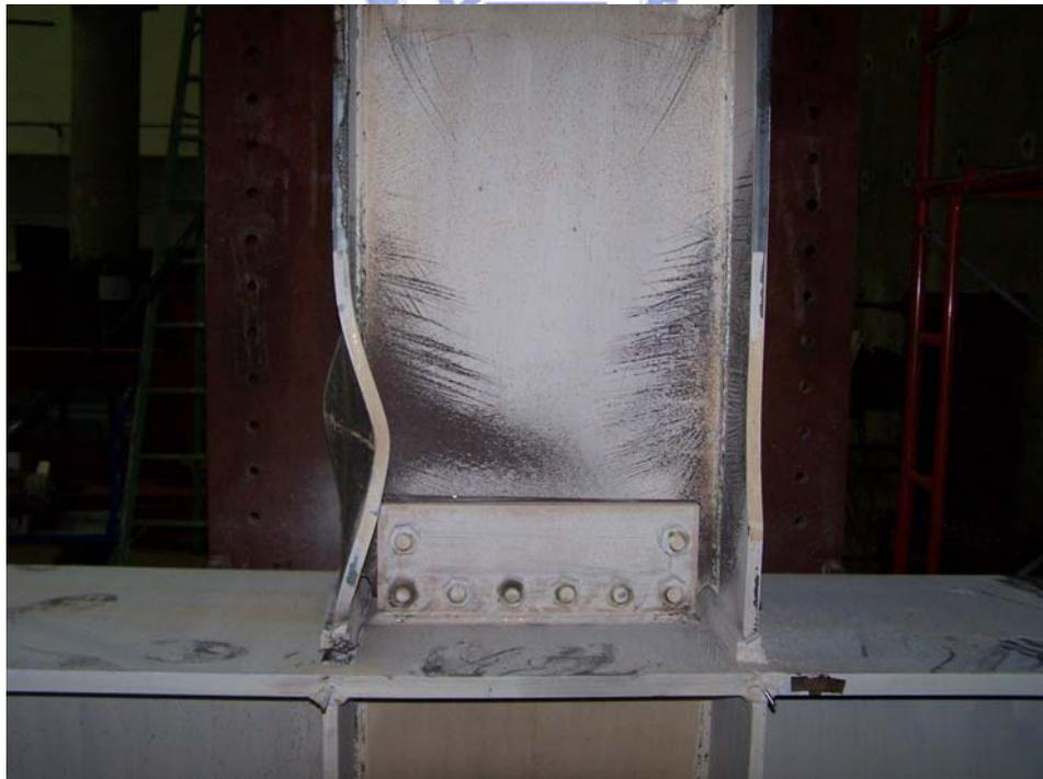
照片 3.22 試體 WF6-3 完成負方向行程後，下翼板呈現明顯局部挫屈 (5.8% drift)
