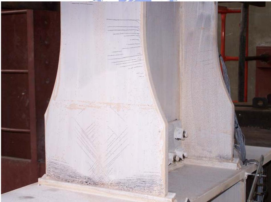
照片 3.14 試體 WF6-2 於梁翼板上之全滲透鐸道、扇形開孔與圓弧末端處石灰剝落密佈 (2% drift)
