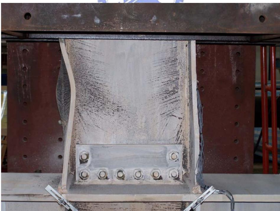
照片 3.16 試體 WF6-2 於梁下翼板發生局部挫屈且梁腹兩側石灰剝落向梁腹中心延伸擴張 (5% drift)
