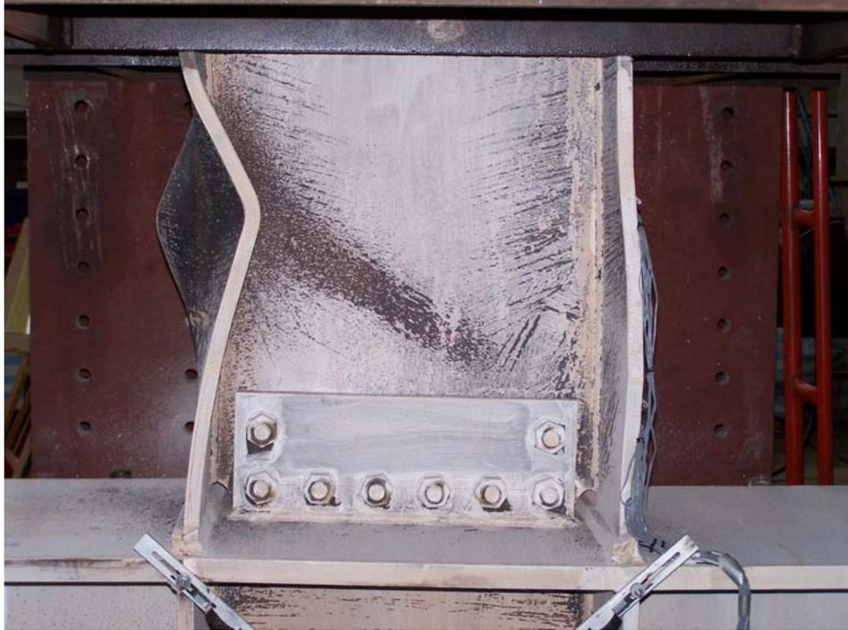
照片 3.17 試體 WF6-2 最終於梁下翼板發生嚴重局部挫屈且梁柱交會區有些許變形產生 (5.8% drift)
