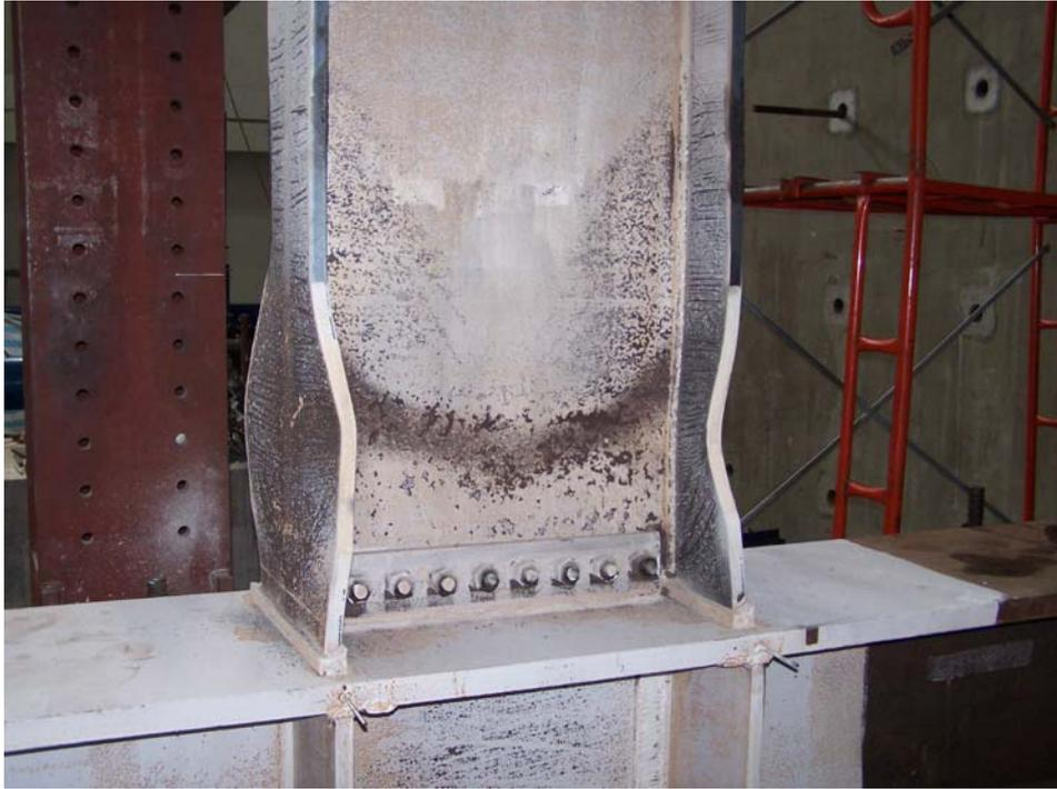
照片 3.25 試體 WF7-1 最終呈現局部挫屈，且塑鉸行成於圓弧末端處
