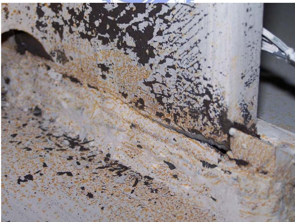
照片 3.6 試體 PN 於下翼板全滲透銲道處發生部分開裂 (3% drift)
