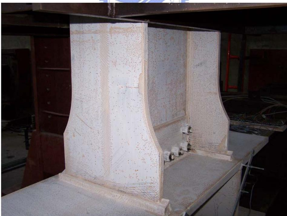
照片 3.8 試體 WF6-1 於梁翼全滲透銲道處與扇形開孔位置呈現橫向及斜向石灰剝落 (1% drift)
