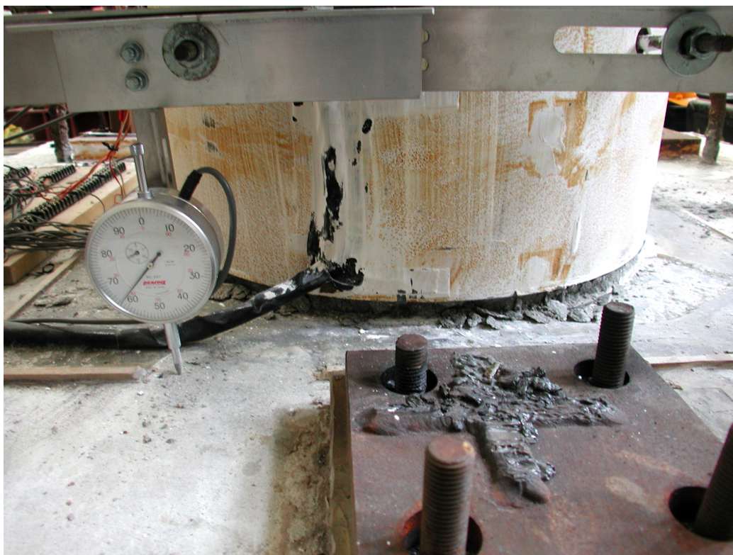
照片 3.27 第一節底部裂縫( \theta = -0.04 弧度)
