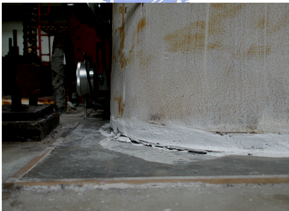
照片 3.18 第一節底部裂縫( \theta = +0.009 弧度)
