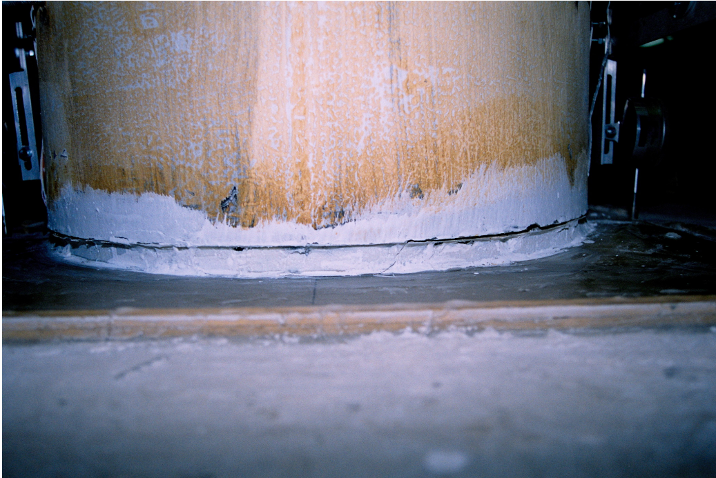
照片 3.3 環氧樹脂部分出現約 45 度的斜細裂縫( \theta = -0.009 弧度)
