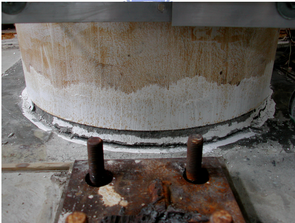
照片 3.22 第一節底部裂縫( \theta = -0.02 弧度)
