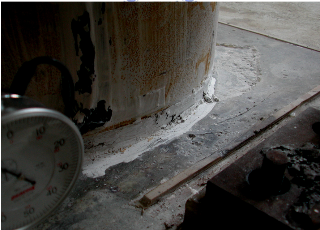
照片 3.16 混凝土剝落情形( \theta = -0.006 弧度)
