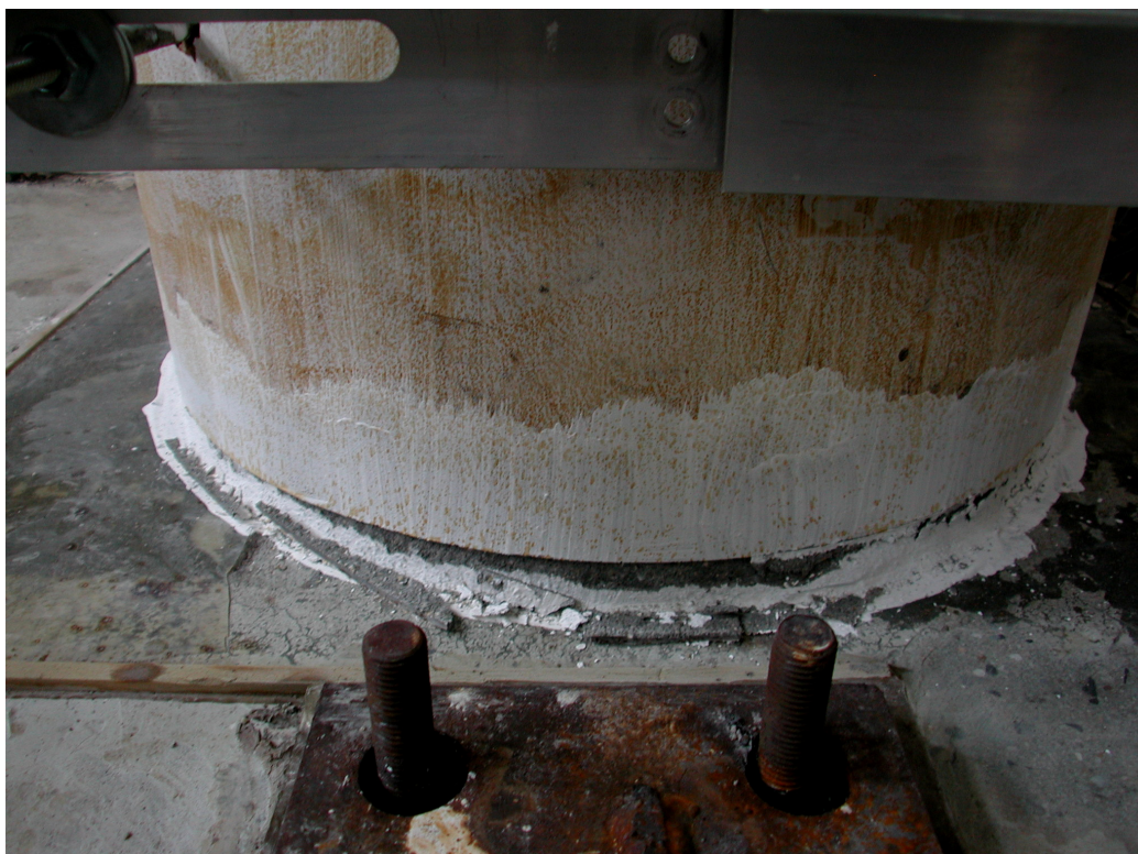
照片 3.17 混凝土剝落情形( \theta = +0.009 弧度)
