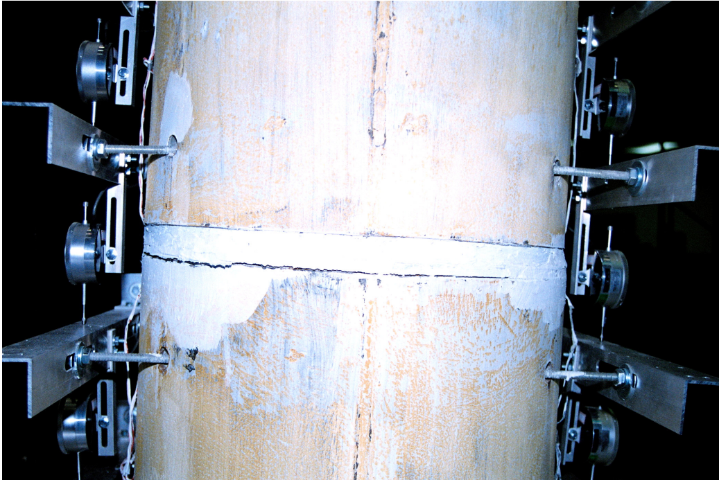
照片 3.11 第一、第二節塊間拉力側裂縫( \theta = -0.06 弧度)
