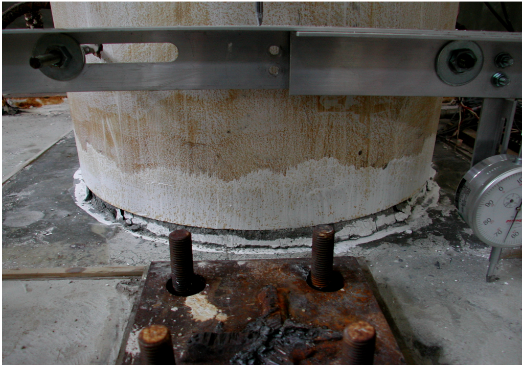
照片 3.21 混凝土剝落情形( \theta = +0.02 弧度)
