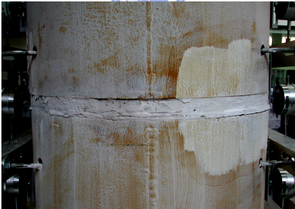
照片 3.26 第一、第二節塊間裂縫情形( \theta = +0.03 弧度)
