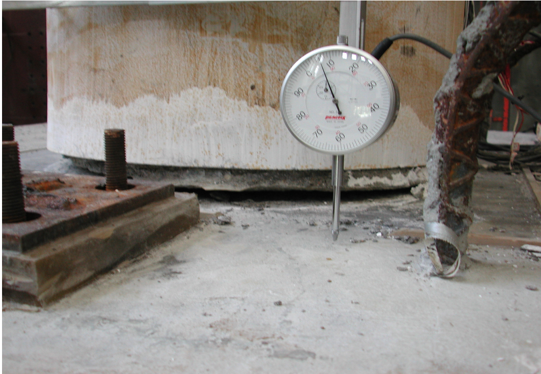
照片 3.29 第一節底部裂縫( \theta = -0.05 弧度)
