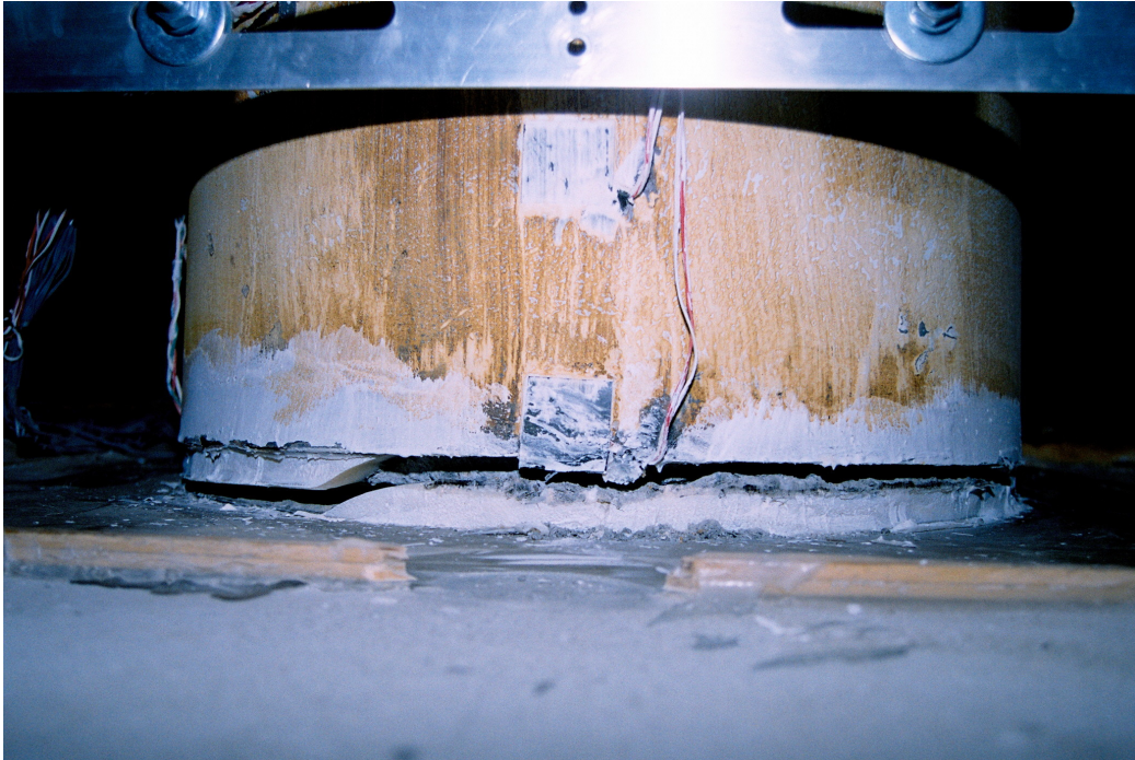
照片 3.7 第一節塊底部裂縫( \theta = -0.05 弧度)
