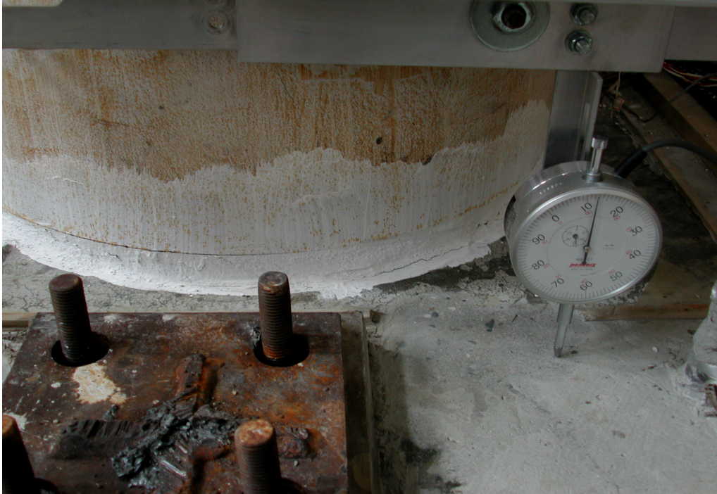
照片 3.15 無鋼管圍束石膏微小裂縫( \theta = +0.004 弧度)
