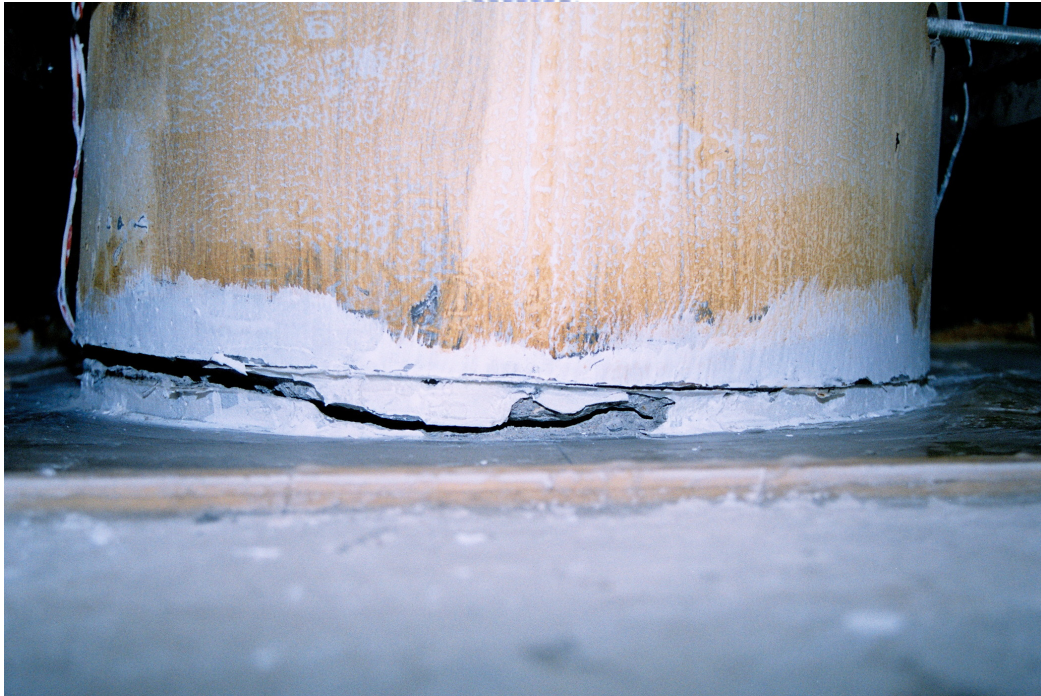
照片 3.10 環氧樹脂脫落( \theta = -0.06 弧度)
