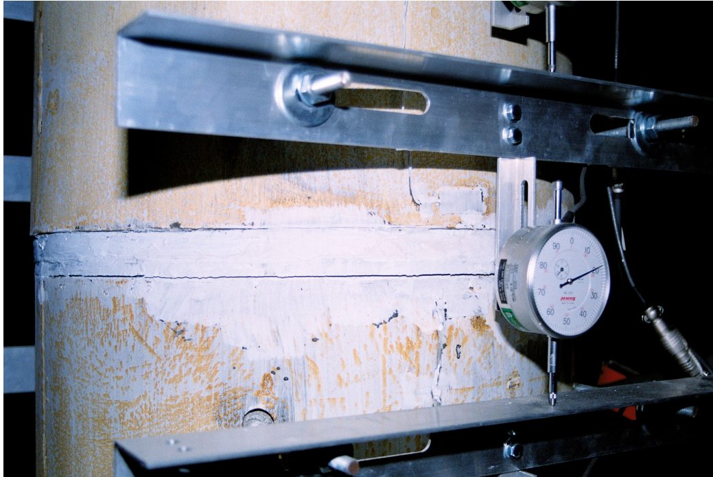
照片 3.5 第一、第二節塊間拉力側開始出現裂縫( \theta = -0.02 弧度)
