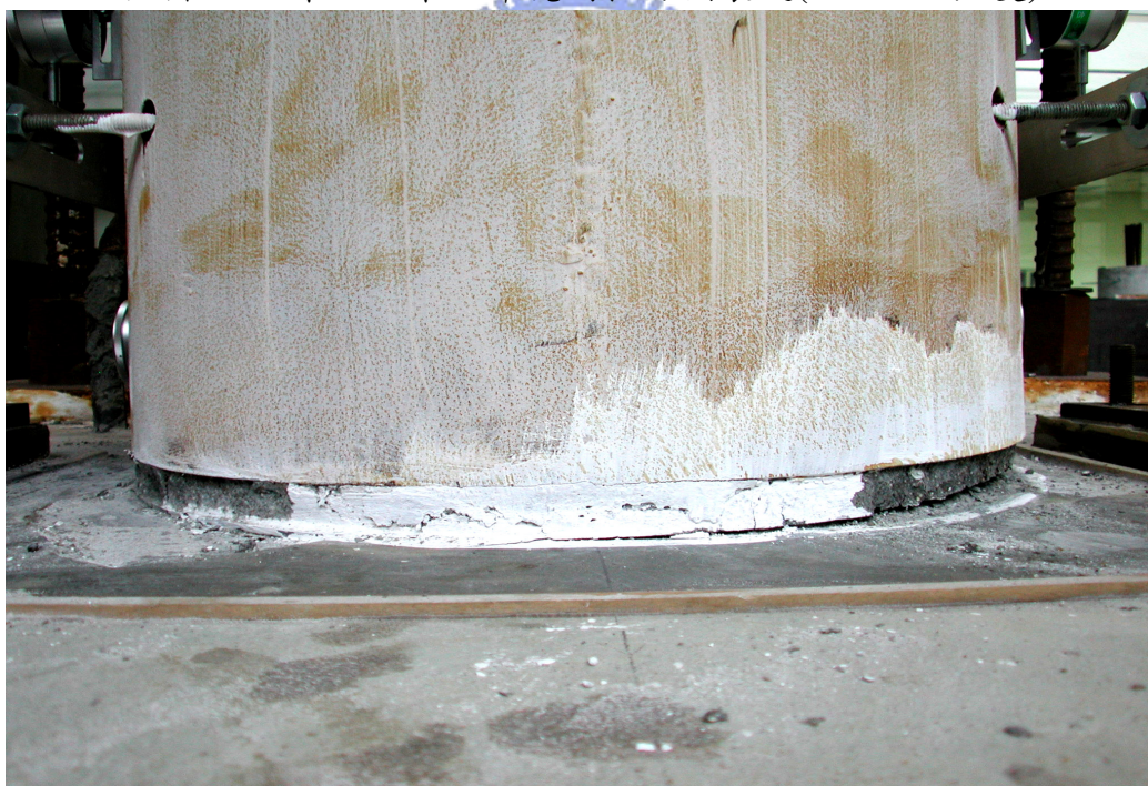
照片 3.24 第一節底部裂縫( \theta = -0.03 弧度)
