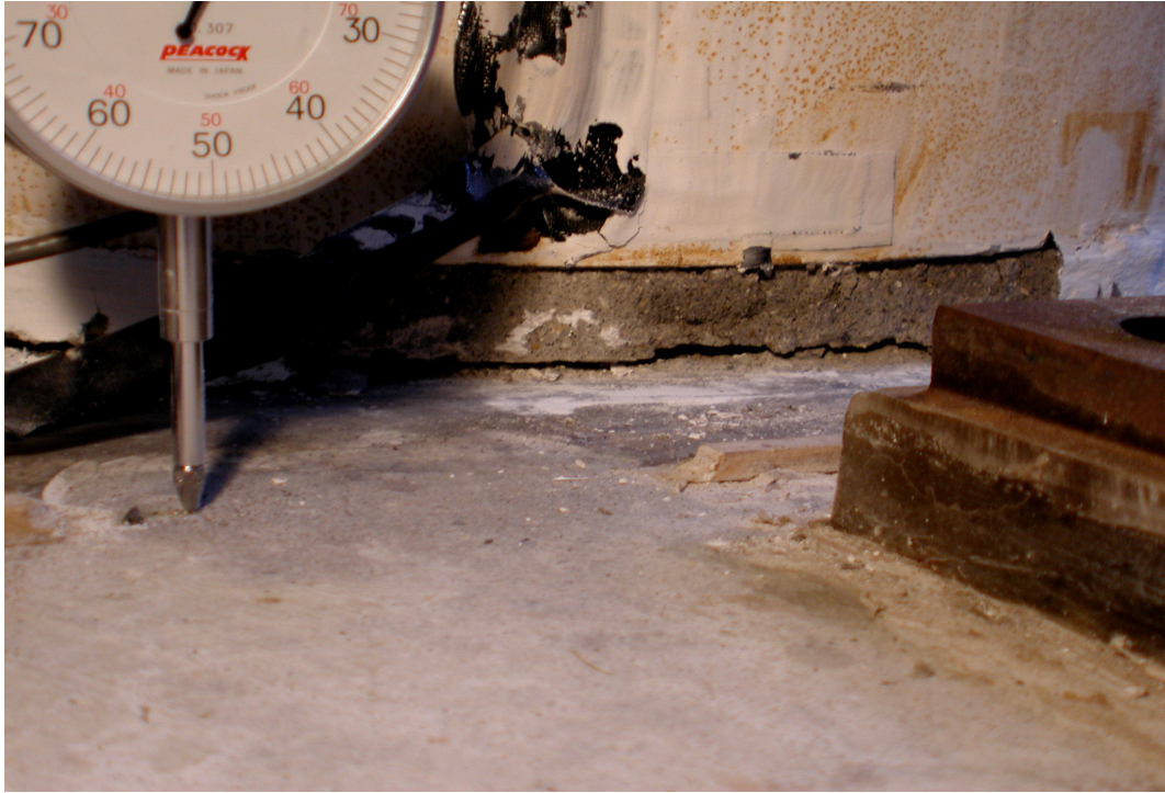
照片 3.19 第一節底部裂縫( \theta = +0.015 弧度)
