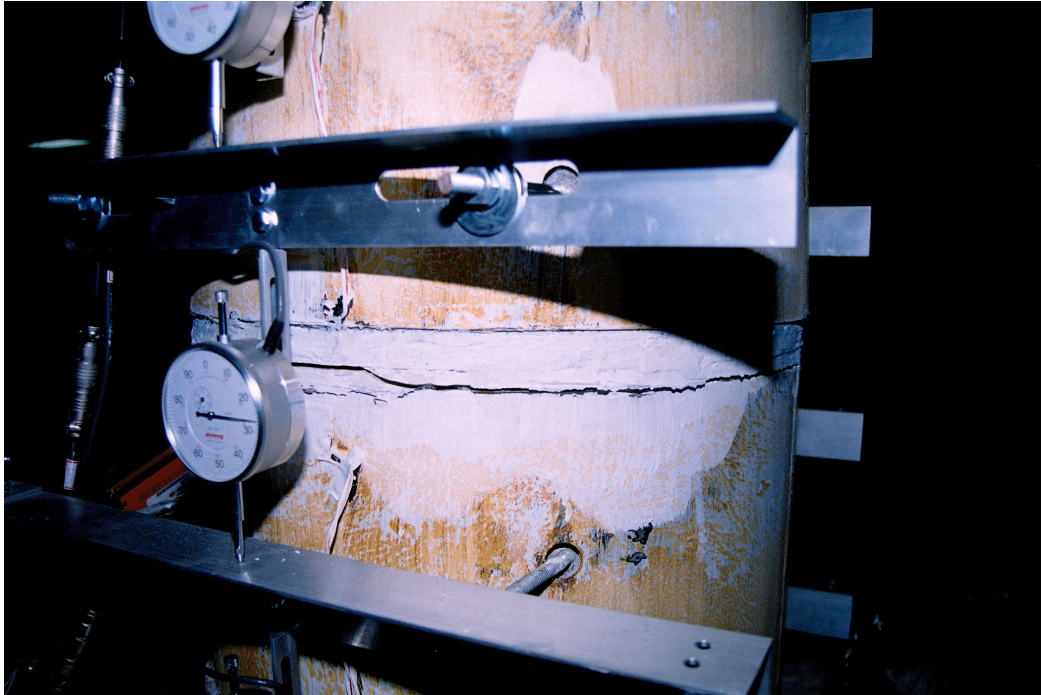
照片 3.9 第一、第二節塊間裂縫情形( \theta = +0.06 弧度)
