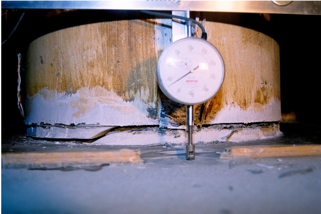
照片 3.6 些許混凝土由套管內剝落( \theta = -0.03 弧度)
