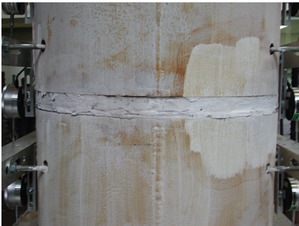
照片 3.31 第一、第二節塊間拉力側裂縫( \theta = -0.05 弧度)
