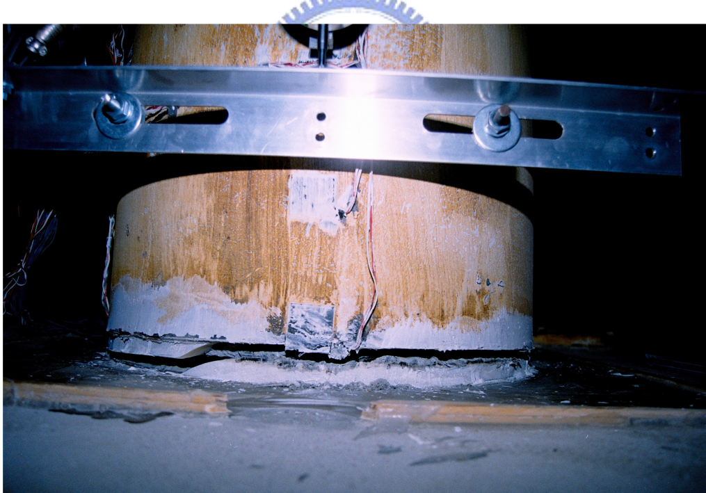
照片 3.8 第一節塊底部裂縫( \theta = +0.06 弧度)
