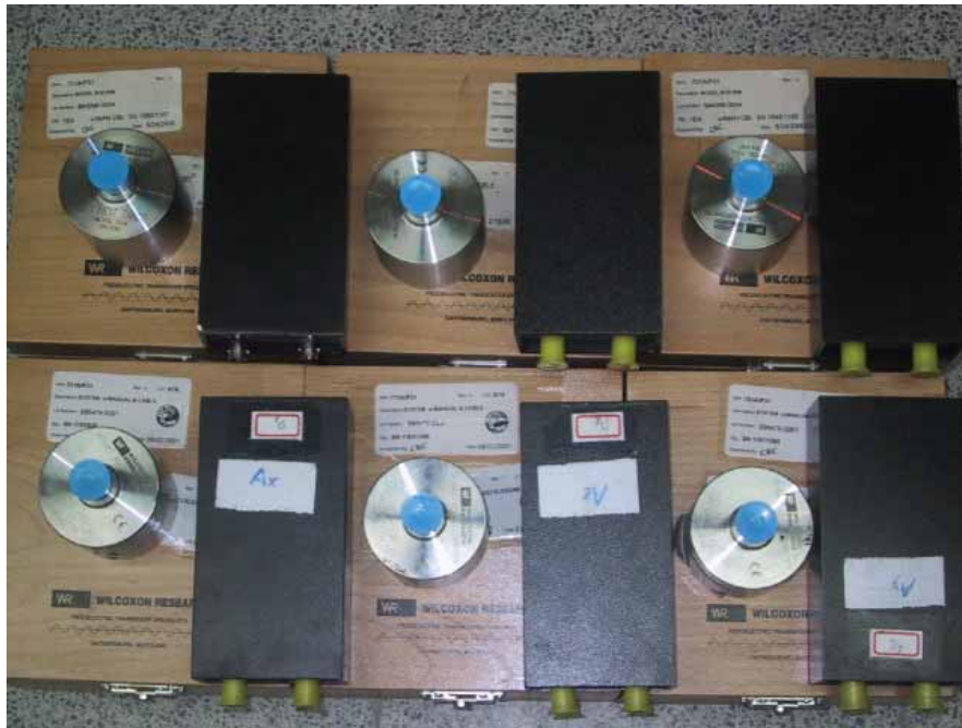
圖 3.11 微振加速規及訊號調節放大器
