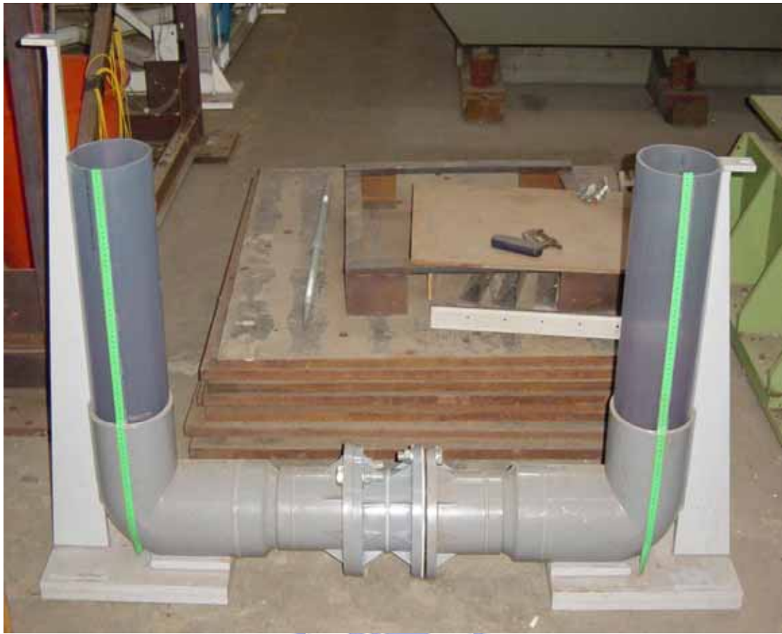
圖 3.1 變斷面 VTLCD 實體照片 ( d=0.95\text{m} )
