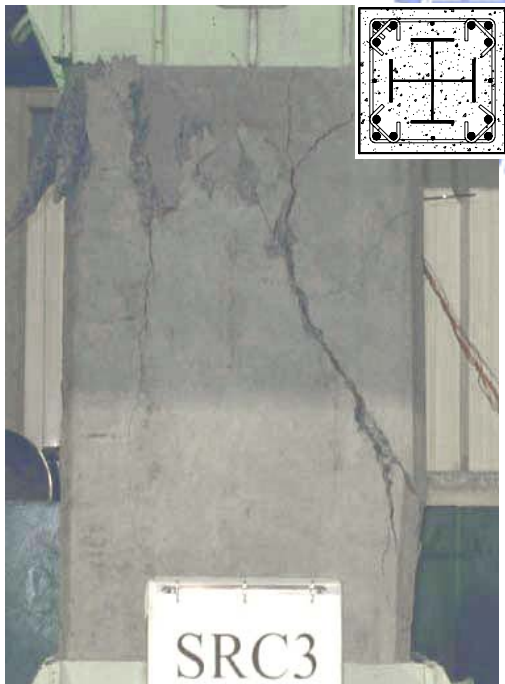
(c) 採用 Weng's Formula 設計 (箍筋間距 90 mm)
