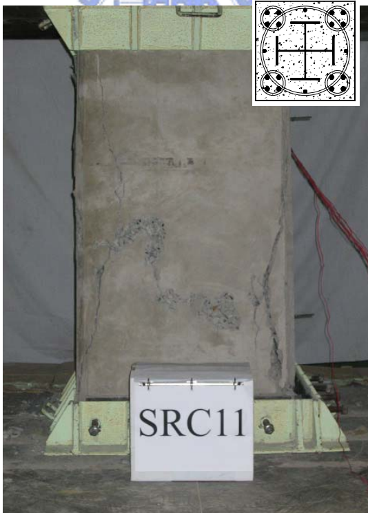
(b) 採用 ACI 318 Code 設計 ( 箍筋間距 60 mm )
