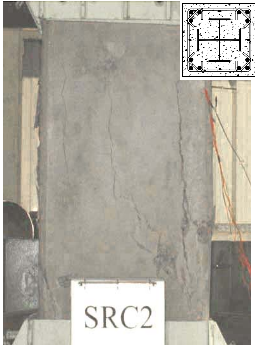
(a) 採用 Taiwan SRC Code 設計 (箍筋間距 75 mm)
