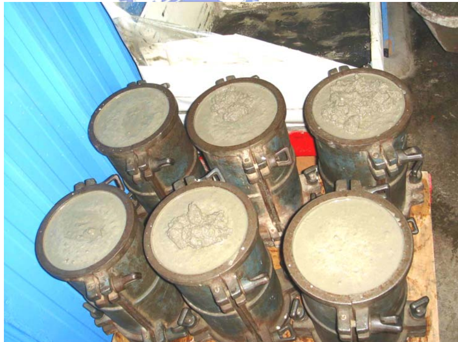
照片 3.3 在 SRC 柱試體灌漿時同時製作 150 \times 300 \text{ mm} 的標準混凝土圓柱試體
