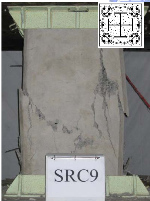
(c) 採用 Taiwan SRC Code 設計 (箍筋間距 95 mm)
