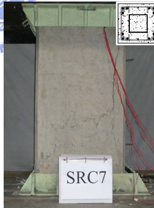
(d) 採用 Weng's Formula 設計 (箍筋間距 90 mm)
