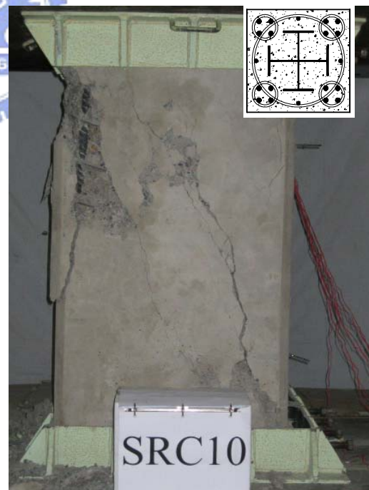
(d) 採用 Weng's Formula 設計 (箍筋間距 115 mm)
