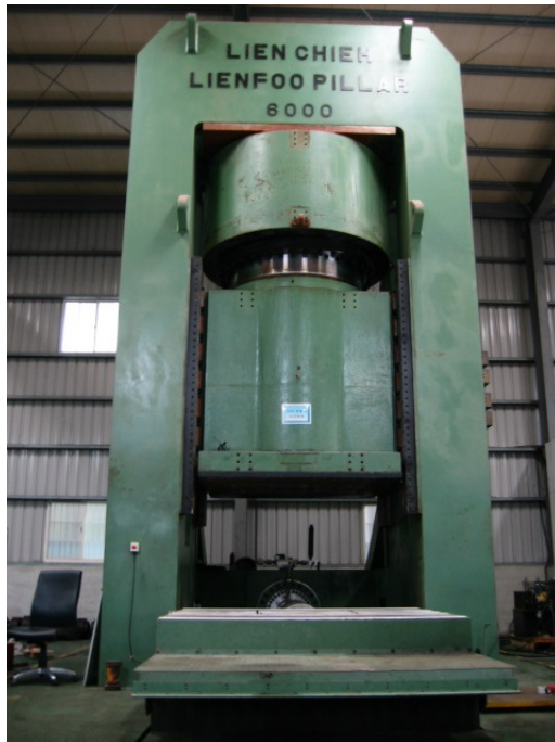
(a) 58800 kN 萬能試驗機
