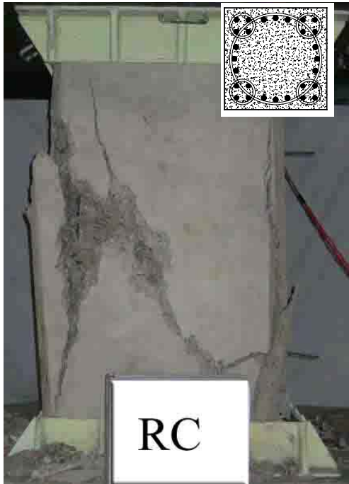
(a) 採用 ACI-318 Code 設計 (箍筋間距 75 mm)
