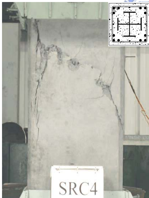
(b) 採用 Taiwan SRC Code 設計 (箍筋間距 75 mm)
