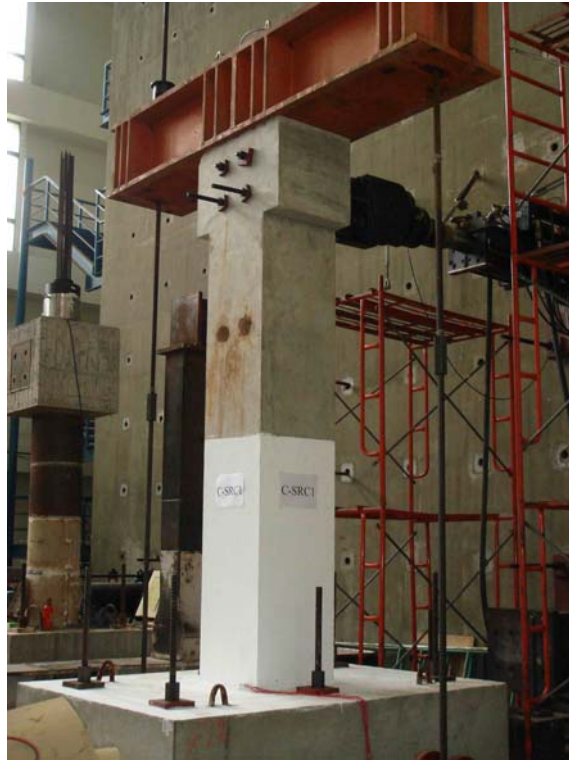
照片 4.3 本研究 SRC 柱反覆載重試驗配置
