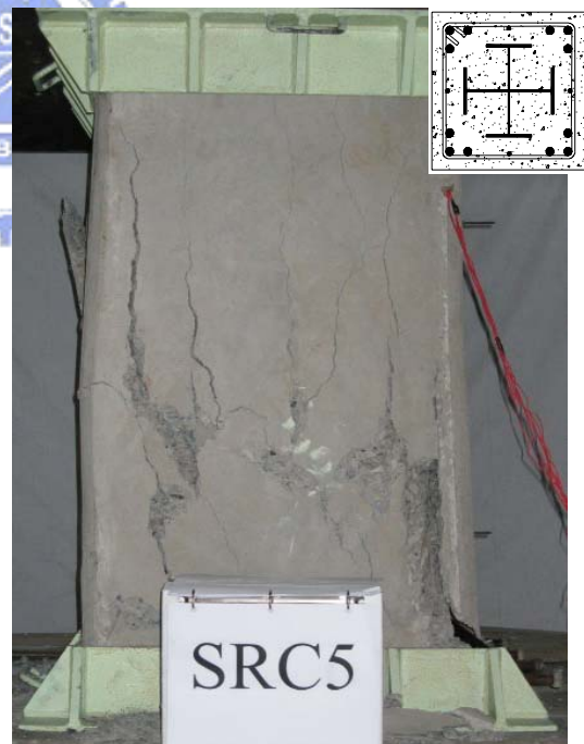
(c) 採用 Weng's Formula 設計 (箍筋間距 90 mm)
