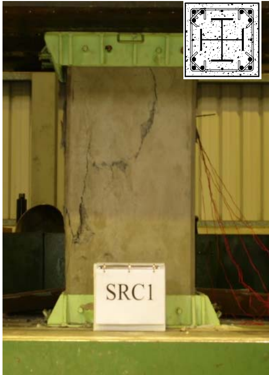
(a) 採用 ACI 318 Code 設計 ( 箍筋間距 60 mm )
