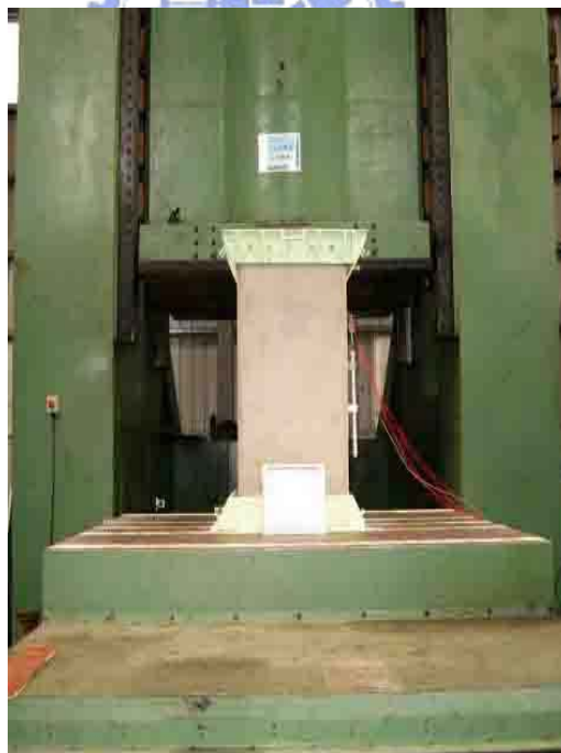
(b) 試體架設於試驗機平台上之情形
