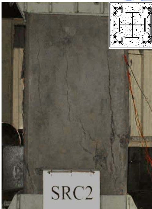
(c) 採用 Taiwan SRC Code 設計 (箍筋間距 75 mm)
