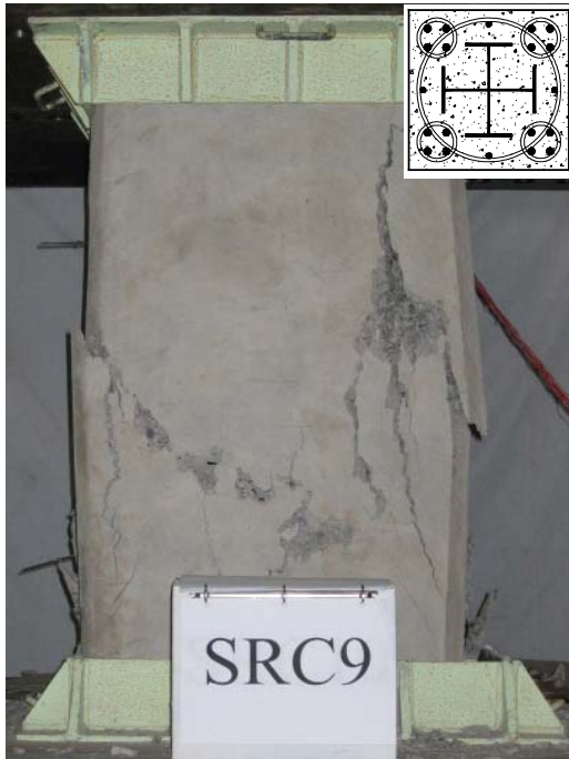
(a) 採用 Taiwan SRC Code 設計 (箍筋間距 95 mm)
