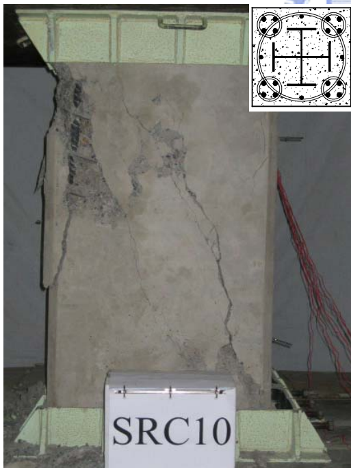
(c) 採用 Weng's Formula 設計 (箍筋間距 115 mm)
