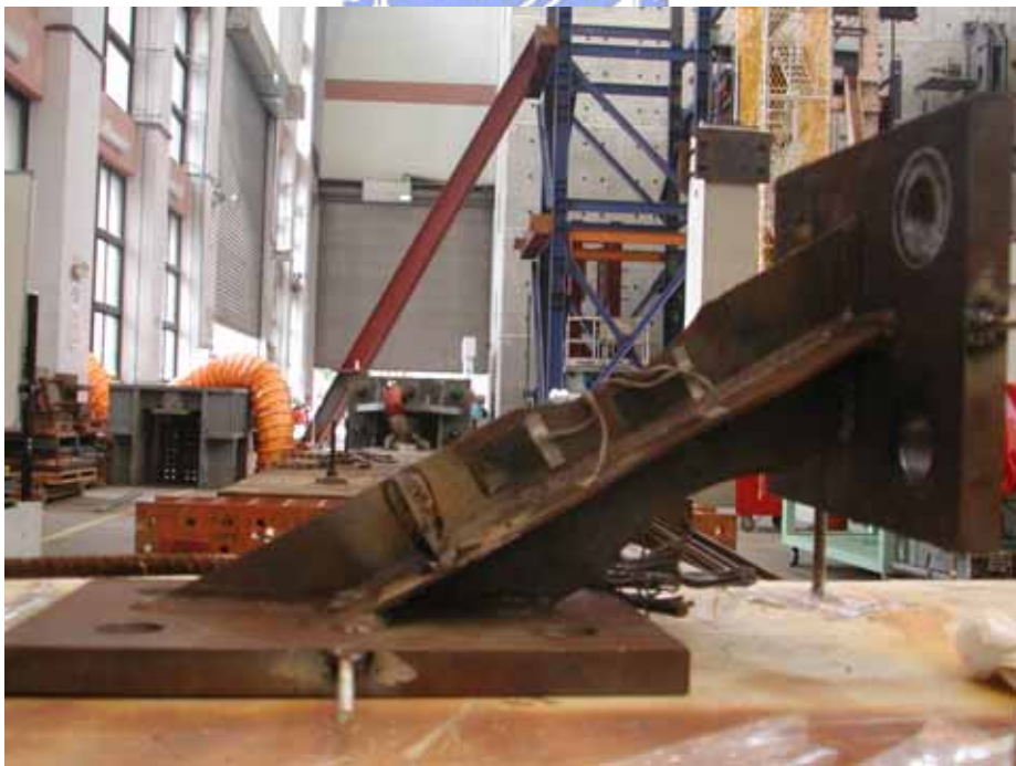
照片 3.14 試體 3 十字型鋼板消能器
