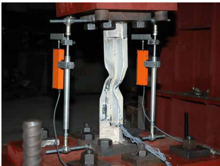
照片 3.25 試體 CSED 削切處扭轉挫屈 (壓縮 4.5 mm)
