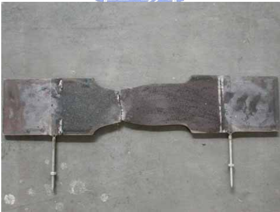
照片 3.44 試體 BRED-6 裂情形
