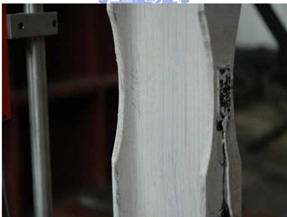
照片 3.28 試體 HSED 於腹板翼板交接處產生降伏 (拉伸 2.4 mm)
