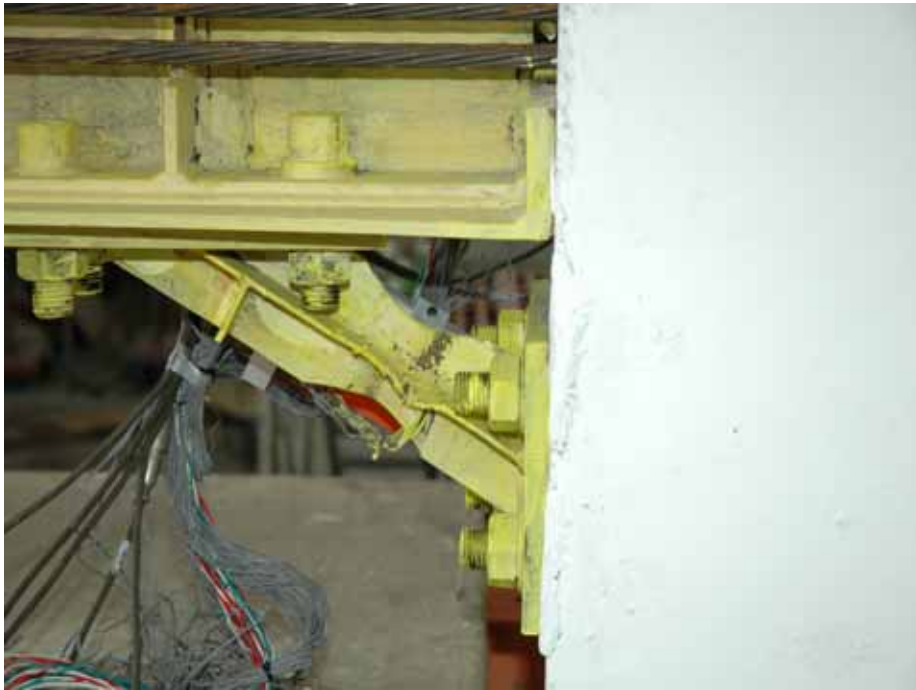
照片 3.17 試體 3 十字型鋼板消能器最窄削切處挫屈( \theta = 0.015 \text{ rad} )
