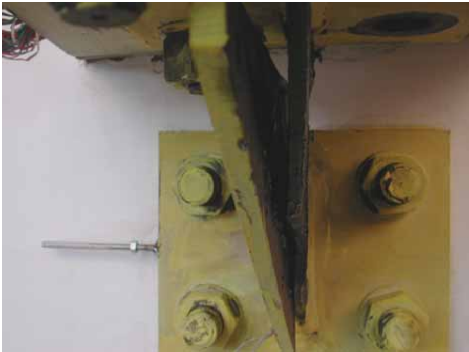
照片 3.9 試體 1 消能鋼板產生高模態挫屈( \theta = 0.03 rad)
