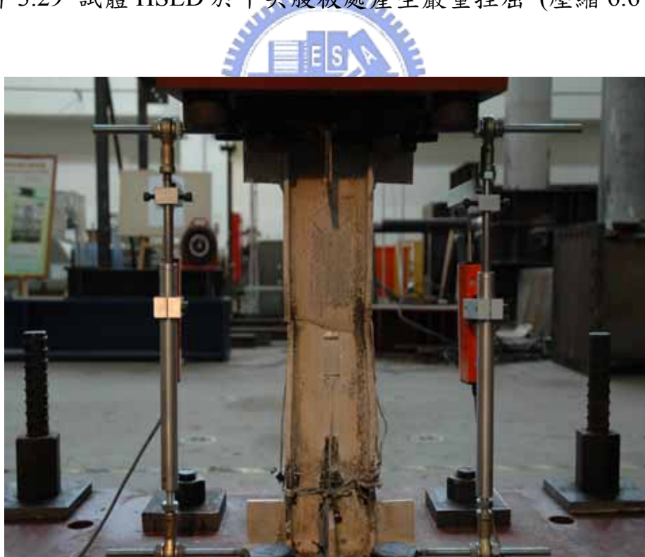
照片 3.30 試體 HSED 於削切處產生斷裂(拉伸 12 mm)
