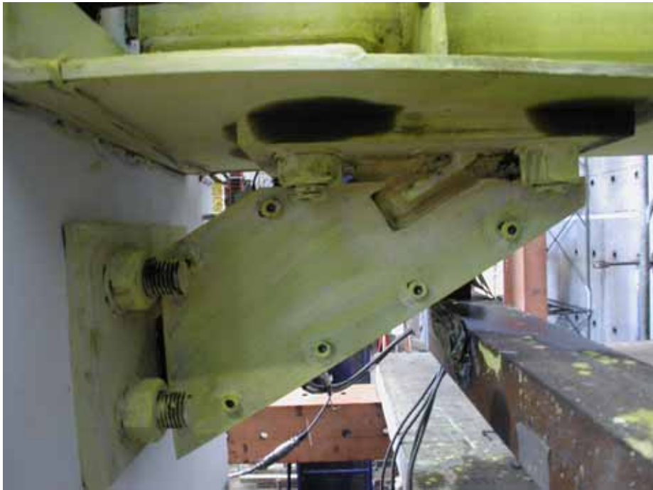
照片 3.11 試體 2 挫屈束制鋼板消能器
