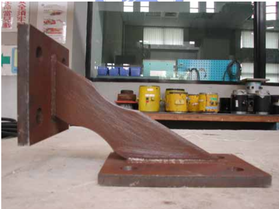
照片 3.2 試體 1 鋼板消能器之消能鋼板及底板
