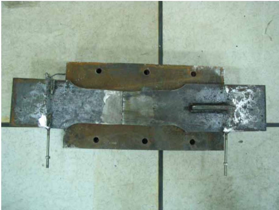
照片 3.43 試體 BRED-4 斷裂於消能鋼板中央位置
