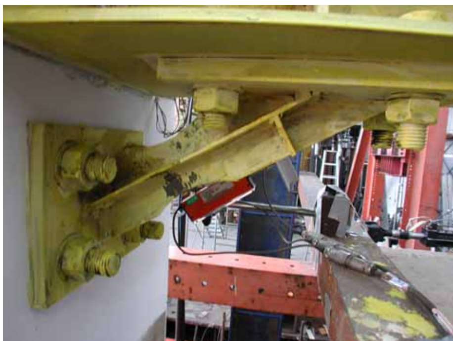
照片 3.15 試體 3 十字型鋼板消能器最窄削切處降伏( \theta = 0.0075 rad)
