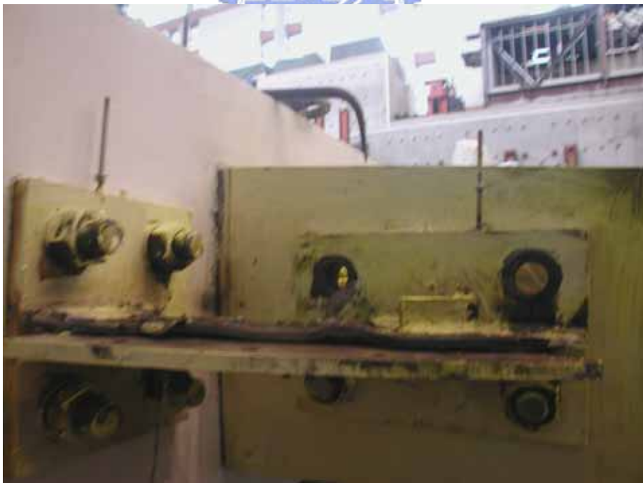
照片 3.12 試體 2 消能鋼板高模態挫屈
