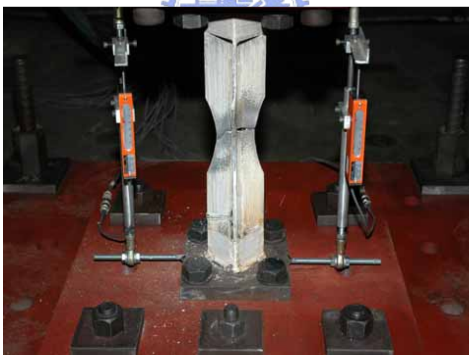
照片 3.26 試體 CSED 削切處斷裂 (拉伸 12 mm)
