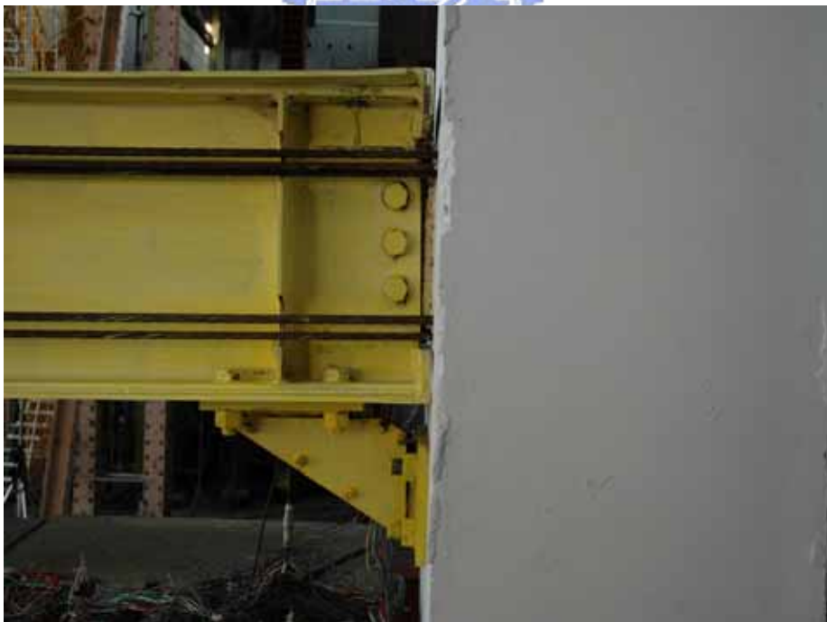
照片 3.6 試體 1 梁柱分離情形( \theta = 0.015 \text{ rad} )
