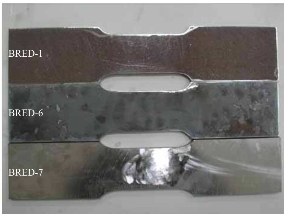
照片 3.31 挫屈束制消能鋼板
