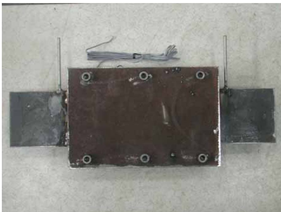
照片 3.33 挫屈束制鋼板消能器組裝完成
