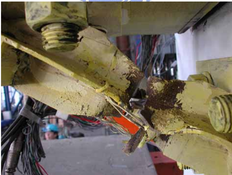
照片 3.20 試體 3 十字型鋼板消能器最窄削切處斷裂破壞( \theta = 0.03 rad)
