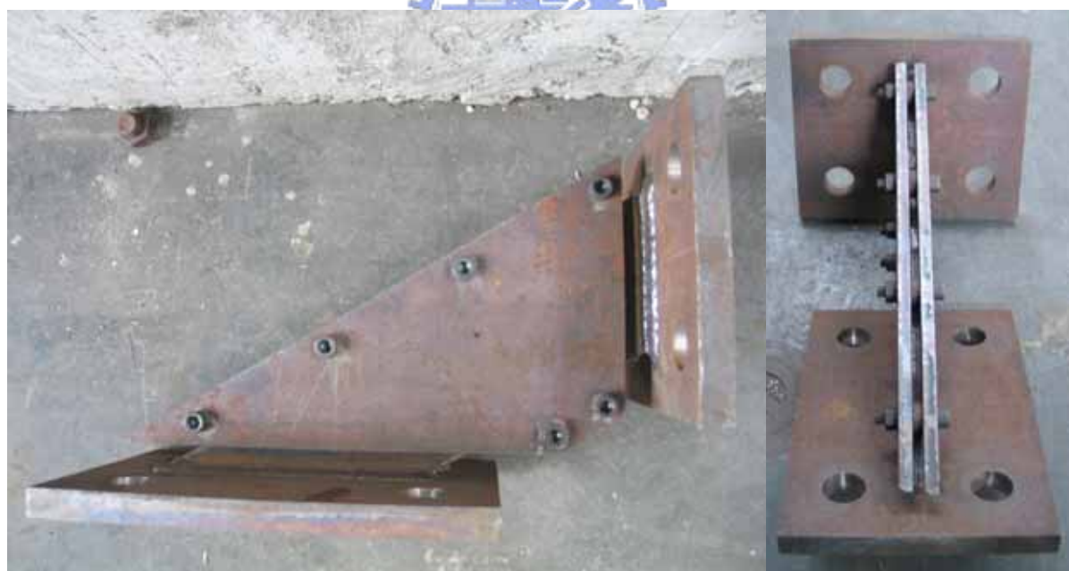
照片 3.4 試體 1 挫屈束制鋼板消能器
