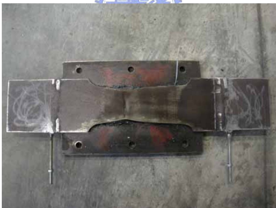
照片 3.36 試體 BRED-1 斷裂情形
