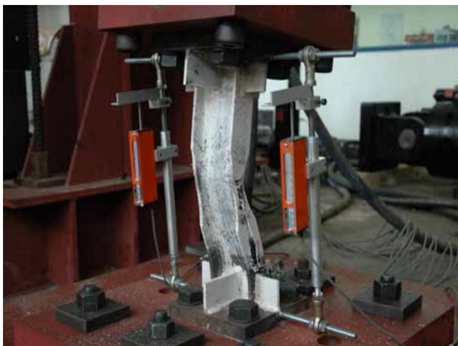
照片 3.29 試體 HSED 於中央腹板處產生嚴重挫屈 (壓縮 6.6 mm)
