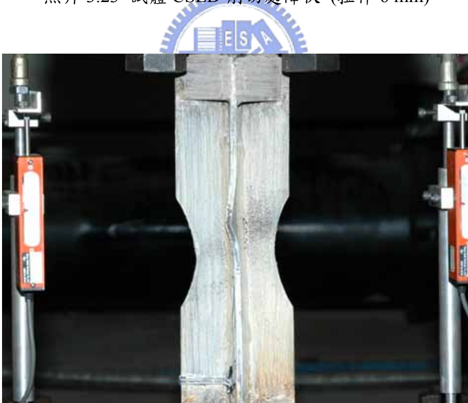
照片 3.24 試體 CSED 削切處挫屈 (壓縮 1.67 mm)
