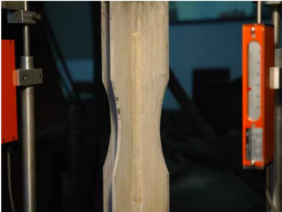
照片 3.23 試體 CSED 削切處降伏 (拉伸 6 mm)
