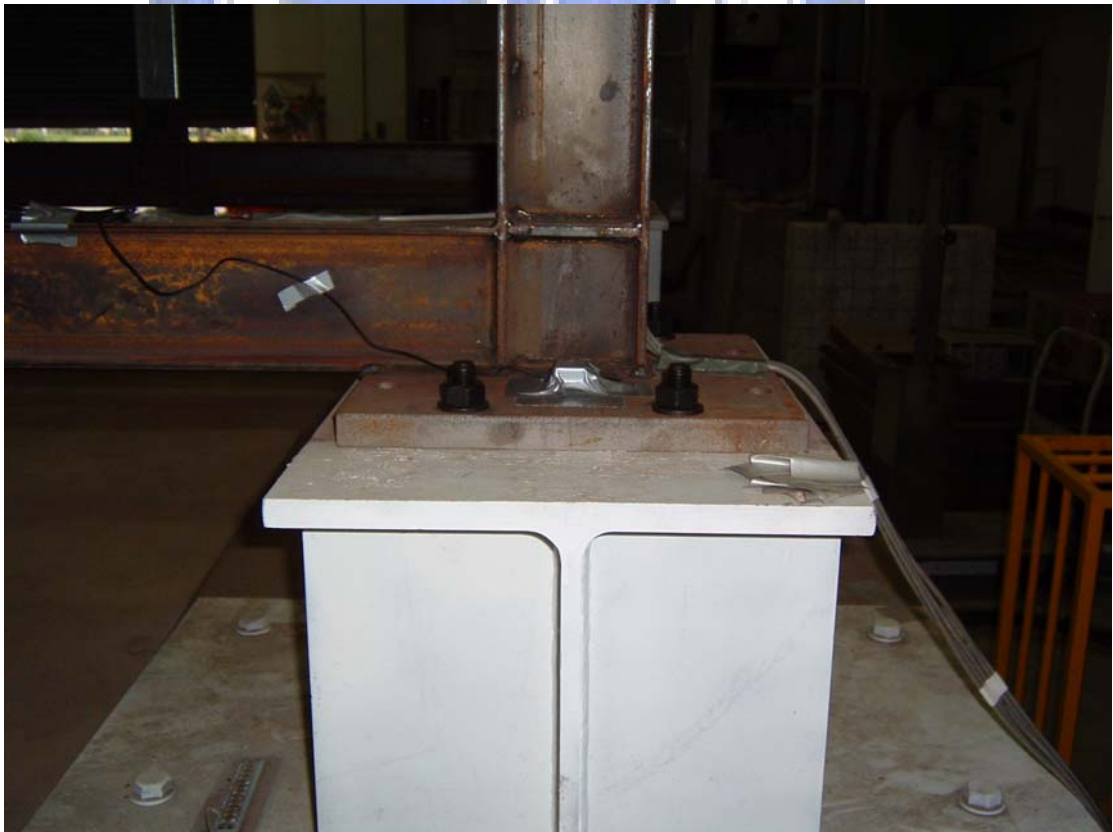
圖4-16 為四層樓鋼構架基座照片
