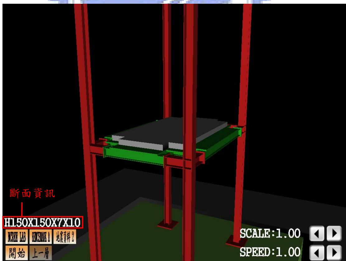
圖5-10 範例一：當滑鼠碰到結構物柱時，左下方會出現柱斷面資訊
