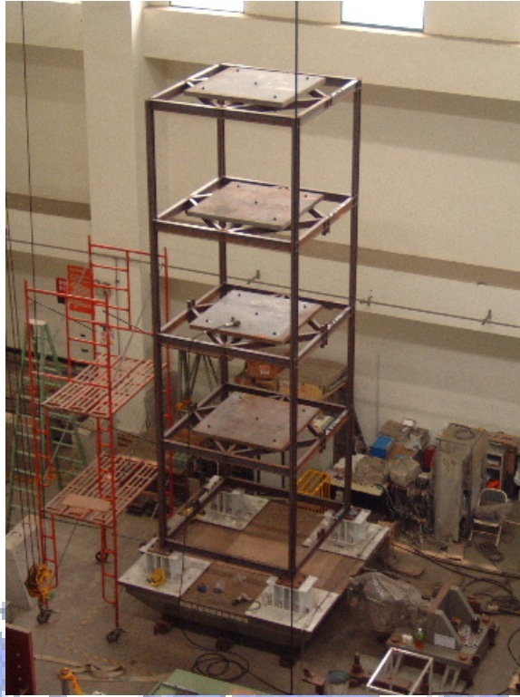
圖2-6 四層樓鋼構架實際照片
