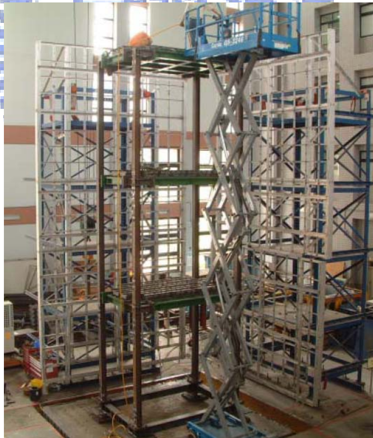
圖2-2 Benchmark A 震動台測試照片
