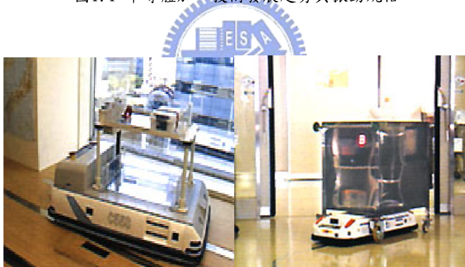
圖2.1 不同無人搬運車種類 (左圖最大速度60 m/min)(右圖最大速度40 m/min)
