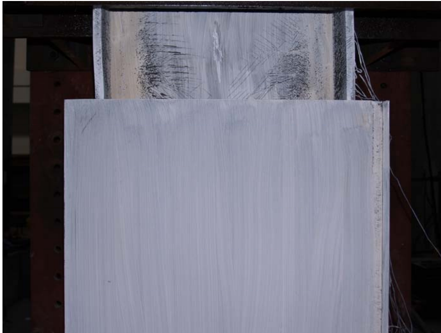
照片 5.12 試體二 BS600 梁上翼板發生同方向之挫屈現象 (3% drift)
