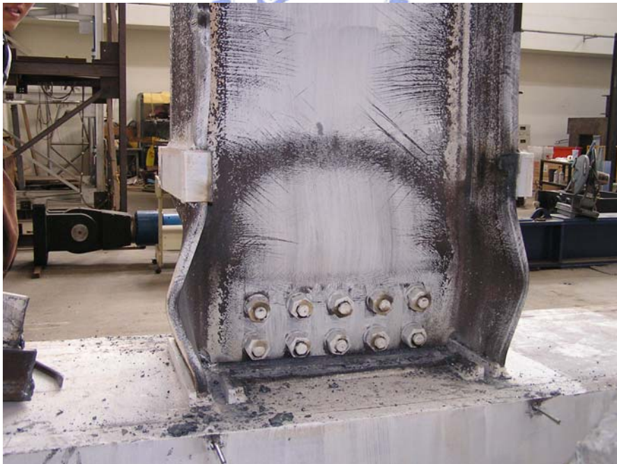
照片 5.21 試體三 CM400 協力桿件與加勁板移除之破壞現象 (5% drift)
