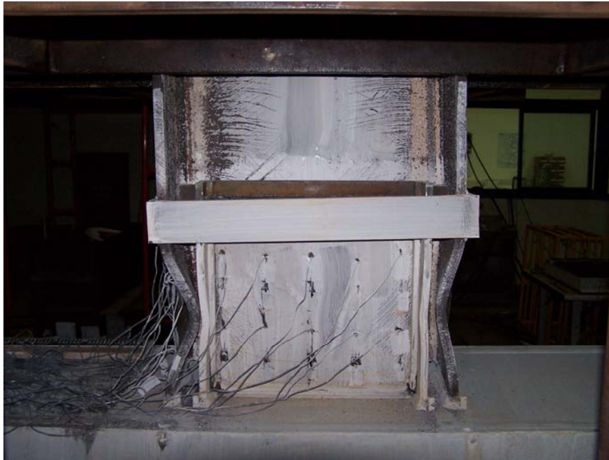
照片 5.20 試體三 CM400 協力桿件翼板因梁翼板挫屈而變形 (5% drift)
