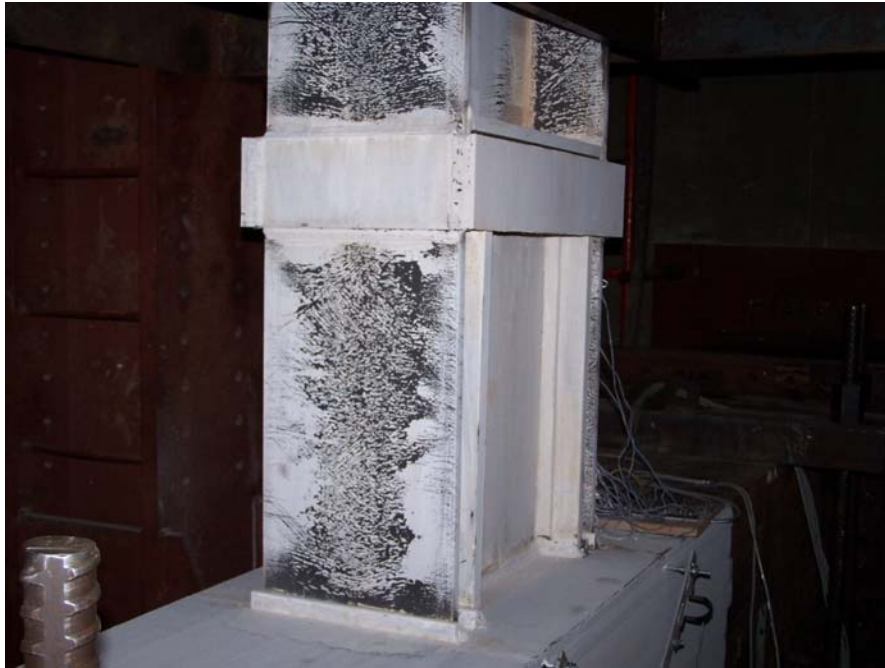
照片 5.6 試體一 CM600 支撐段兩側之梁翼板石灰剝落亦逐漸擴張 (3% drift)
