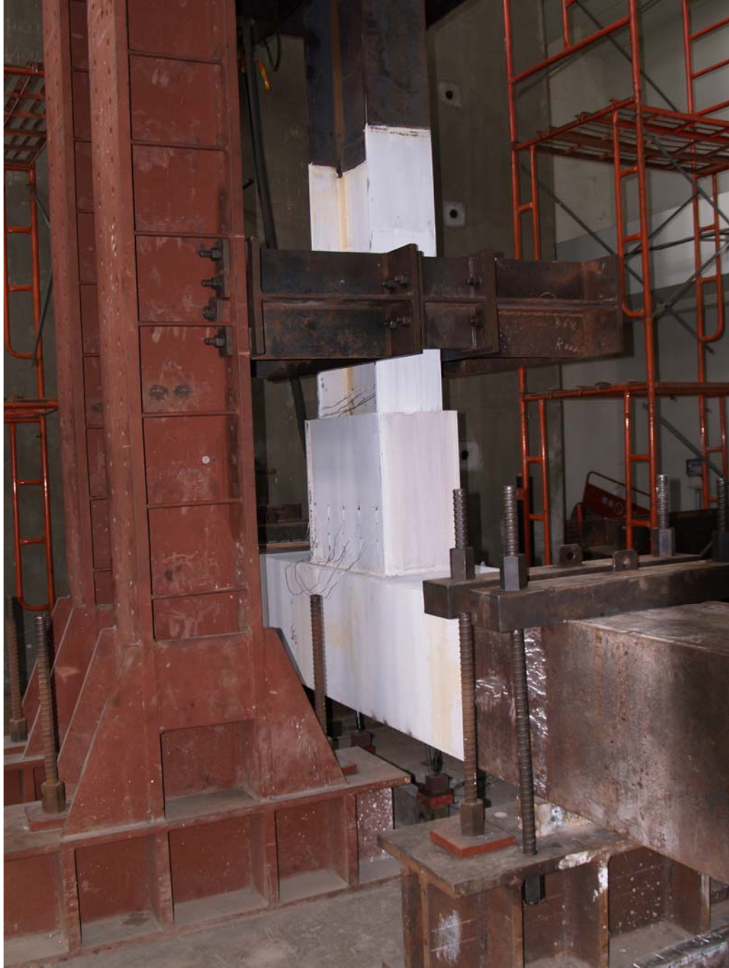
照片 5.9 試體二 BS600 試體實驗設置
