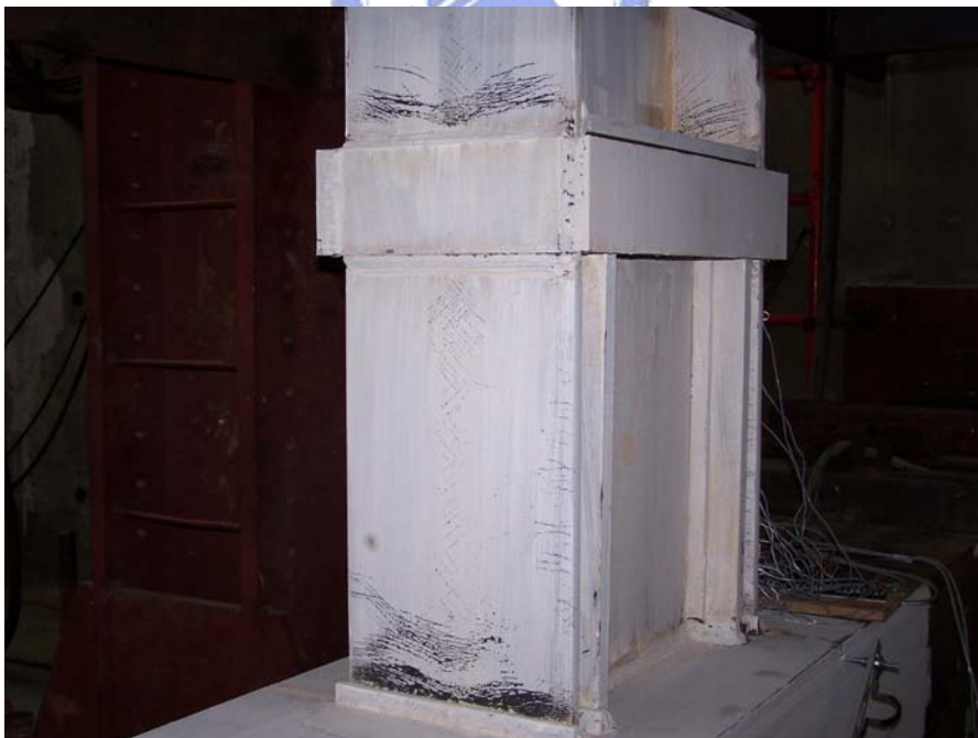
照片 5.3 試體一 CM600 於梁翼全滲透鐸道及支撐處之梁翼板表面石灰明顯呈現放射狀剝落(1.5% drift)
