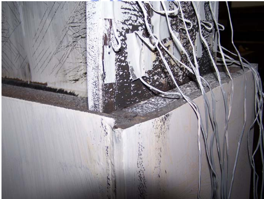
照片 5.13 試體二 BS600 箱型協力桿件上翼板於支撐塊處明顯變形(3% drift)
