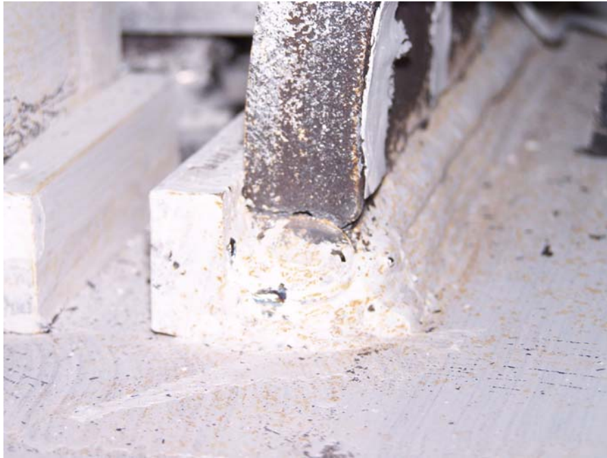
照片 5.18 試體三 CM400 梁上翼板之全滲透銲道起弧處之裂縫約 向內延伸 1 cm(4% drift)
