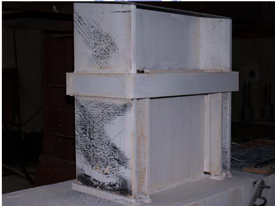
照片 5.17 試體三 CM400 支撐處兩側之石灰剝落持續增加 (2% drift)
