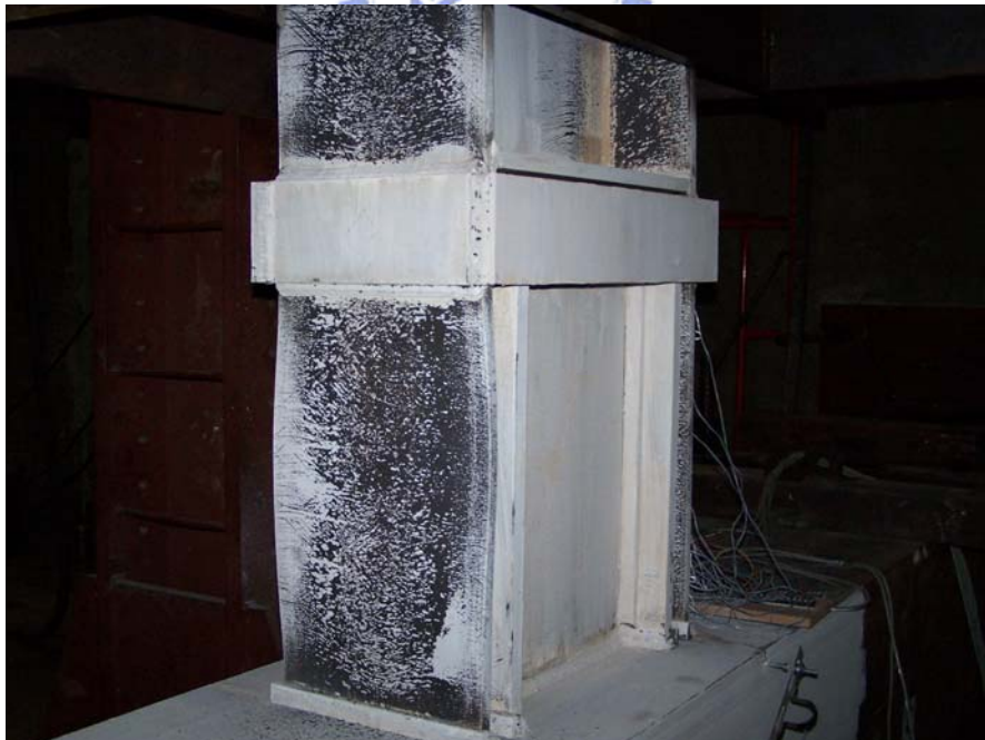
照片 5.7 試體一 CM600 梁下翼板支撐段內首先發生明顯的局部挫 屈(4% drift)
