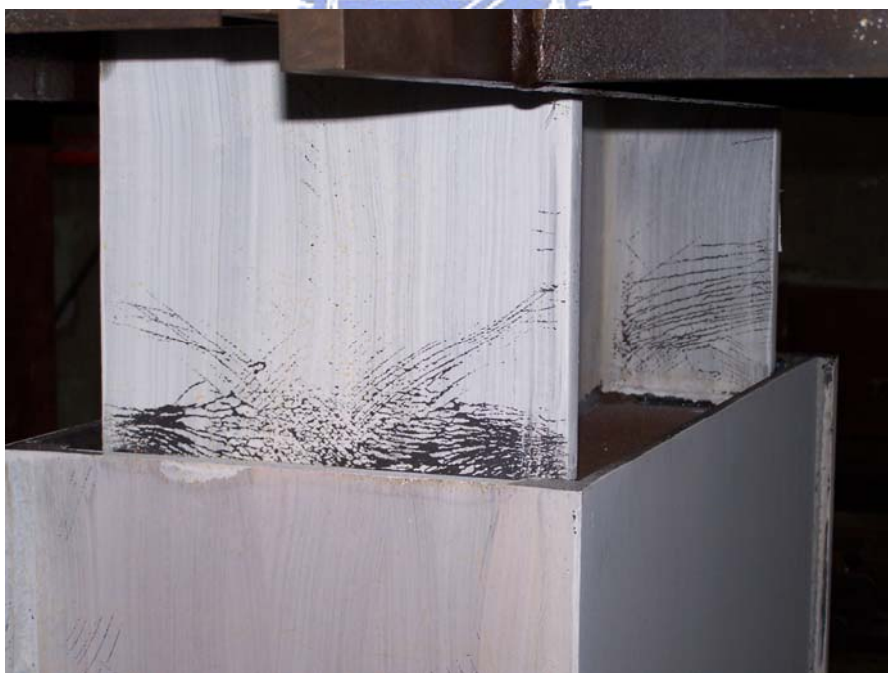
照片 5.11 試體二 BS600 梁翼板斜向斑紋增多且範圍向外延伸 (1.5% drift)
