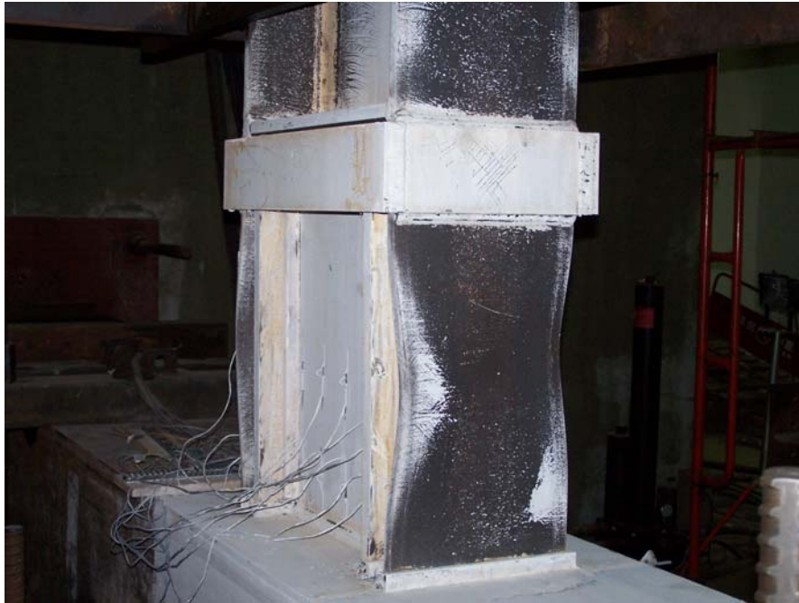
照片 5.8 試體一 CM600 挫屈現象(5% drift)
