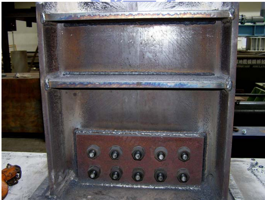
照片 5.15 試體二 BS600 梁腹板有 45 度之斜向斑紋產生(5% drift)
