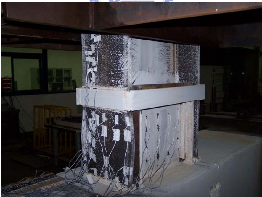
照片 5.19 試體三進入第二迴圈正方向，梁上翼板亦發生局部挫屈 (4% drift)
