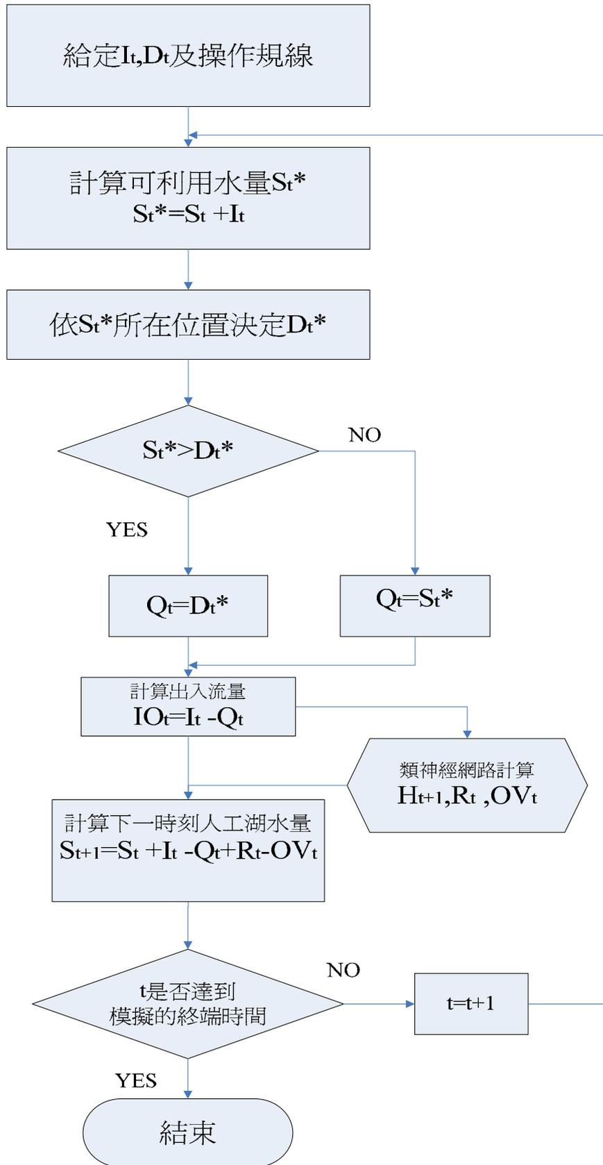
圖 5.5 高屏大湖聯合操作規劃模式模擬流程圖
