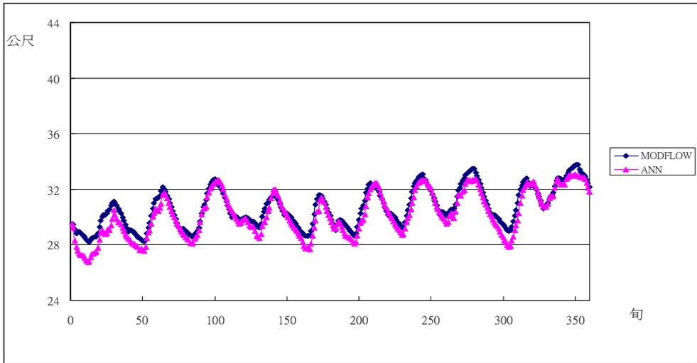
圖 6.65 案例 2-1(c)模擬 E 湖下游地下水位
