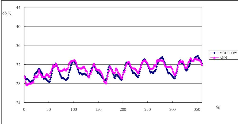
圖 6.49 案例 2-1(b)模擬 E 湖下游地下水位
