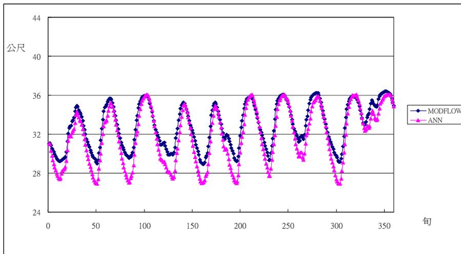
圖 6.29 案例 2-1(a)模擬 C 湖下游地下水位
