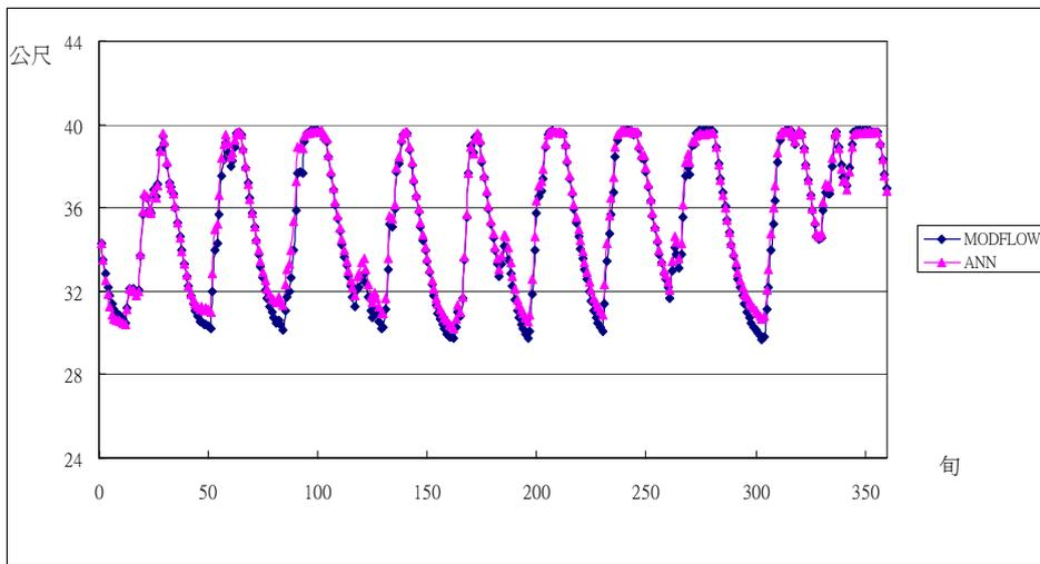
圖 6.44 案例 2-1(b)模擬 C 湖上游地下水位
