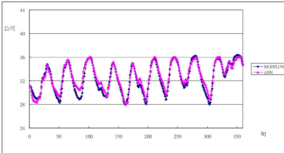
圖 6.45 案例 2-1(b)模擬 C 湖下游地下水位
