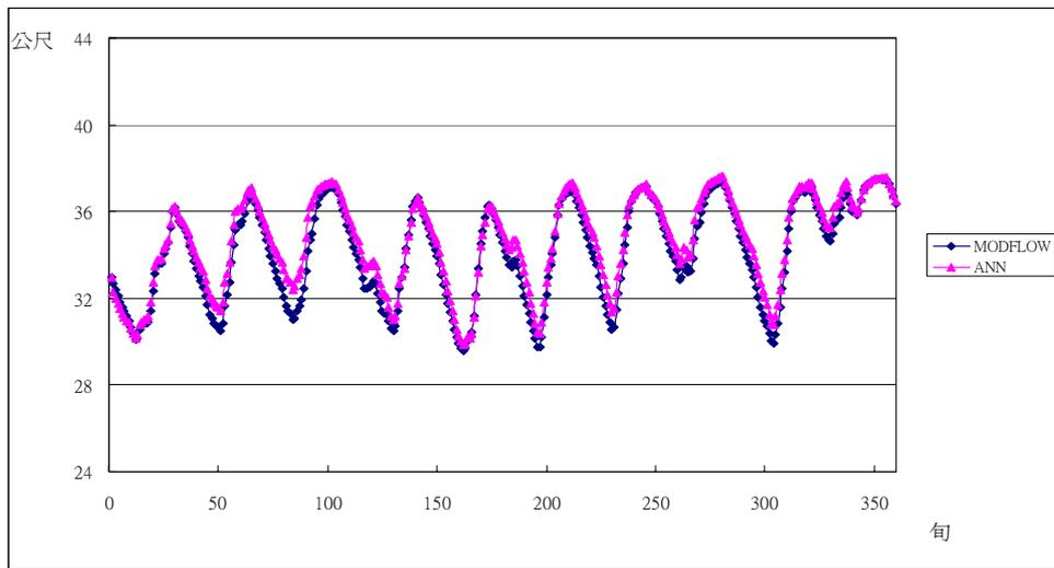
圖 6.41 案例 2-1(b)模擬 A 湖下游地下水位
