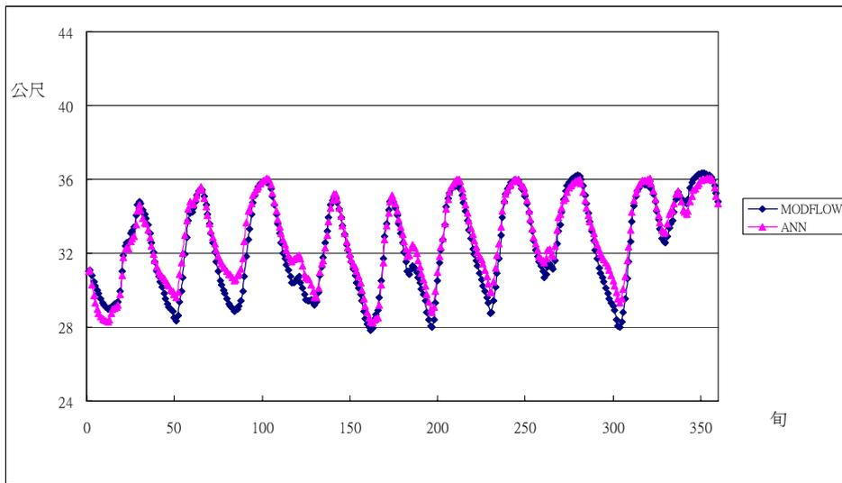
圖 6.77 案例 2-2 模擬 C 湖下游地下水位
