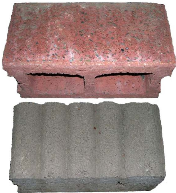
圖 2-3 結構物型式材料(上為岩面，下為深槽)
