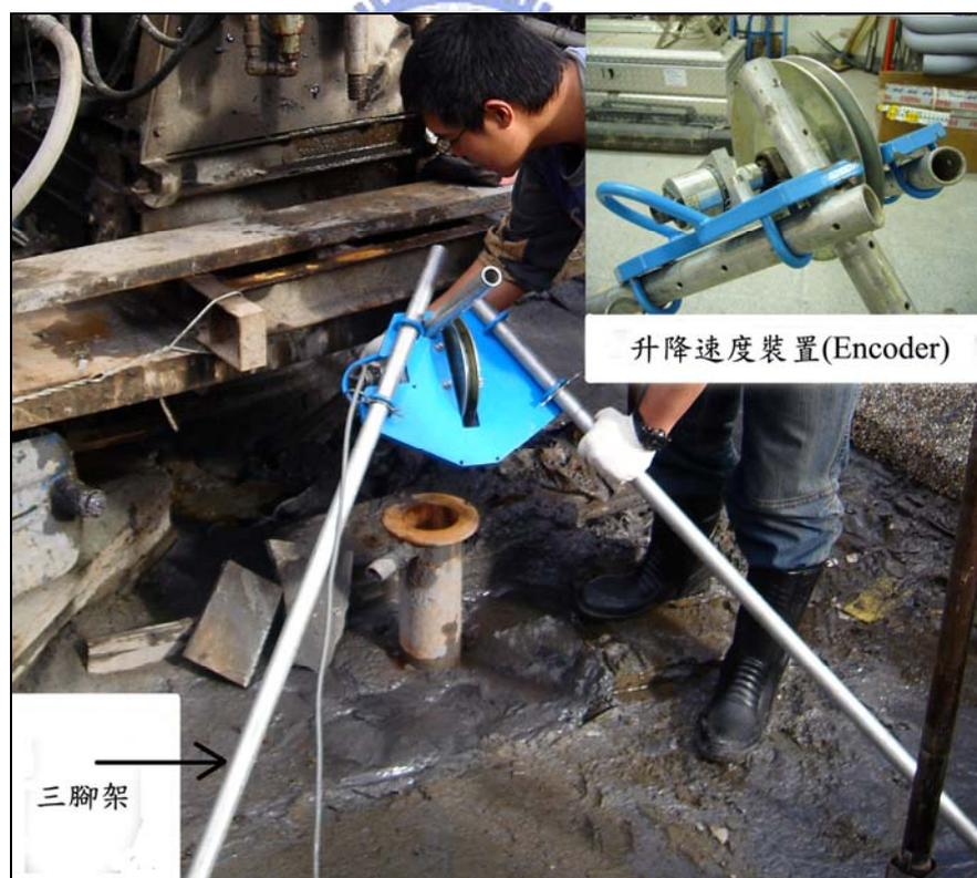
圖 3.15 三腳架與升降速度控制裝置(Encoder)
