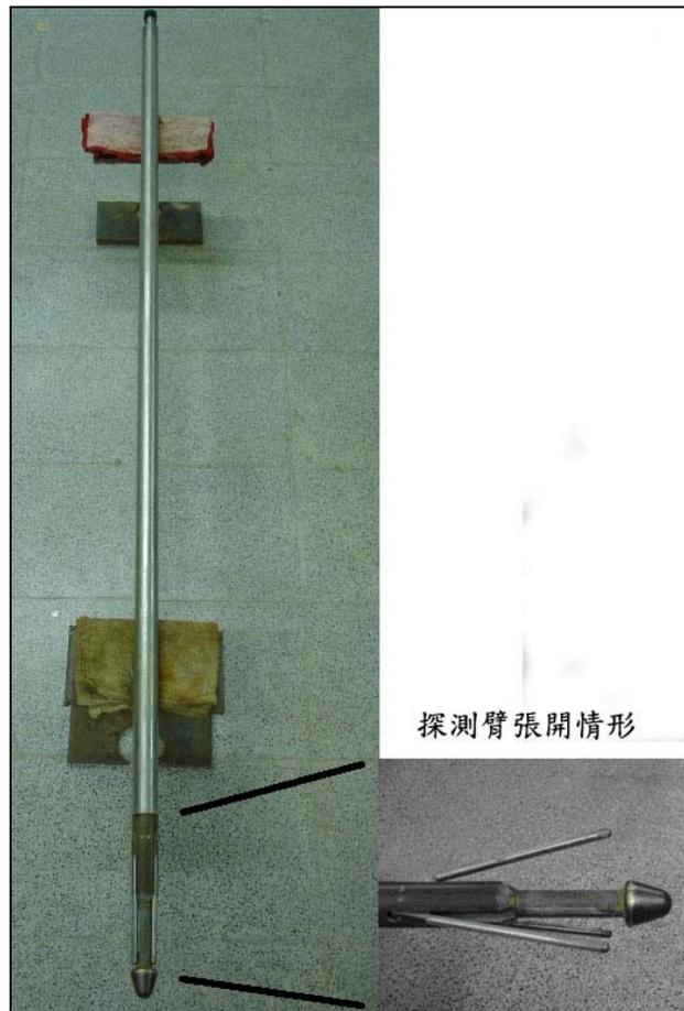
圖 3.14 三臂孔壁狀態探測器
