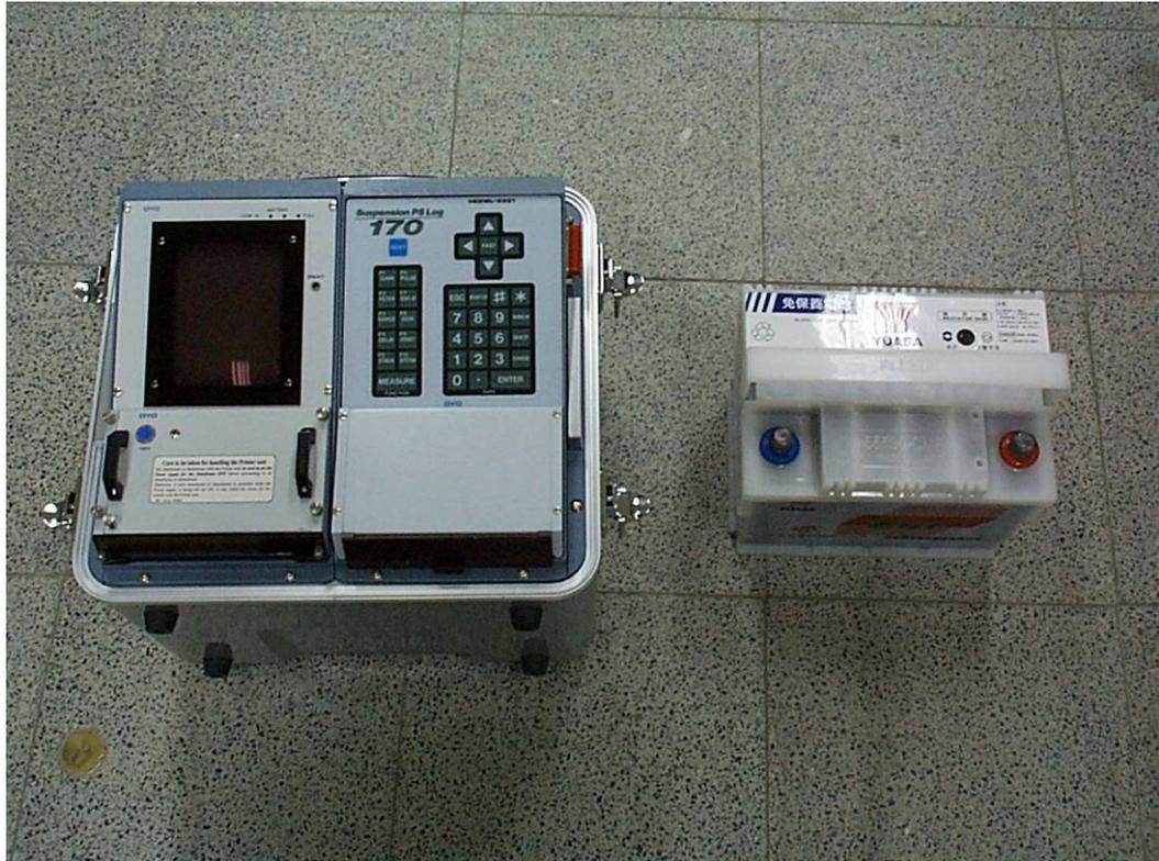
圖 3.27 控制及監測裝置(Suspension PS Log 170)(摘自林忠義，1999)
