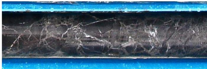
圖 4.2、第二類：破碎板岩岩體
