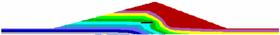
圖 4.10(b) 裂縫二長度比 0.4 時孔隙水壓分佈
