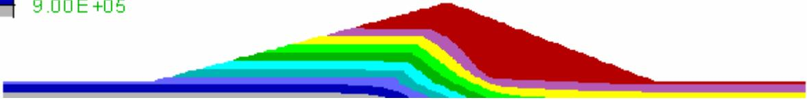
圖 4.7(a) 裂縫一長度比 0.00 時孔隙水壓分佈
