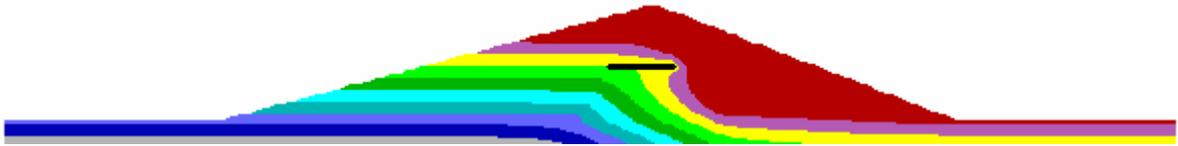
圖 4.7(c) 裂縫一長度比 0.71 時孔隙水壓分佈
