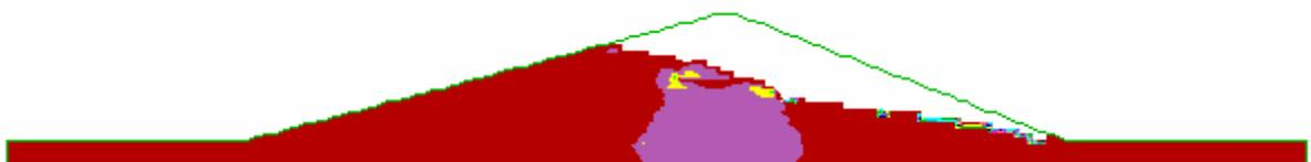
圖 4.8(d) 裂縫一長度比 1.00 時水力坡降分佈( $i_{\max}=1.00$  位於壩心內)
