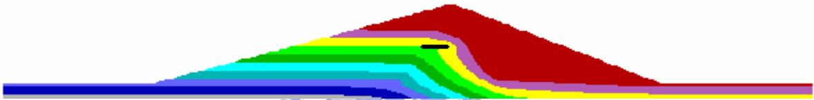
圖 4.7(b) 裂縫一長度比 0.43 時孔隙水壓分佈
