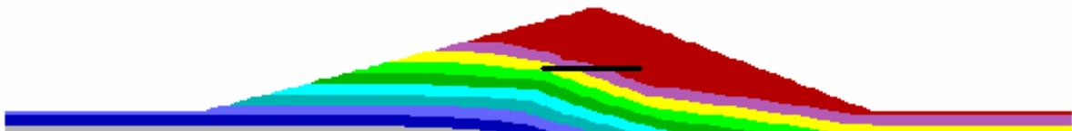
圖 4.7(d) 裂縫一長度比 1.00 時孔隙水壓分佈
