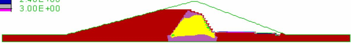
圖 4.11(a) 裂縫二長度比 0.0 時水力坡降分佈 ( $i_{\max}=0.98$  位於壩心內)
