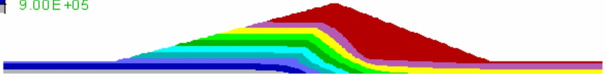
圖 4.10(a) 裂縫二長度比 0.0 時孔隙水壓分佈
