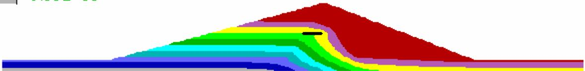
(a) 裂縫一長度比 0.43 時孔隙水壓分佈
