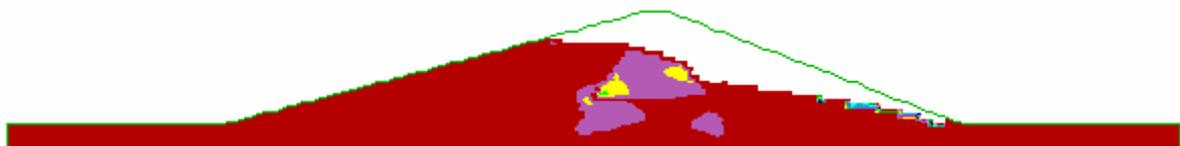
圖 4.11(d) 裂縫二長度比 1.0 時水力坡降分佈 ( $i_{\max}=1.12$  位於壩心內)
