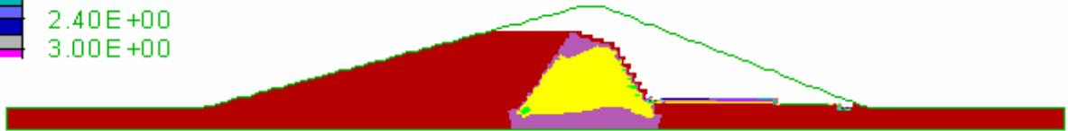
圖 4.8(a) 裂縫一長度比 0.00 時水力坡降分佈( $i_{\max}=0.98$  位於下游之壩心內)
