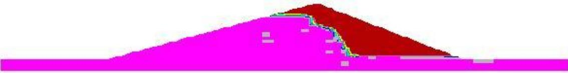
圖 4.19(b) 存在垂直裂縫面時之飽和度分佈 (裂縫面  $k/k_o=10$ )
