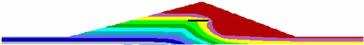
(b) 裂縫一長度比 0.71 時孔隙水壓分佈
