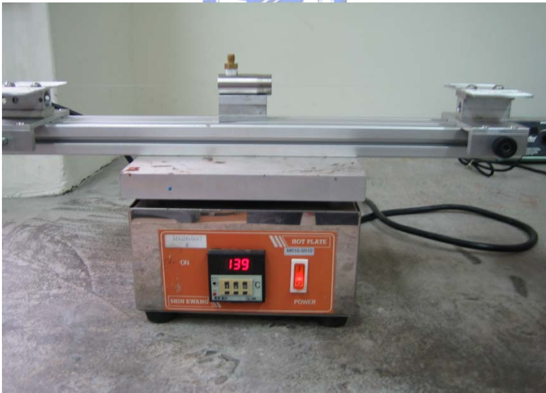
圖 4-5 拉伸式光纖光柵感測器的固定端上膠
