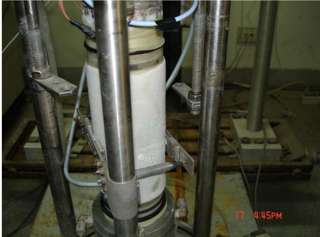
圖 3.14 非接觸式位移計之架設
