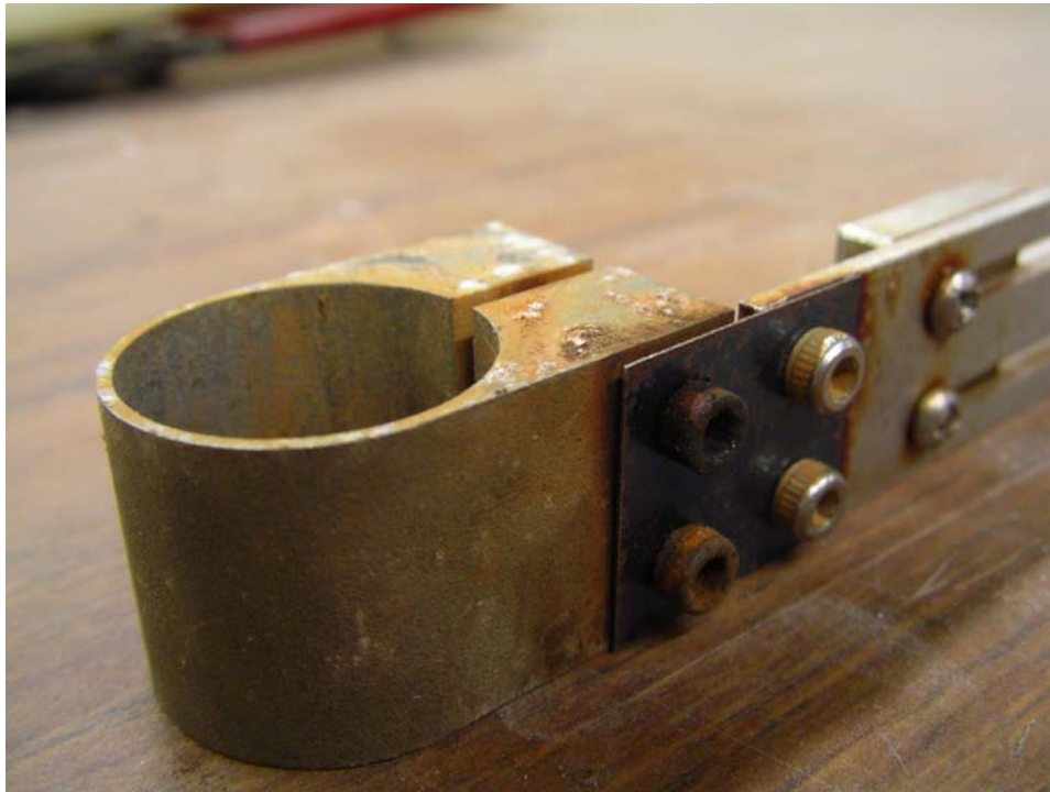
圖 3.16 標的物與夾具間以極薄之彈簧鋼片連結
