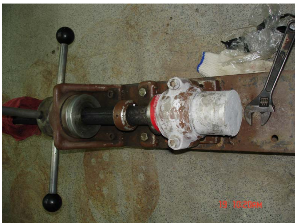
圖 3.11 將冰凍試體從薄管內推出
