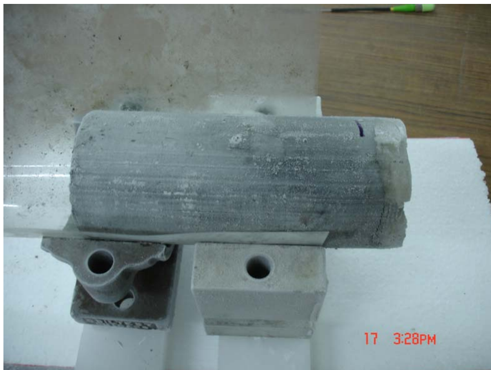
圖 3.12 從薄管推出之冰凍試體
