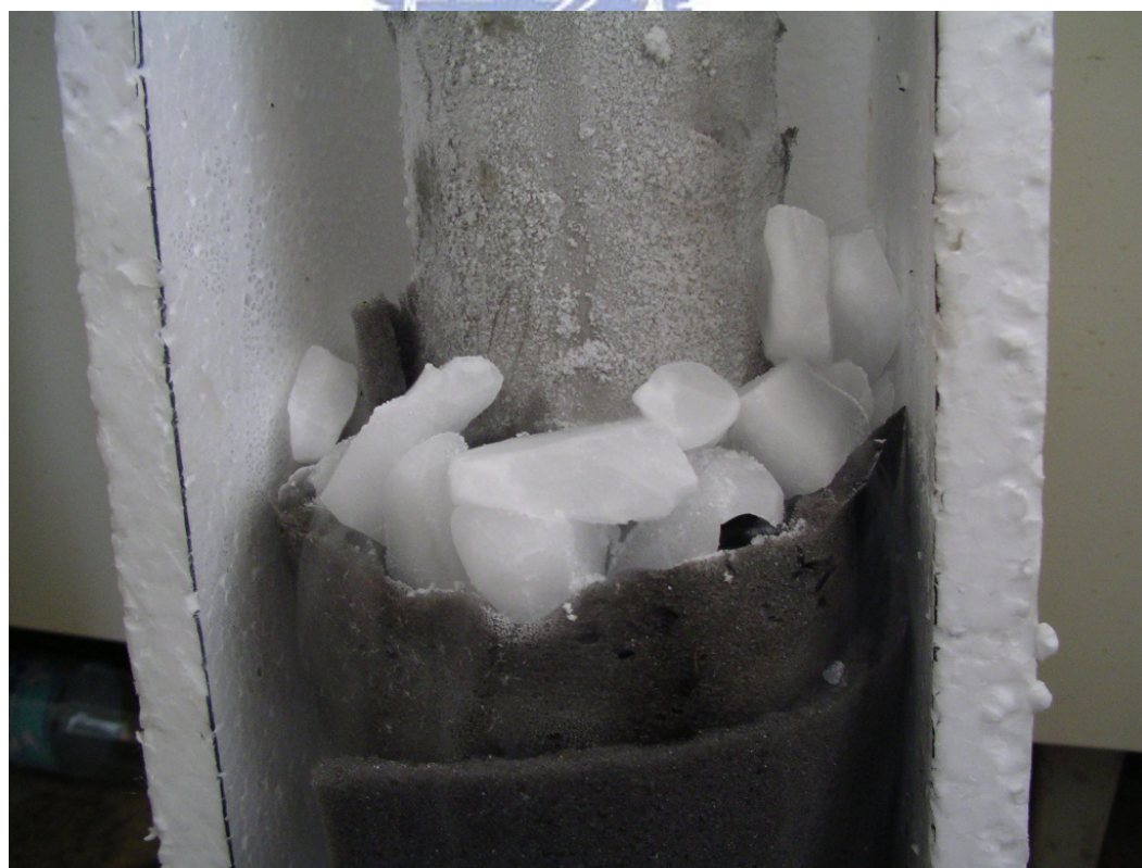
圖 3.4 以乾冰將試管冷凍
