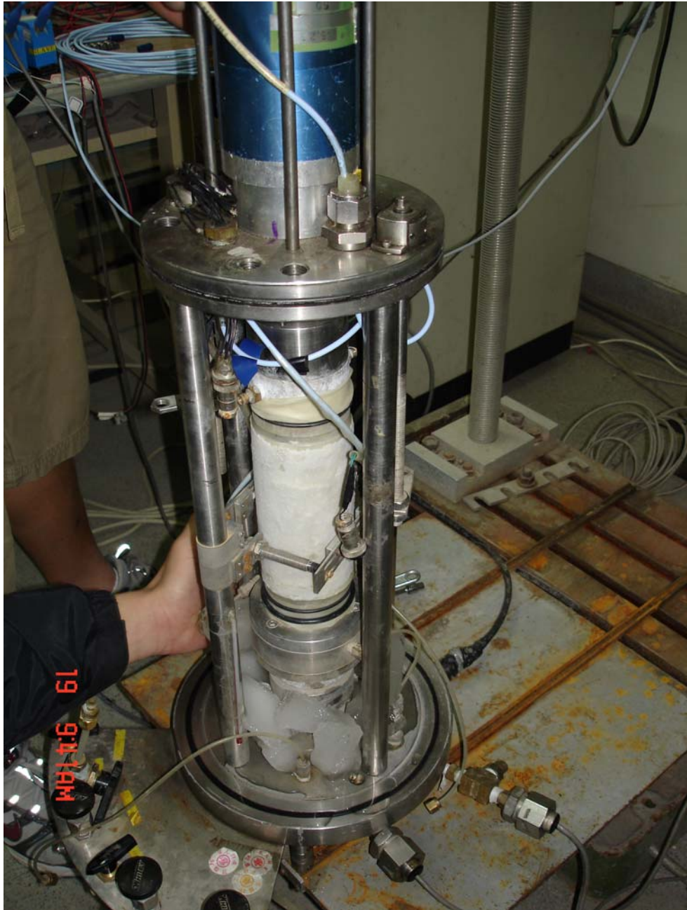
圖 3.15 於三軸室內放置些許冰塊
