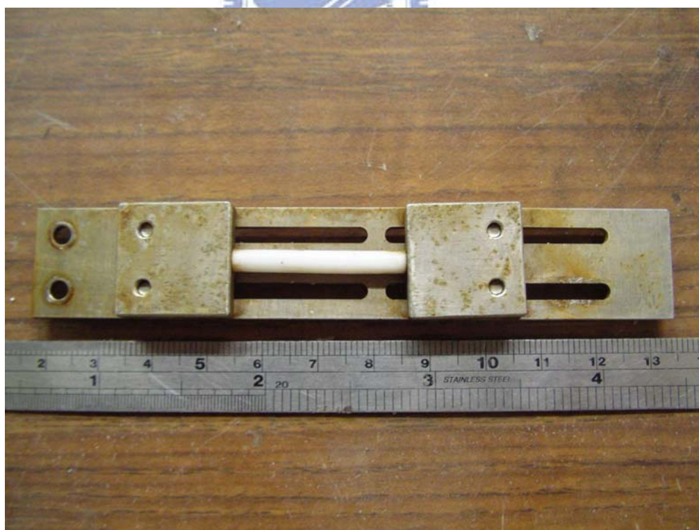
圖 3.13 非接觸式位移計之標的物
