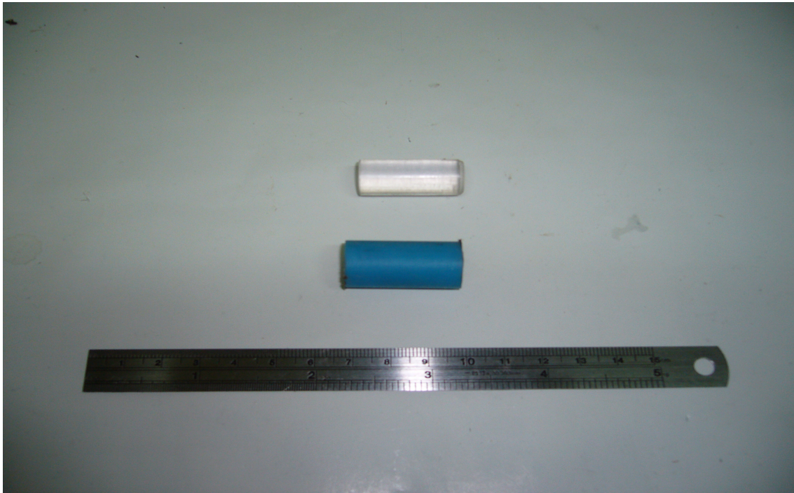
圖 3-13 PC (上方) 與 MC-Nylon (下方) 三公分圓柱實體圖
