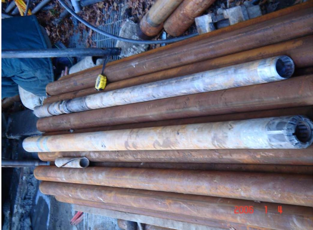
圖 3-5 鑽頭、鑽桿與內部取樣器
