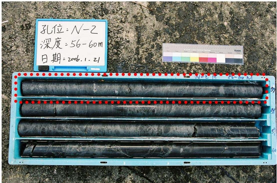
圖 3-10 N-2 孔滑動面材料照片(56~57 米，紅色虛線)
