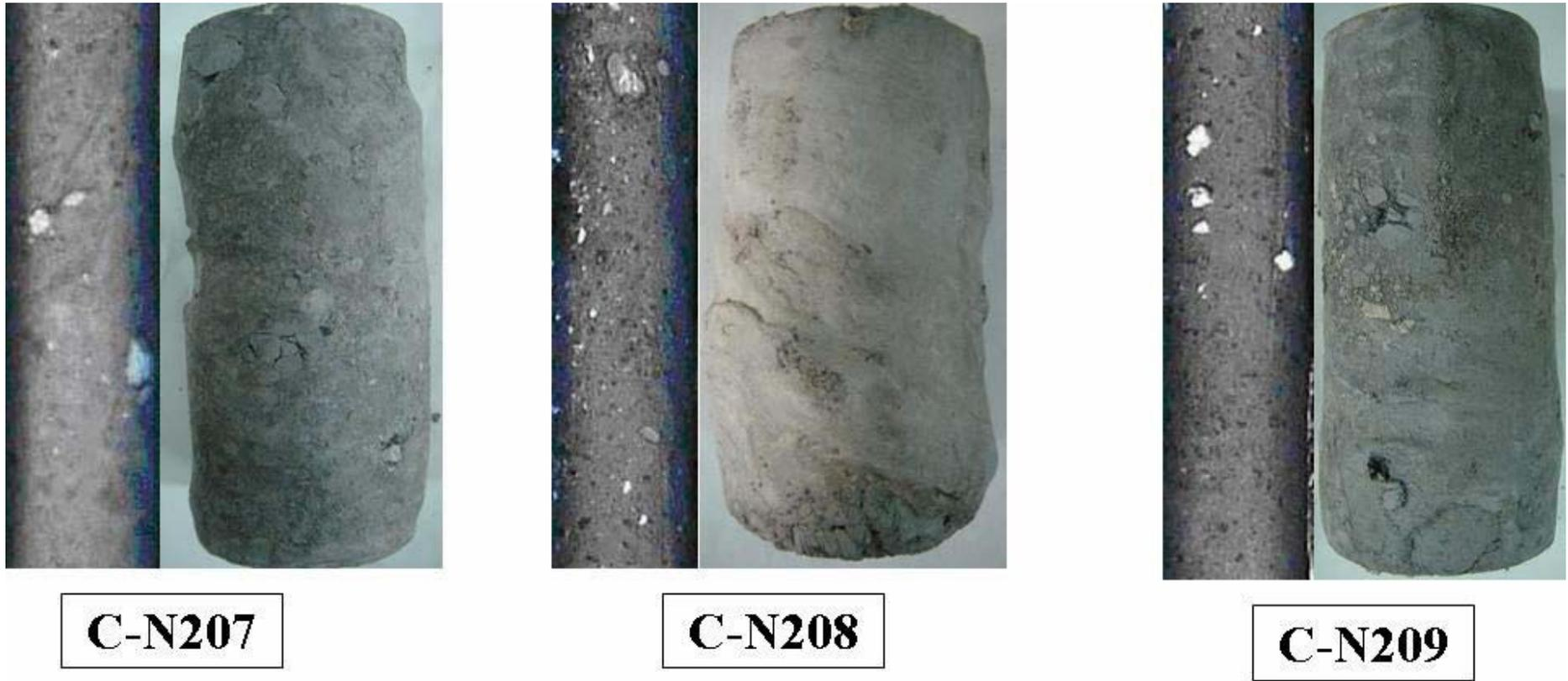
圖 4-27 試體 C-N207、C-N208、C-N209 岩塊排列狀況與試體破壞情形
