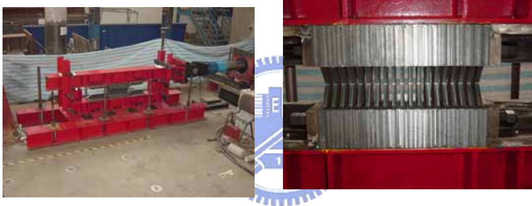
圖 4.5 (b) 原型 USD 制震鈹元件測試之試驗架構
