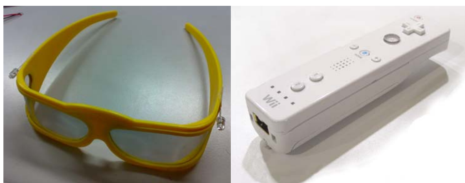
圖 4.35：左/有 IR LED 燈的偏光式立體眼鏡 右/WiiMote 無線操控器
